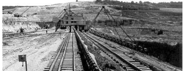
1. fotó: VM-1 vonóvedres kotró rukkolható 1000 mm-es szalaggal (1963)
