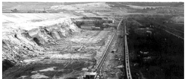
2. fotó: MT-4-es marótárcsás kotró meddőt jöveszt, mögötte kiskotrókkal termelik a szenet (1963)
