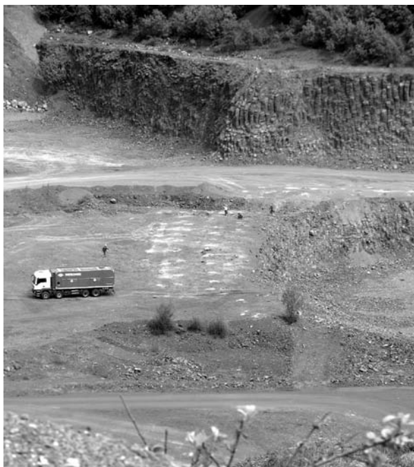
1. kép: Betöltött robbantólyukak a töltőkocsival
