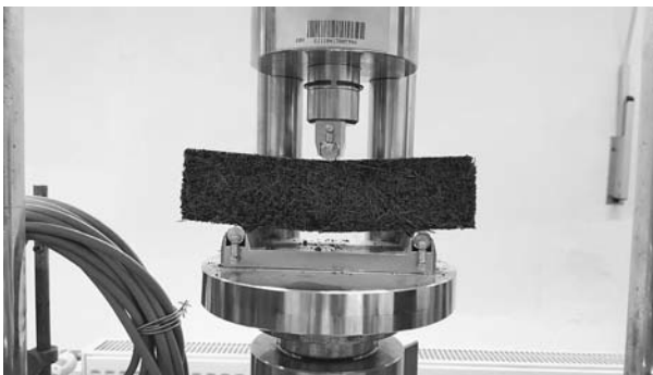
7. ábra: Hajlító próbatetest (pernye/biomassza arány 1/3) a vizsgálat után
