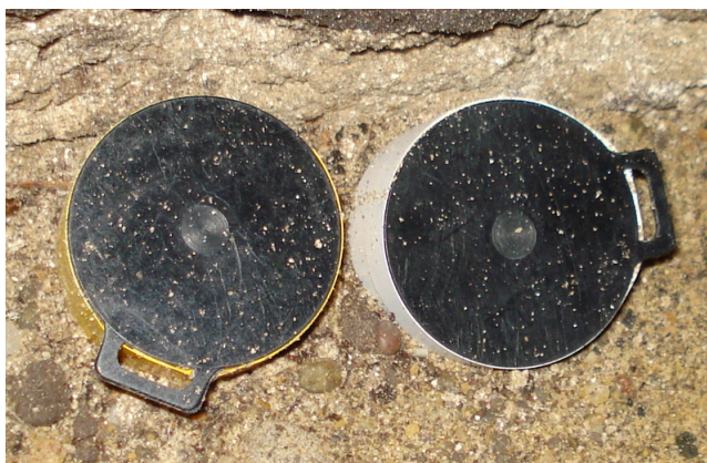
1. ábra. ^{222}\text{Rn} - és ^{220}\text{Rn} - aktivitáskoncentráció mérése talajfelszínre kihelyezett Radamon detektorpárral (tényleges méret)
