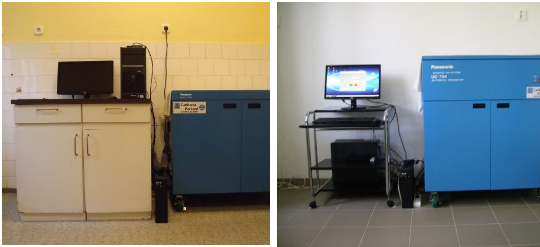
9. ábra: Az UD-7900M2N kiolvasó készülék (balra) és a UD-794D2NCE kalibráló besugárzó készülék (jobbra)
