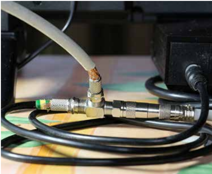
Egy antennaelosztóval kétfelé kell osztani a beérkező jelet (Fotó: Futó)
