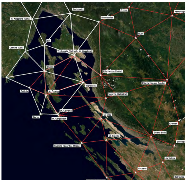
■ Az 1817/18. évi (fehér) és az 1823/25. évi (piros) háromszögelési hálózat a Tengermellék és Dalmácia határán. A későbbi felmérésben a M. Calvario helyett a M. Gargosiachot jelölték meg és onnan, illetve arra mértek, de az eltérést csak később, az ebből származó hibával terhelt Zára megyei kataszteri térképsorozat elkészülte után vették észre
