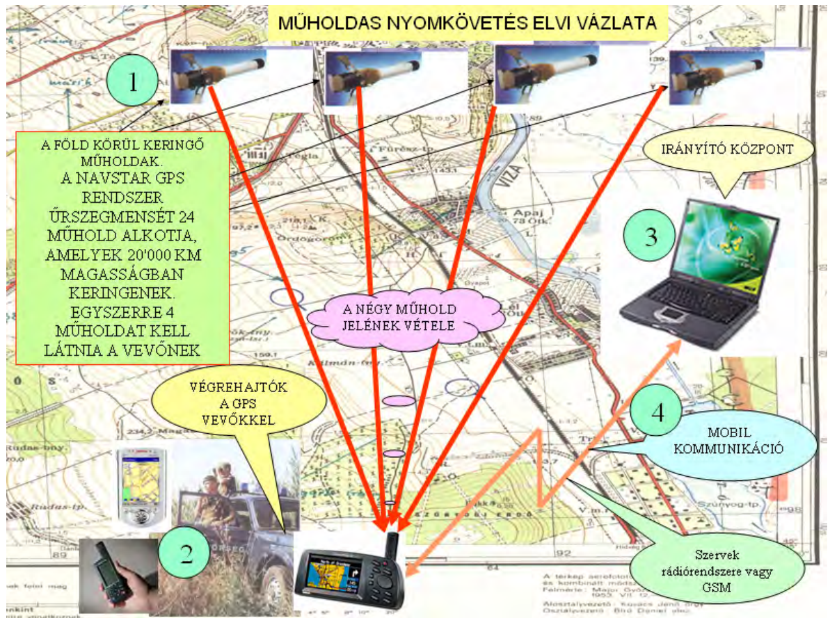
A GPS nyomkövetés működése
