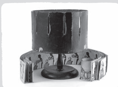
A „csodadob” (zootróp) egy függőleges nyílásokkal ellátott, forgatható henger, belsejében a mozgás egymást követő mozzanatait ábrázoló, cserélhető papírcsíkkal
