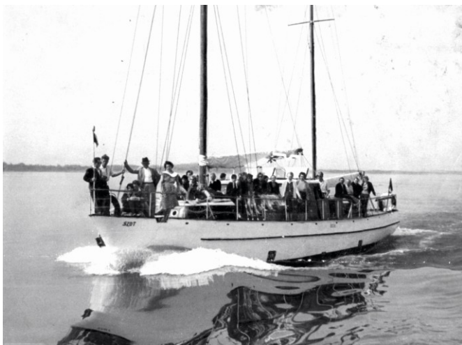
Az ŐSZÖD kétárbocos, 75 m 2 vitorlafelületű, 45 személyes, motoros vitorlás 1962-ben. Forrás: Németh Ilona (Balatonfüred).
