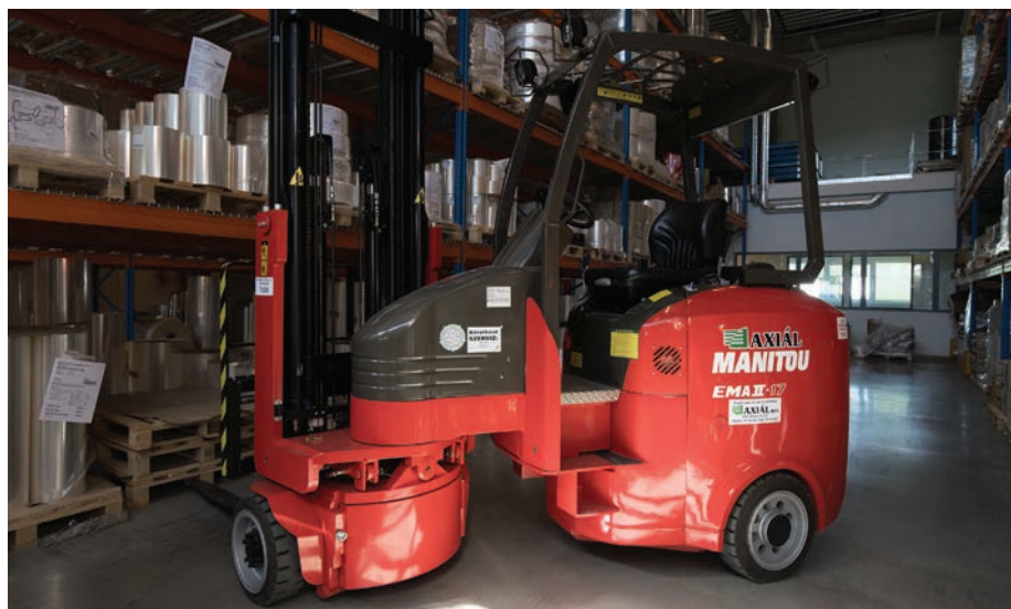
Az emelőgépeknél nem megszokott csuklós kivitelű Manitou EMA II 17
