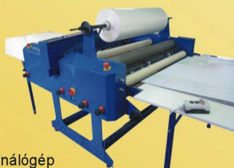
Laminálógép szivacs+öntapadó film
