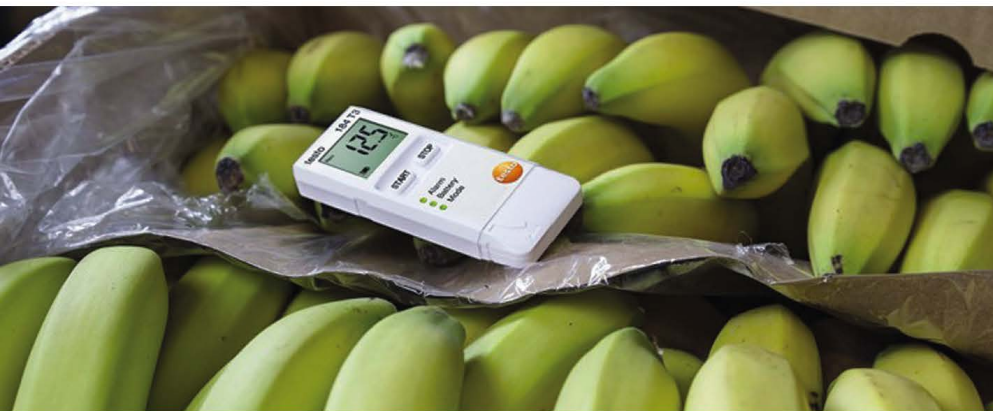
2. Hőmérséklet-adatgyűjtő alkalmazása hűtött gyümölcsszállítás esetén. Forrás: www.testo.hu, Letöltés ideje: 2015.08.04
