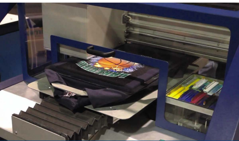
1. A Kornit Digital inkjet berendezéseivel közvetlenül textilanyagokra lehet nyomtatni
