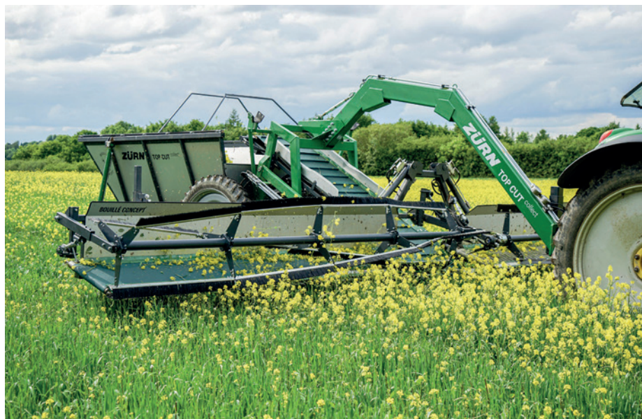
Spirál vonalú terelőlapátokkal szerelt motolla továbbítja a levágott gyomnövényrészeket a szalagra (fotó: zuern.de)
