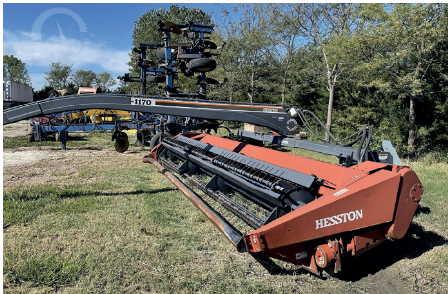
4. kép. Központi vonórudas vontatott alternáló kasza-konstrukció
