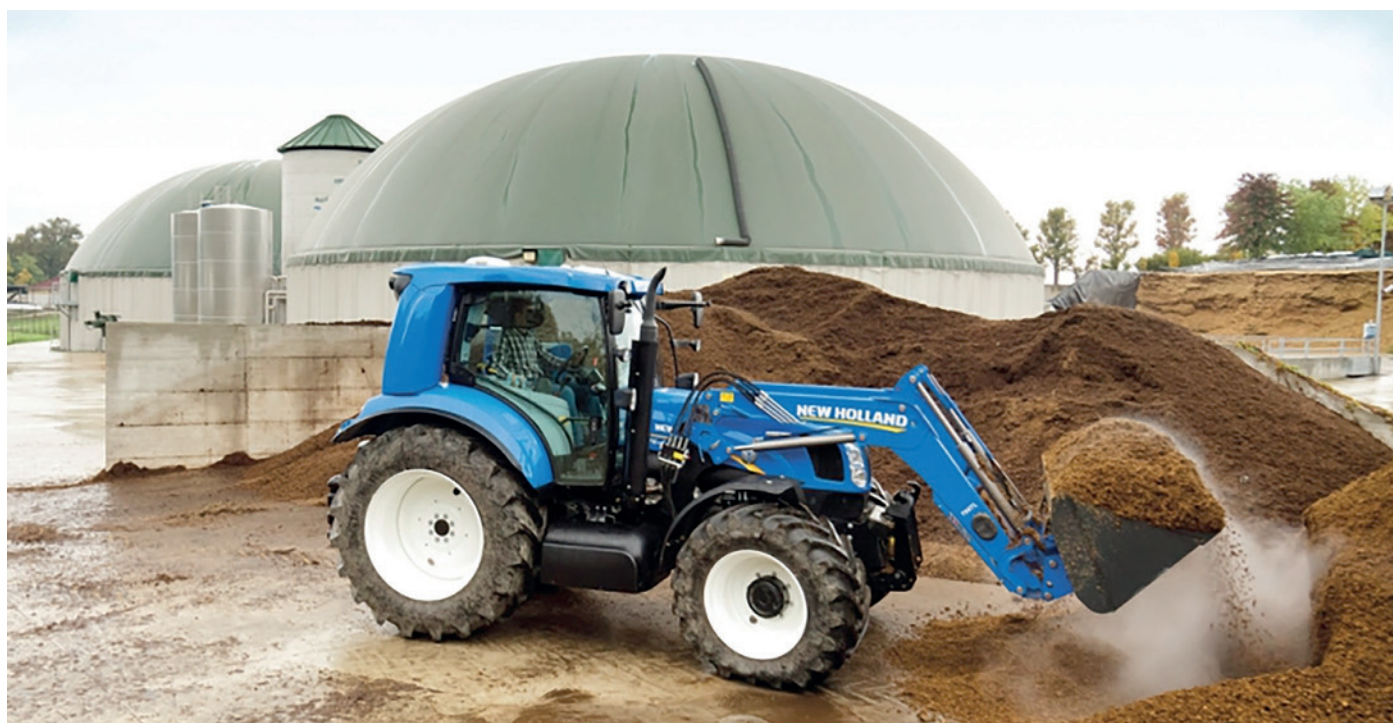
1. kép. A La Bellotta gazdaság New Holland T6.140 Methane Power traktorral (forrás: agriculture.newholland.com)
