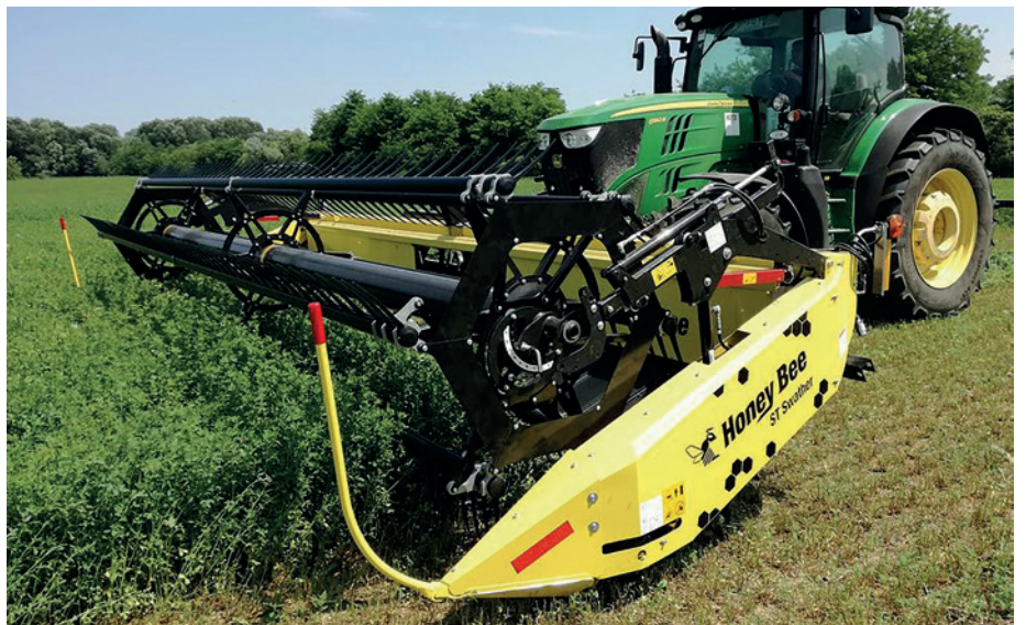
9. kép. A rendre vágók motollamozgató mechanizmusa
