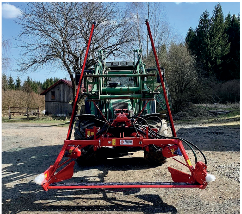
3. kép. Mellő és oldalsó függesztésű gépkombináció tartószerkezete
