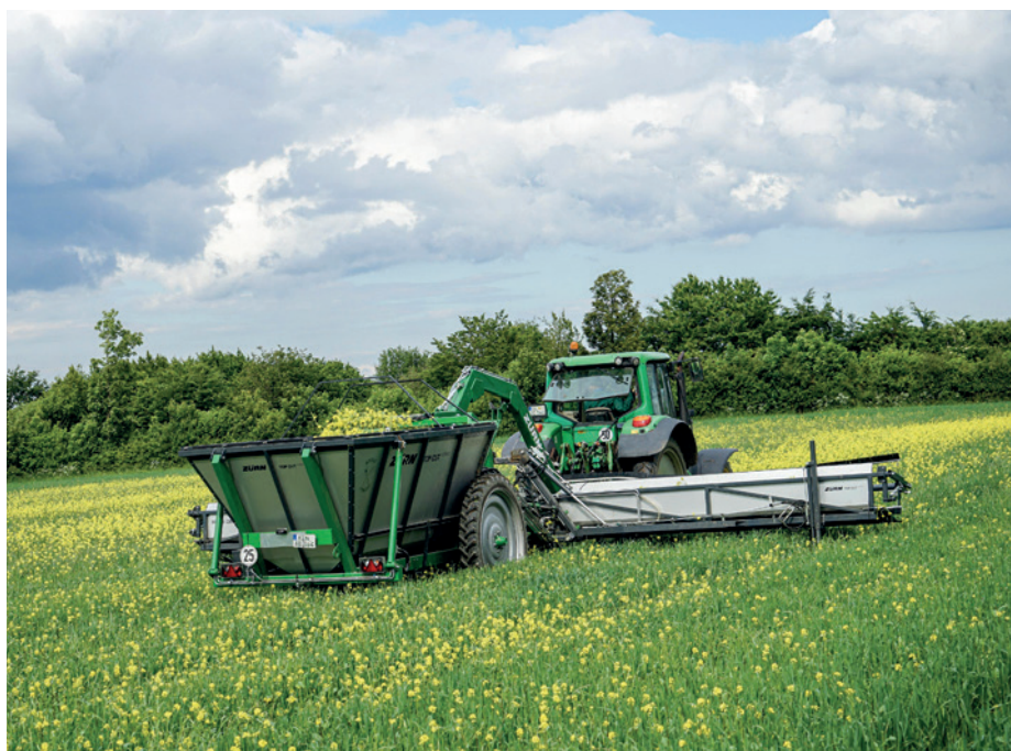
A Top Cut Collect gyűjtőtartálya 7000 literes (fotó: zuern.de)
