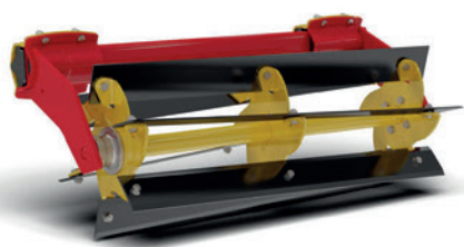
Extra aprítóhatás a CrossCutter Knife melső művelőelem segítségével
