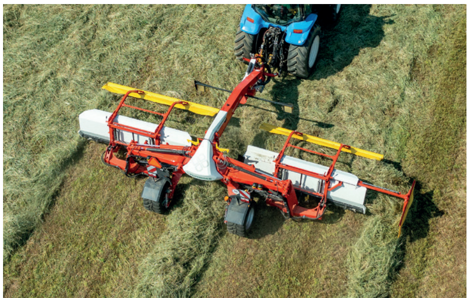
A hevederes rendképzők a középre hordó, rotoros versenytársakhoz képest több rendképzési variációt kínálnak (fotó: poettinger.at)
