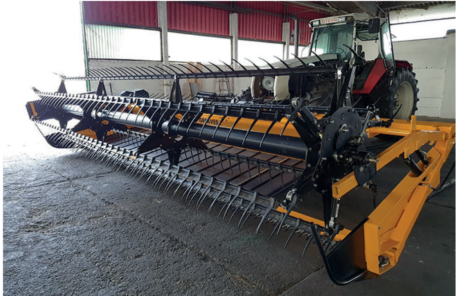
8. kép. Hevederes vágóasztal mellső függesztőszerkezetű traktoron
