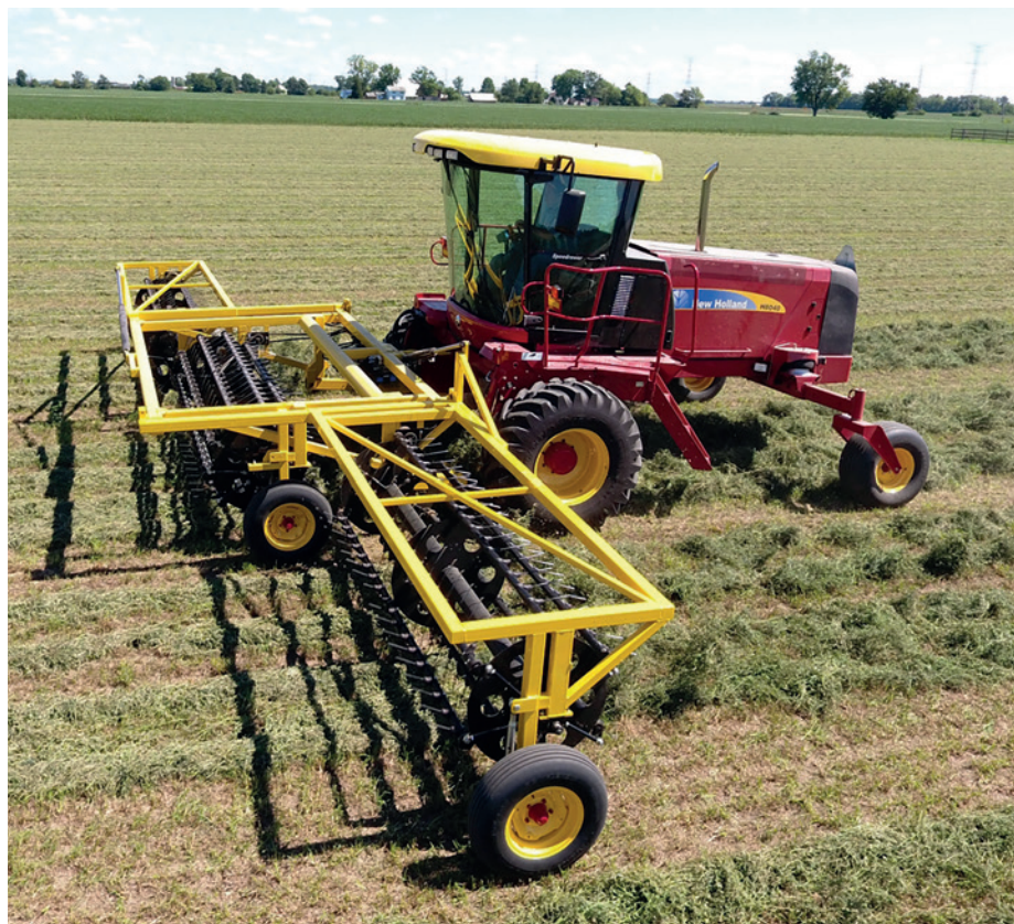
Az önjáró rendrevágó adapterének helyére kapcsolható a John Russel rendszellőztetője (fotó: jdrussellhay.com)
