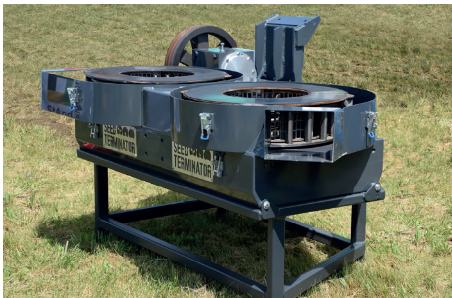
A Seed Terminatorban a magok megsemmisítését két nagy teljesítményű, többlépcsős, aerodinamikus, wolfram-karbidval bevont kalapácsmaró végzi el (fotó: zuern.de)
