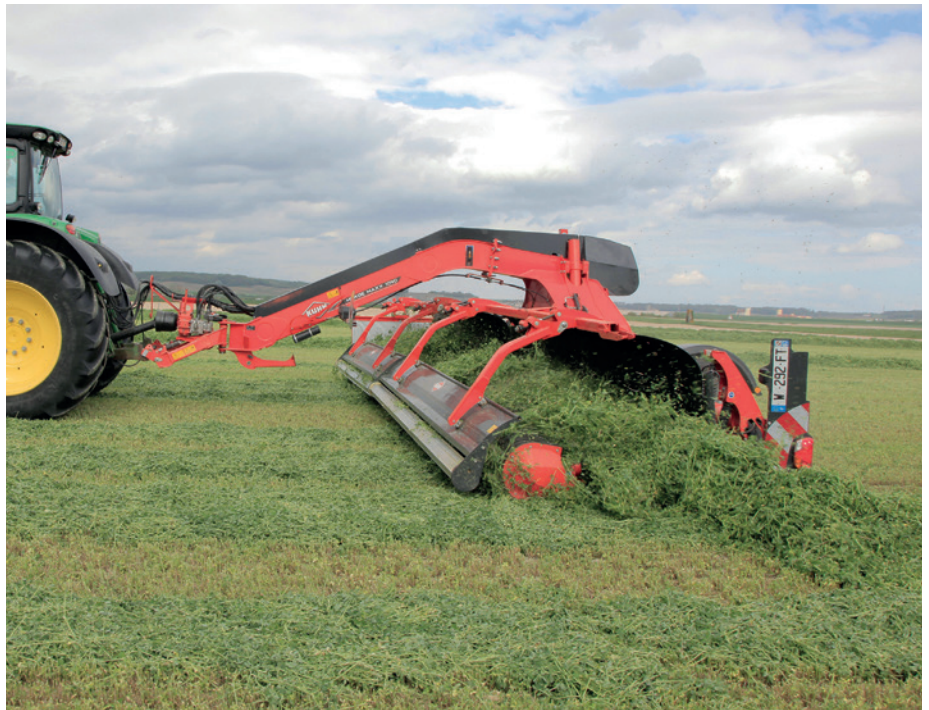
Hevederes rendképző használatával a termény felemelkedik, és finoman kerül a szalagra (fotó: media-library-uk.kuhn.com)
