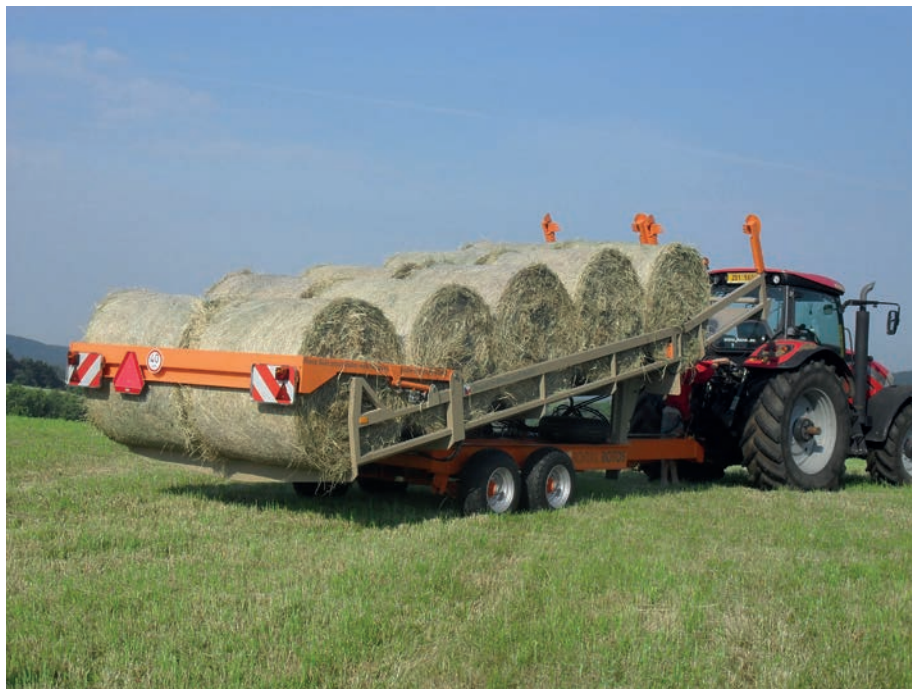
A Romill Rotos cseh gyűjtőkocsi egyszerre 10 bálát képes egybegyűjteni mindössze három perc alatt (fotó: romill-ag.cz)
