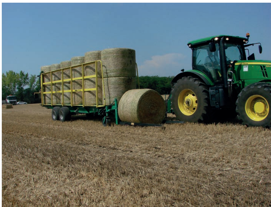
Az olasz Alberti AM széria, amely egyszerre két hengeres bálát gyűjt össze bálaemelő villájára
