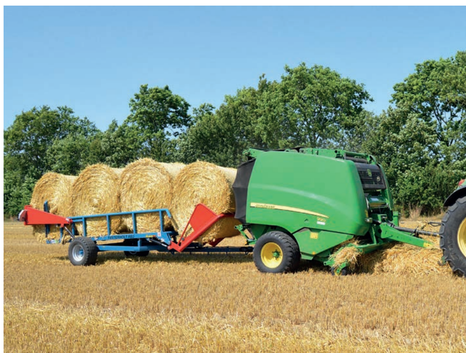
Fasterholt RB3 bálázó után kapcsolható bálagyűjtő kocsija (fotó: fasterholt.dk)
