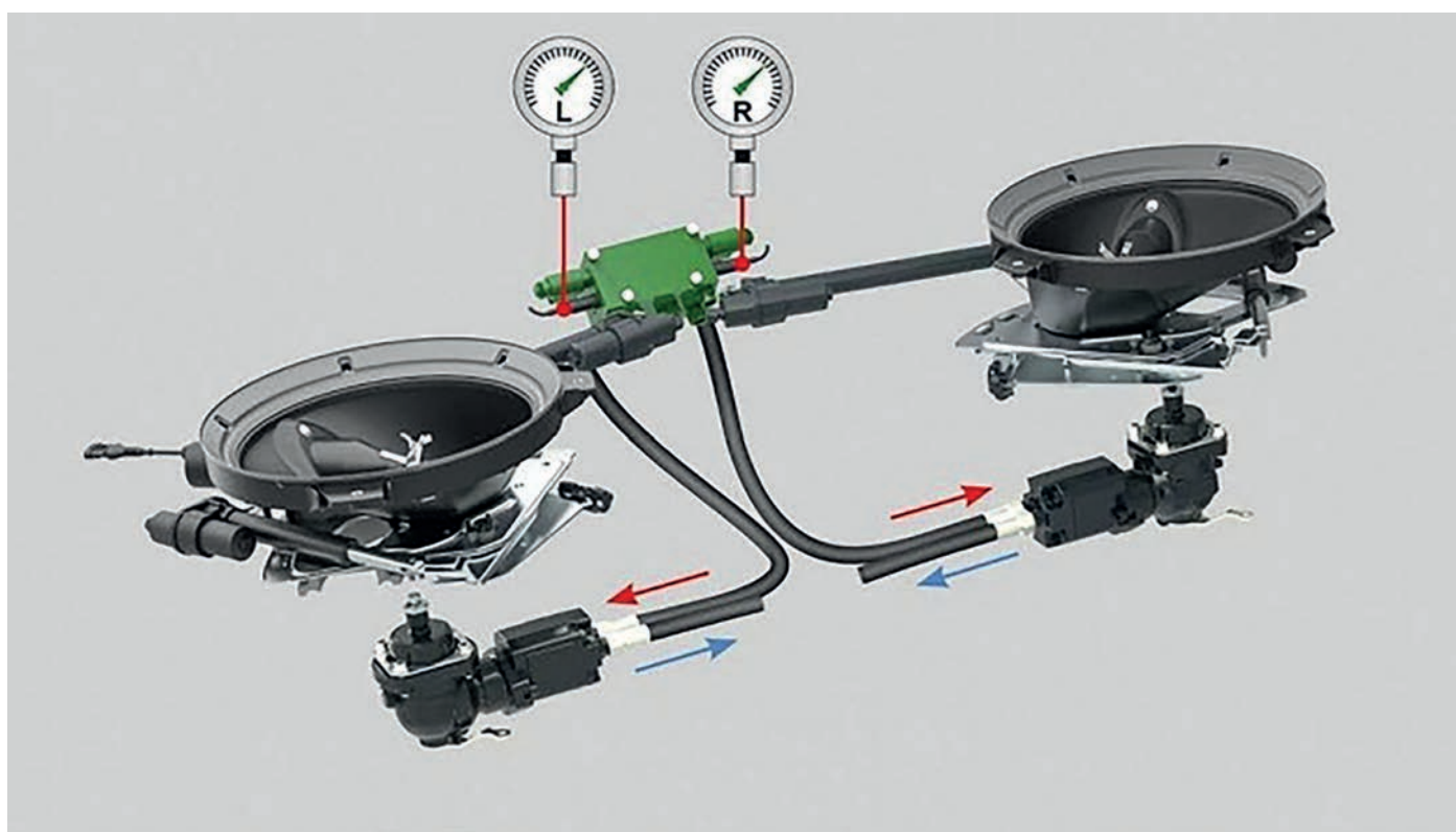
2. ábra. Szórótárcsák hidraulikus megoldásai
