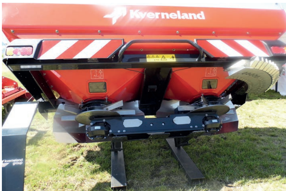
4. kép. A műtrágyaszóró gépek korrózióálló anyagból készült szórótárcsái a lapátokkal
