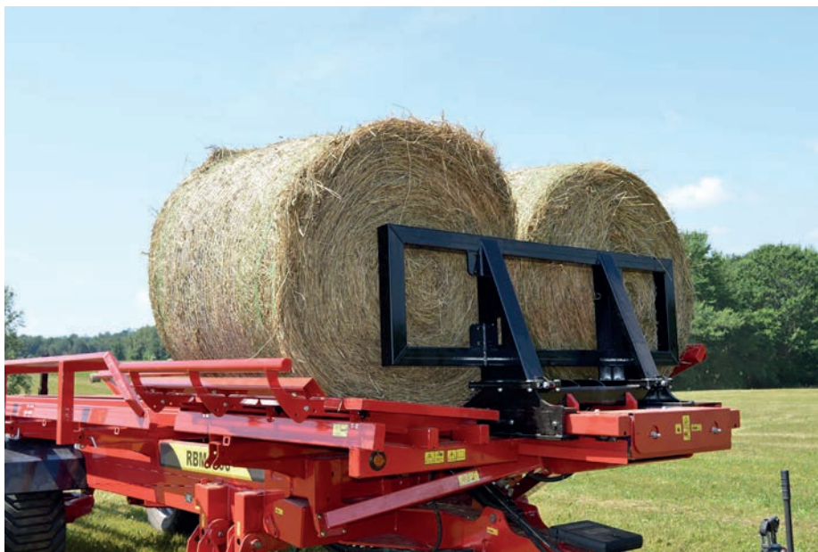
A felszedett bálákat hidraulikus mozgatású tolófal tereli hátrafelé a kocsí gyűjtőfelületén (fotó: grpanderson.com)
