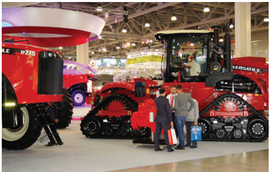
A Delta Track kiegyenlített felfekvésű, talajkövető kettős BOGIE hevederes futóművének köszönhetően nem lép fel görgő- és hevederkerék túlterhelés
