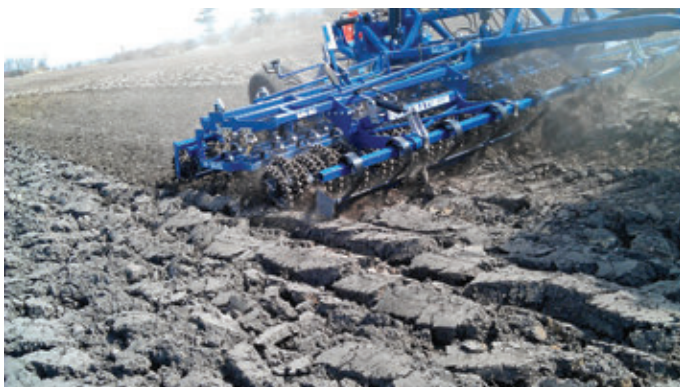
A Dal-Bo RolloMaximum henger szántásból 1 menetben magágyat készít
