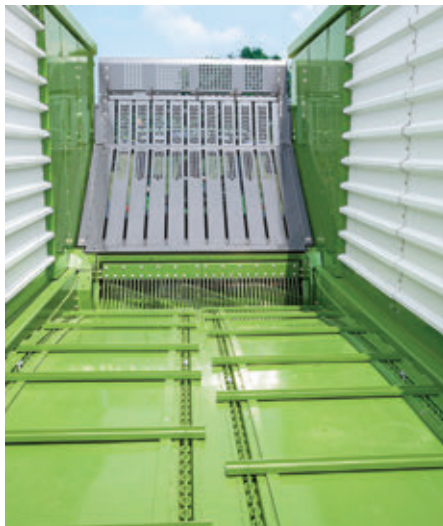
Ürítéskor a homlokfal hátra dől, így segítve a kiürítést, és kitolva a terményt
