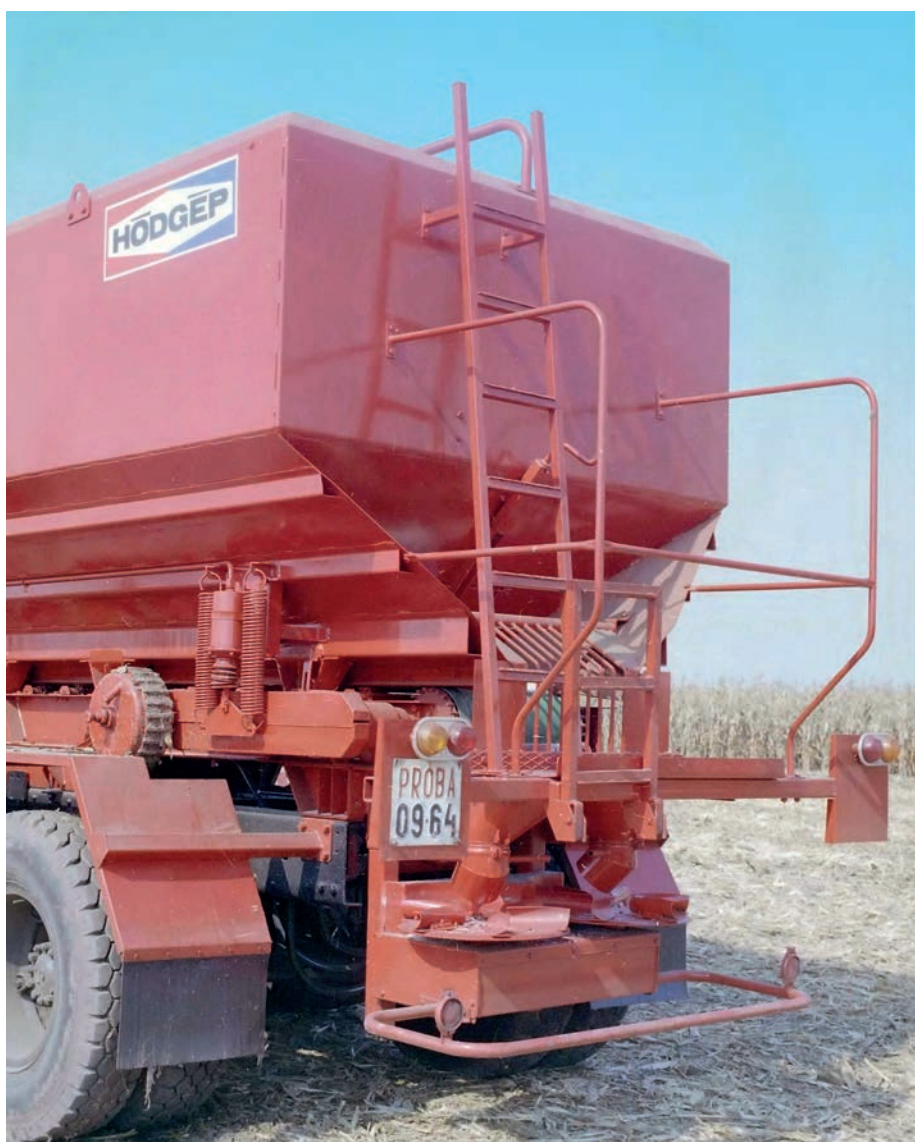
A Bóra 8 műtrágyaszóró felépítmény szórószerkezete
