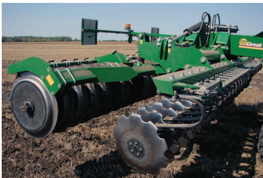
4. kép. Csipkés tárcsalevél és a szögállást állító mechanizmus
