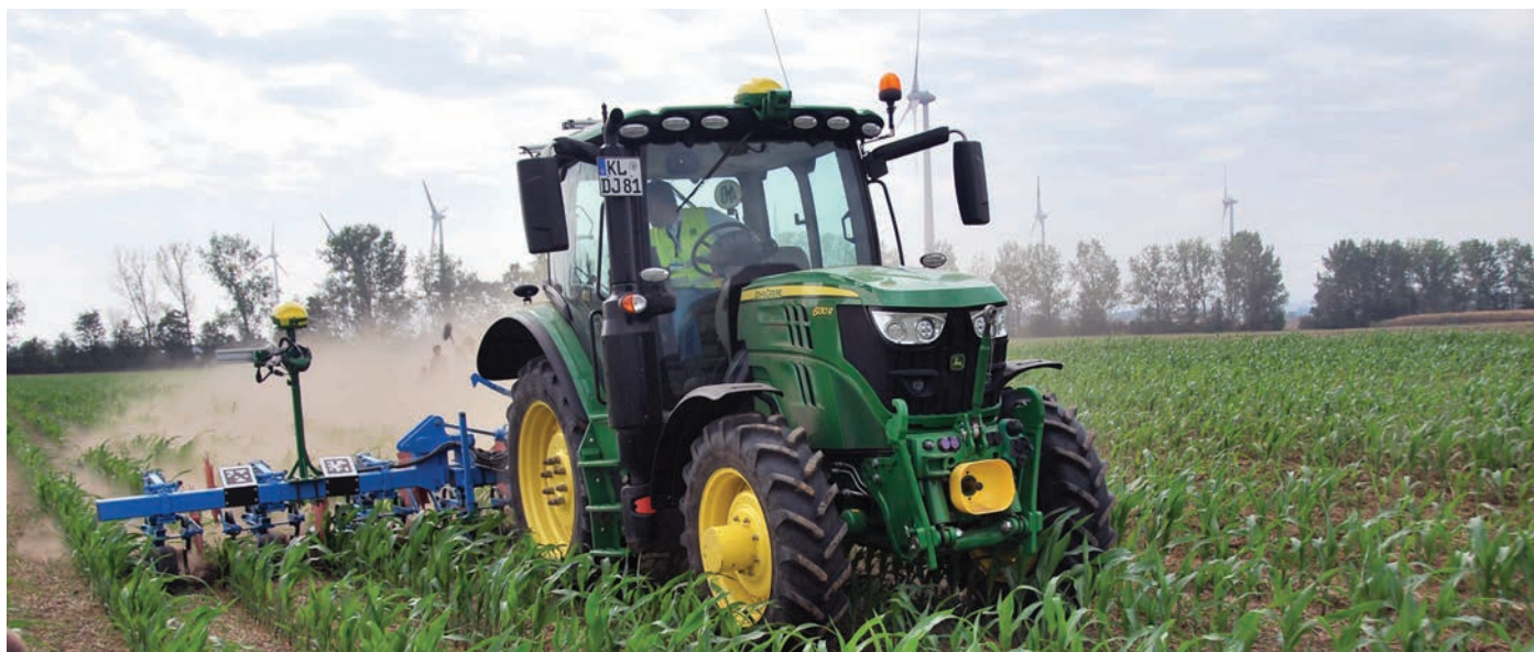
A következő szántóföldi menetek a ténylegesen dokumentált sorhelyzet alapján végzik, nem pedig egy statikus AB-vonal alapján
