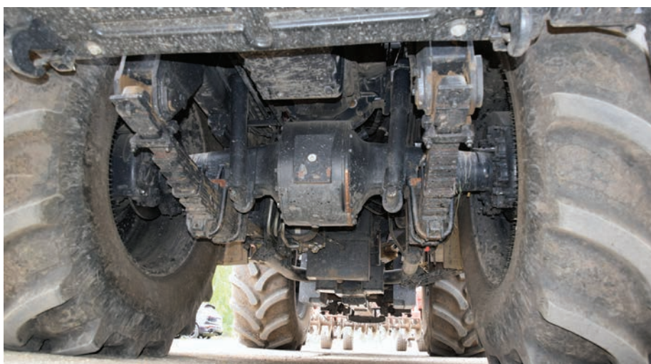
Nem szívárog sehol az olaj, minden tömítés, illetve rögzítés kiválóan látja el a feladatát
