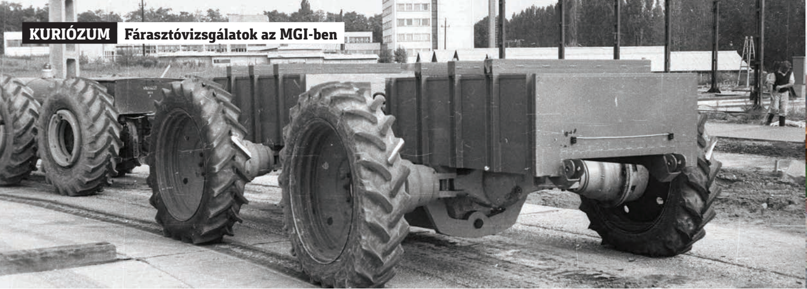
3. kép. D4K-B alváz, villanymotoros traktorral végzett gumiabroncs-fárasztás
