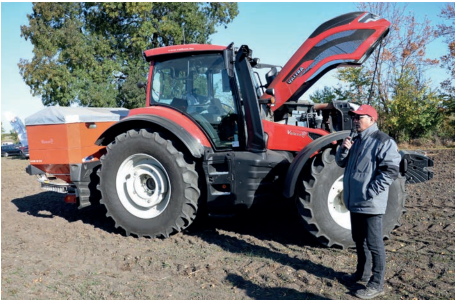
A bemutatott RAUCH AXIS műtrágyaszóró 2900 literes tartálytérfogató, mechanikus meghajtású, ISOBUS-os fedélzeti elektronikával felszerelt
