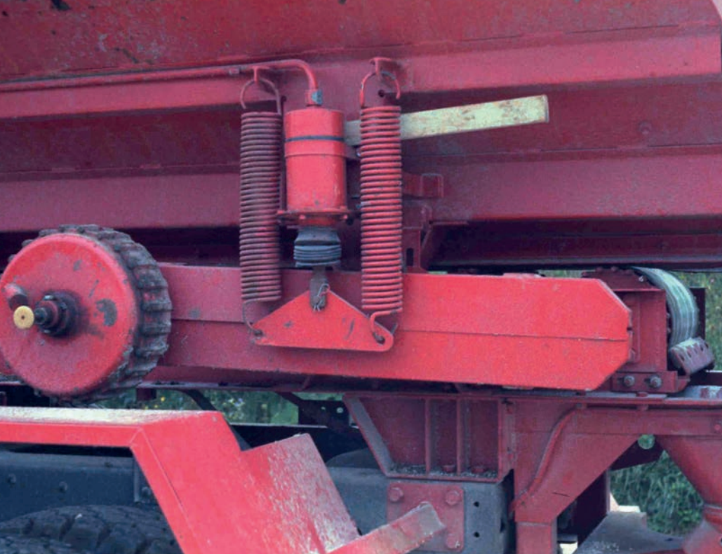
A lehordószerkezet hajtóműve a dörzskerékkel
