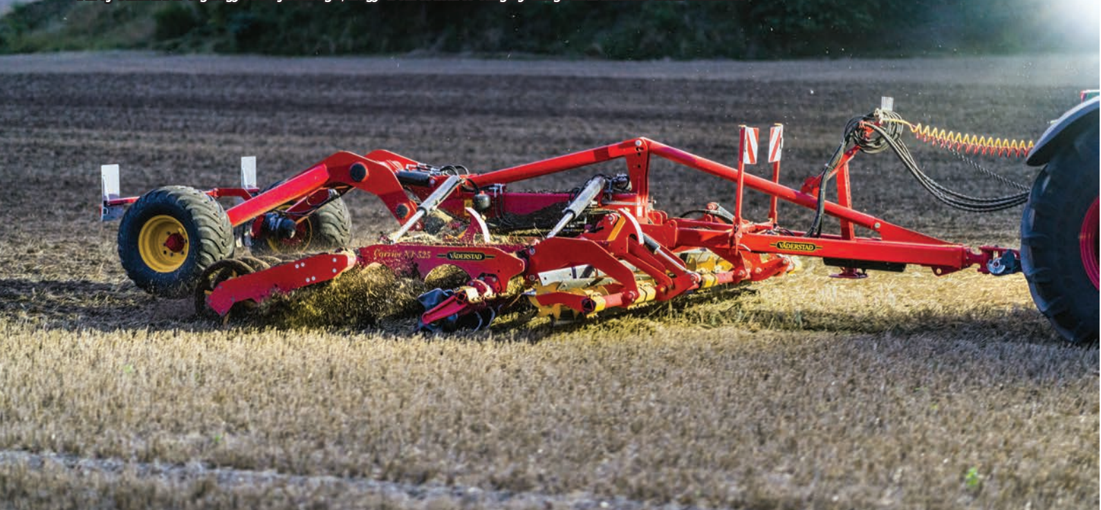
Az új Carrier XT legnagyobb újdonsága, hogy a tárcsatarató tengely szöge hidraulikus úton állítható
