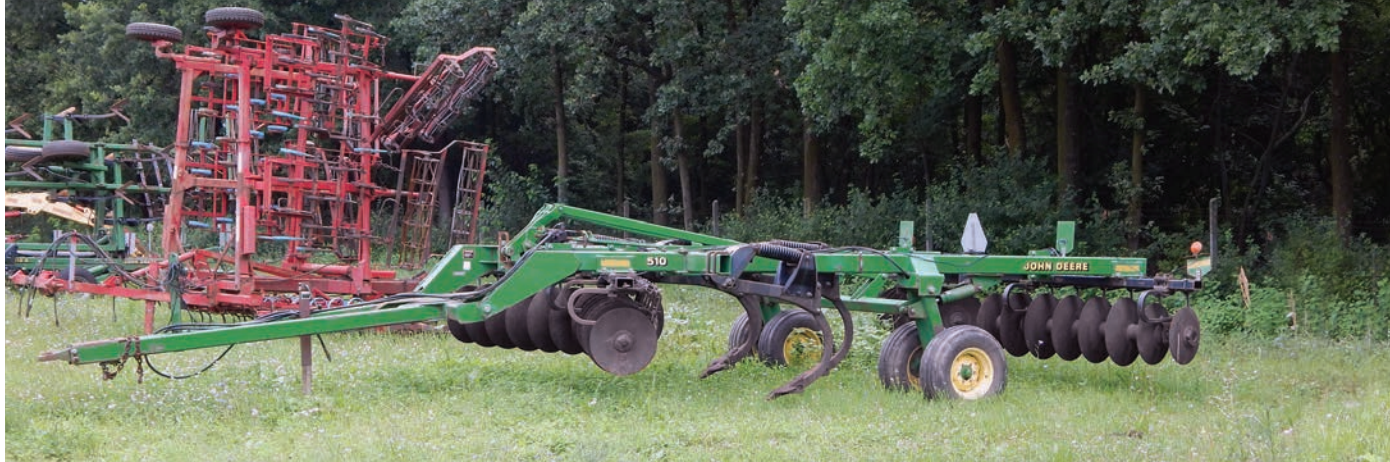
3. kép. Vontatott gép „X” tárcsa elrendezéssel
