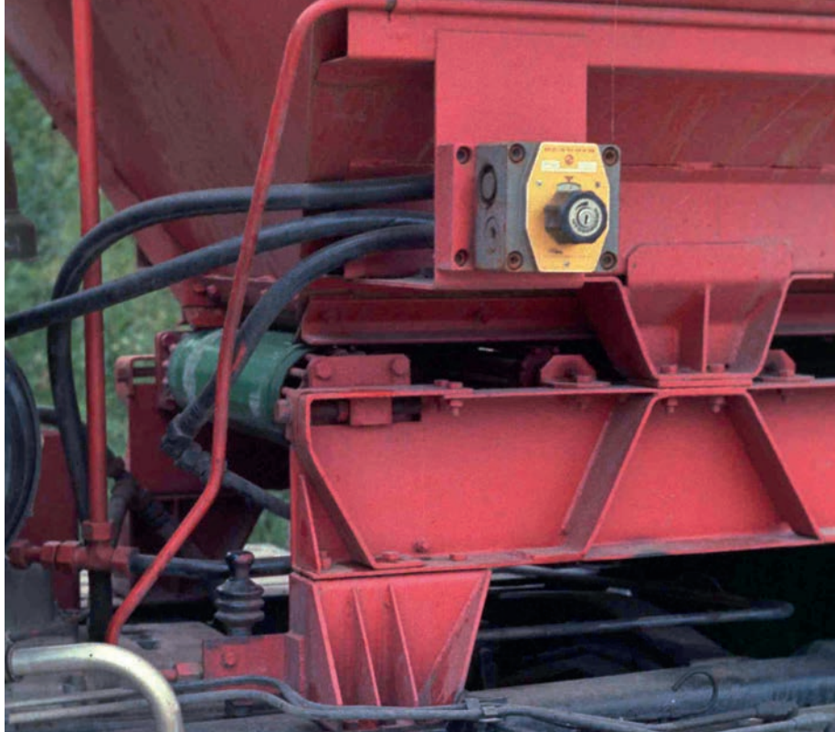
A röpitőtárcsa hidrosztatikus hajtásának Rexroth áramlásszabályzója
