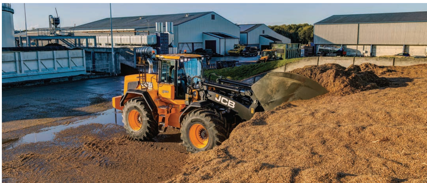
Az S verzióban megújult a hátsó váz és az ellensúly, új a hajtómű, a hidak, a kerekek és az abroncsok, így a modell kiválóan helytáll az erőigényes szabadtéri feladatoknál
