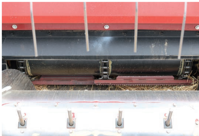
A ferde felhordóban egy hagyományos láncos keresztlécés felhordószerkezet található – ami kevésbé tekeri fel a terményt, mint az elődjében a dobok
