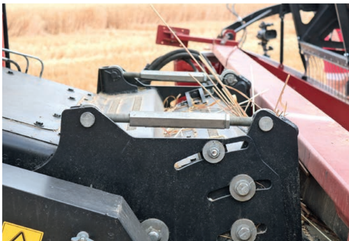
A dőlésszög most már állítható – sajnos csak manuálisan és nem hidraulikusan, állítóorsók segítségével
