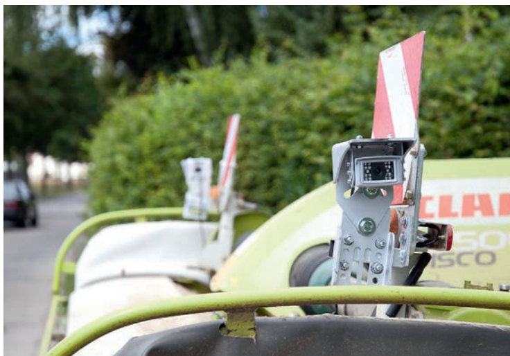
DLG-tanúsítvánnyal és műszaki vizsgánál bejegyzett engedéllyel rendelkező Fliegl Hawk rendszer elülső kamera-monitor rendszerként egy frontkaszáz
