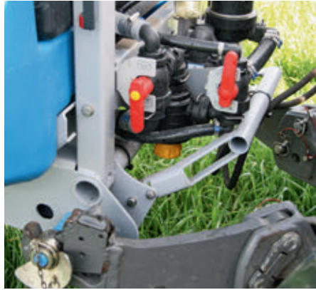
A QuickConnect csatlakozórendszernek köszönhetően minden összekapcsolható anélkül, hogy a munkagép és a traktor közlellene préselődni
