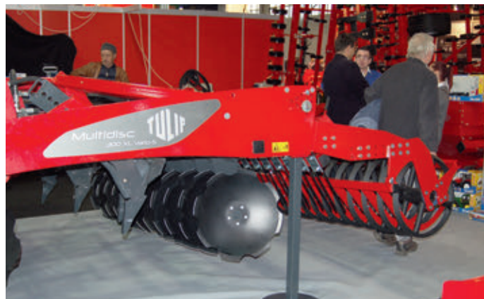
A Multidisc Vario, aminek lényege, hogy a tárcsás és a kapás talajművelő egységet egy munkaeszközzé kapcsolja
