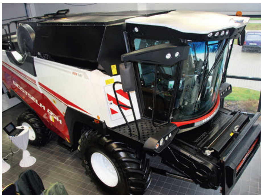
Az RSM 161 erőforrása egy alacsony üzemanyag-felhasználású, 380 lóerős, hathengeres Cummins QSL 9 motor
