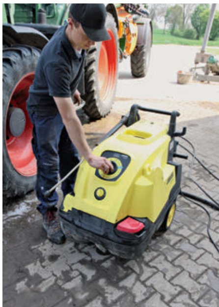
Egy kézzel működtethető a bekapcsolás és a hőmérséklet; a tisztítószer hozzákeverése alul történik
