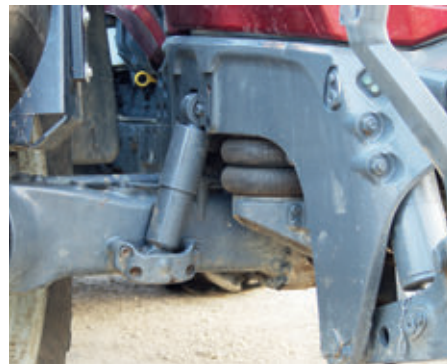
A T234 Versu fülkéjének komfortját nagymértékben fokozza a rugózott első híd
