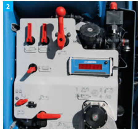
1 A Sirius vezérlőközpontja: a felhasználó itt találhat meg mindent, ami a permetezőgép megtöltéséhez szükséges. A felület egyértelműen tagolt, és jól feliratozott. Az oldalsó fedél kinyitására a vegyszer-bekeverő is szabaddá válik.
