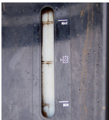
A traktor váltómű- és a hidraulika-rendszerének olajszint ellenőrzése sokkal egyszerűbb lett: nivópálca helyett egy átlátszó üvegen keresztül ellenőrizhetjük a szintet
