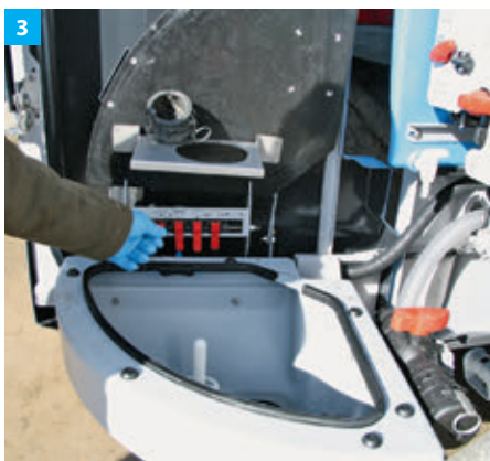
1 A Sirius vezérlőközpontja: a felhasználó itt találhat meg mindent, ami a permetezőgép megtöltéséhez szükséges. A felület egyértelműen tagolt, és jól feliratozott. Az oldalsó fedél kinyitására a vegyszer-bekeverő is szabaddá válik.
