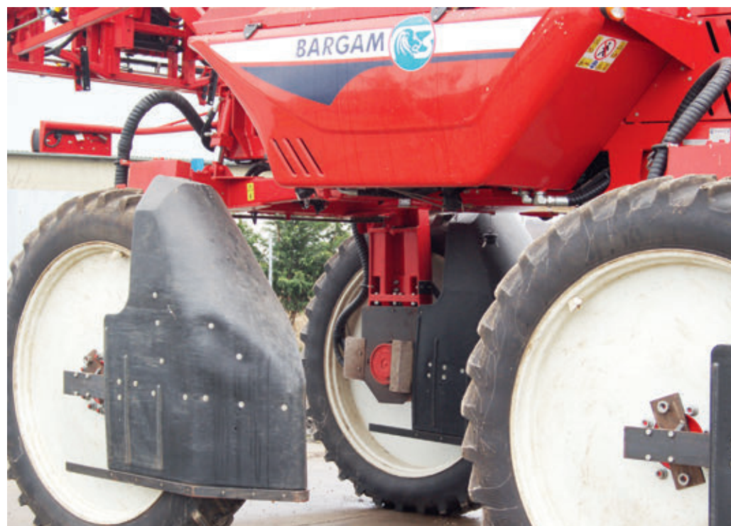
A gép járószerkezete az első és hátsó tengelyen egyaránt hidropneumatikus rugózású
