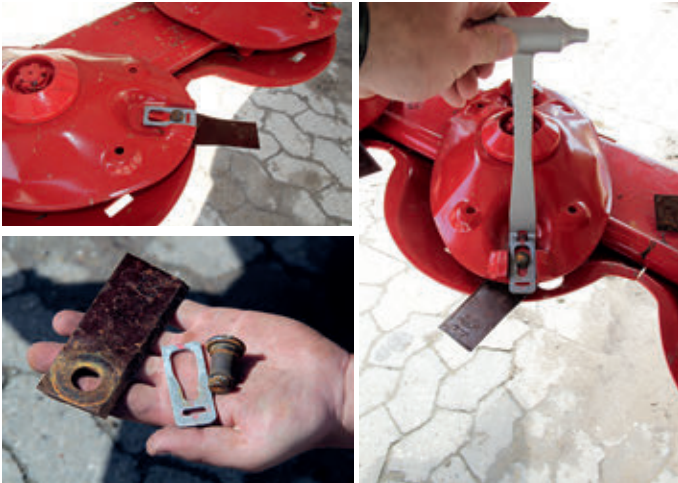
A késpengéket egy fémlap rögzíti (fent balra). A kivételükhöz kell egy szerzőszám, amivel a fémlap kihúzható és a tartó kiüthető (jobbra)
