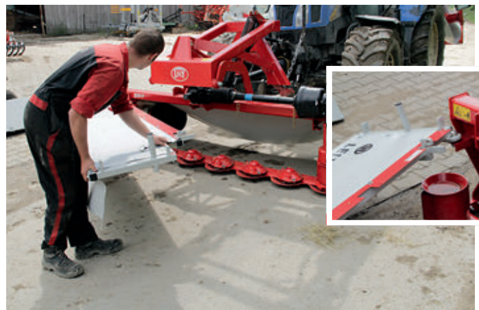
A karbantartási és tisztítási munkákhoz a frontkasza védőburkolatát egyszerűen oldalra kell fordítani
