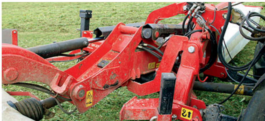
Ha a kaszagerendely akadályba ütközik (jobbra), akkor hátrafelé kifordul, és a függesztés vezérlésén keresztül megtörténik a kiemelés is (balra). Ezután magától visszaáll munkavégző helyzetbe
