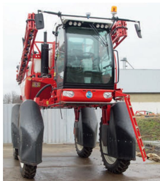
A BARGAM GRIMAC vonulási szélessége 2 250 és 3 000 mm között mechanikusan állítható
