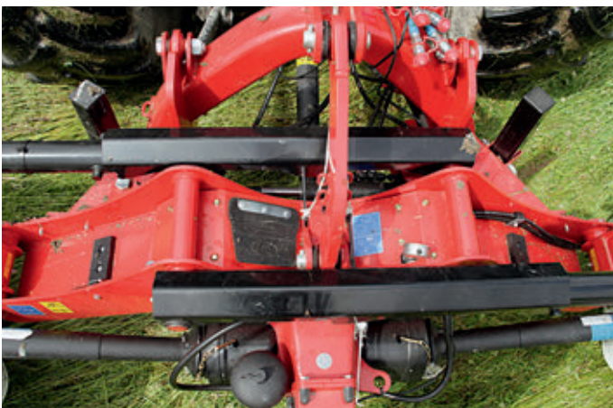
A teljes kaszaegység három karral van rögzítve a függesztőbakon. Mindkét oldal külön kiemelhető
