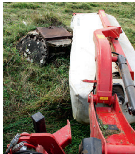
Ha a kaszagerendely akadályba ütközik (jobbra), akkor hátrafelé kifordul, és a függesztés vezérlésén keresztül megtörténik a kiemelés is (balra). Ezután magától visszaáll munkavégző helyzetbe
