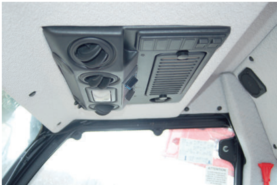
A permetezőgép panoráma vezetőfülkéje légkondicionált, aktív szénes vegyszerszűrővel ellátott
