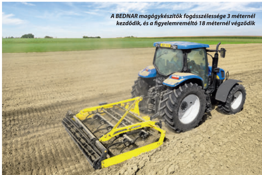
A SWIFTER kombinátorok ideális magágyat készítenek az összes szántóföldi növény számára. A precíz magágy rendkívül fontos előfeltétele a homogén növényállomány létrehozásának
