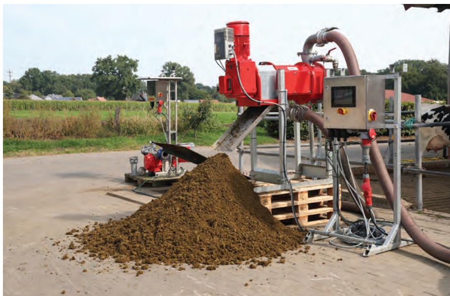
A nagy teljesítményű XSplit szeparátor, amelynek kialakítása és karbantartása eltér a piacon lévő többi szeparátorétól (fotó: vogelsang.info)
