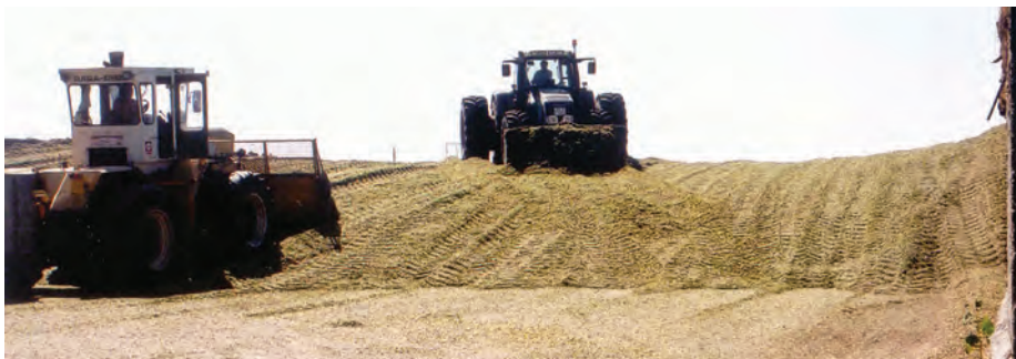
2. kép. Silókazal tömörítése nehéz, univerzális traktorral
