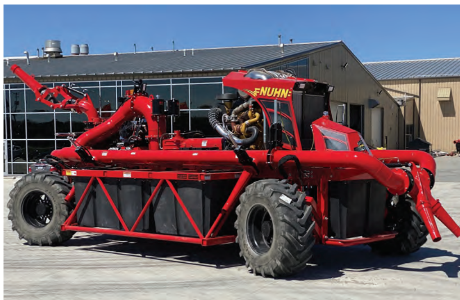
NUHN Lagoon Crawler önjáró, kételtű hígtrágyakeverő (fotó: nuhn.ca)
