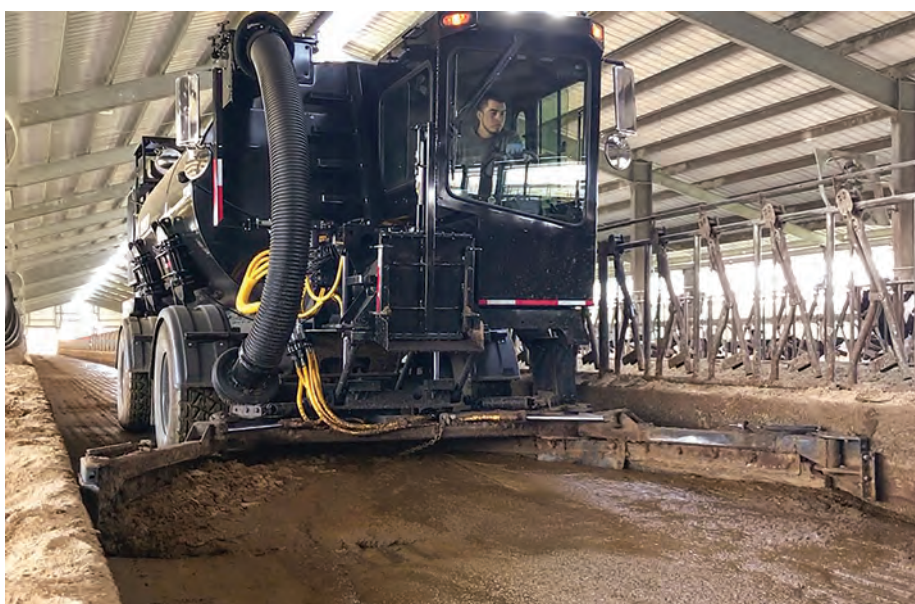
Az önjáró hígtrágyagyűjtő trágyaterelő gumiszárnyai (fotó: menschmfg.com)
