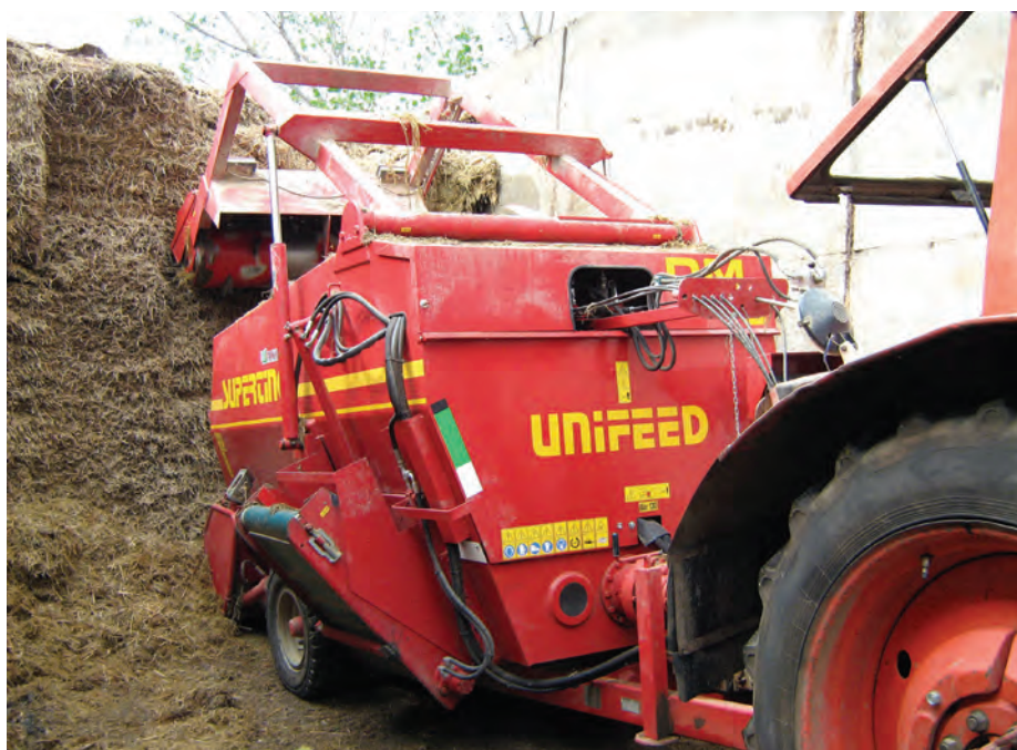
7. kép. Vízszintes csigás gép feltöltése saját silómaróval
