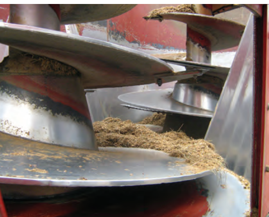
6. kép. Függőleges keverőcsiga beépítése
