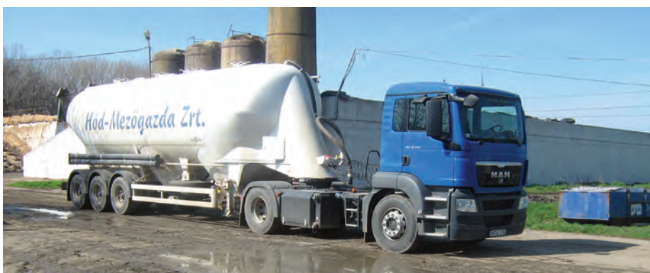
3. kép. Előtároló silók feltöltése tartálykocsiból
