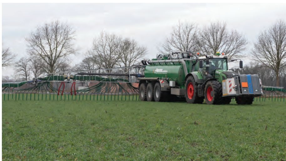
SyreN kénsavadagoló rendszer (fotó: biocover.dk)
