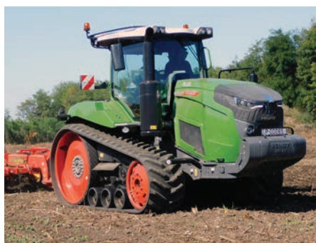
6. kép. Magágykészítésben a gumihevederes járószerkezetű traktorok használatával csökkenthető a fajlagos talajterhelés, vagyis a káros talajtömörítés
