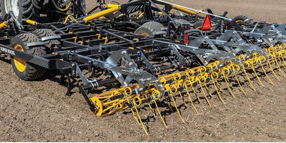
8. kép. Lezáróhengerrel, rugós fogú boronával szerelt magágykészítő gép
