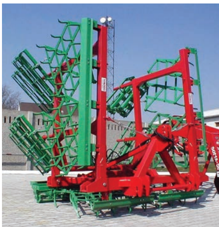
2. kép. Függesztett-fogasborona konstrukció magágykészítéshez szükséges kiegészítőkkal
