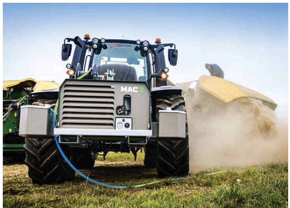
Frontfüggesztésre szerelhető MAC3 MSH MacFarmer mobilkompresszor (fotó: mac3.fr/en/home/agricultural-range )
