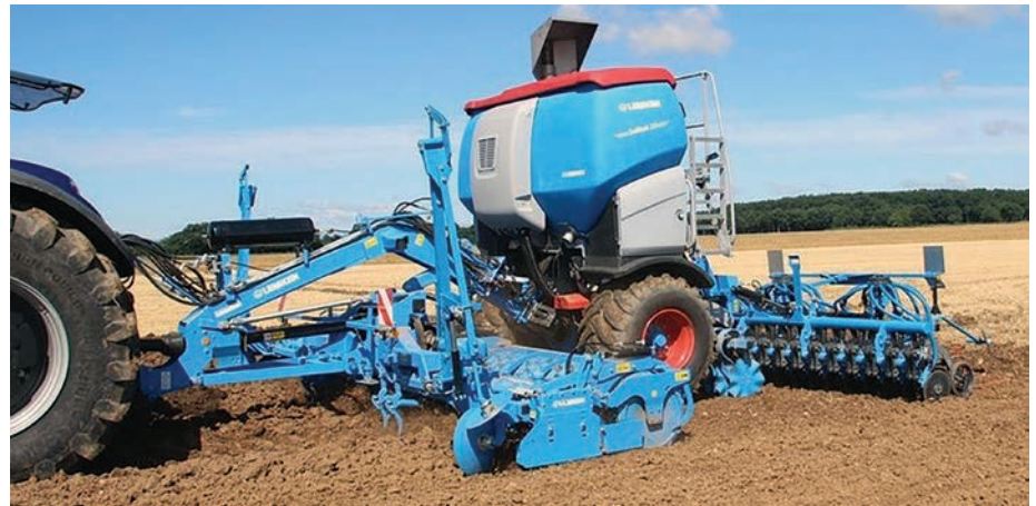
10. kép. Forgóboronás magágykészítés + vetőgép-kombináció
