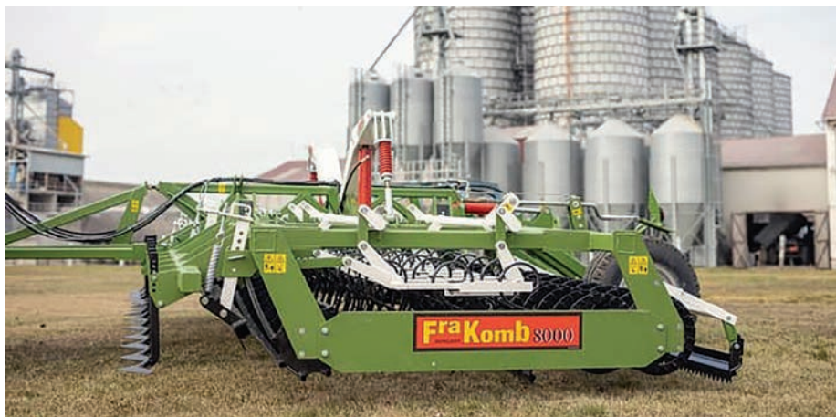
7. kép. A kultivátorszekció gyakran paralelogramma felfüggesztésű
