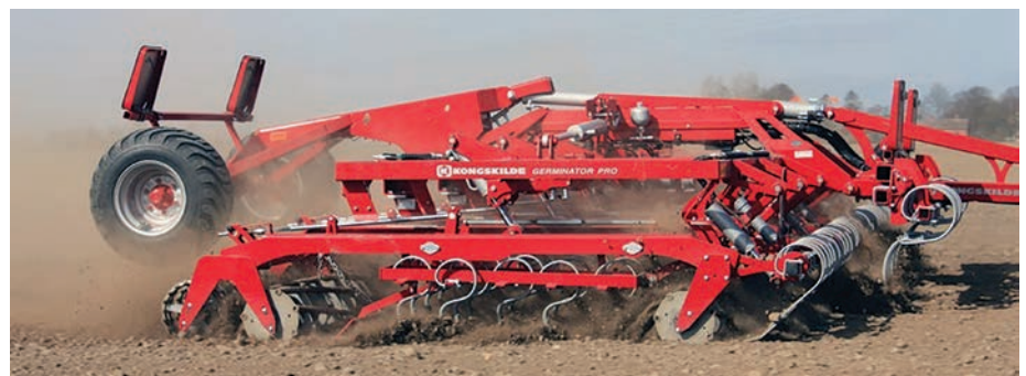
11. kép. Precíziós szintezőberendezéssel felszerelt magágykészítő munka közben
