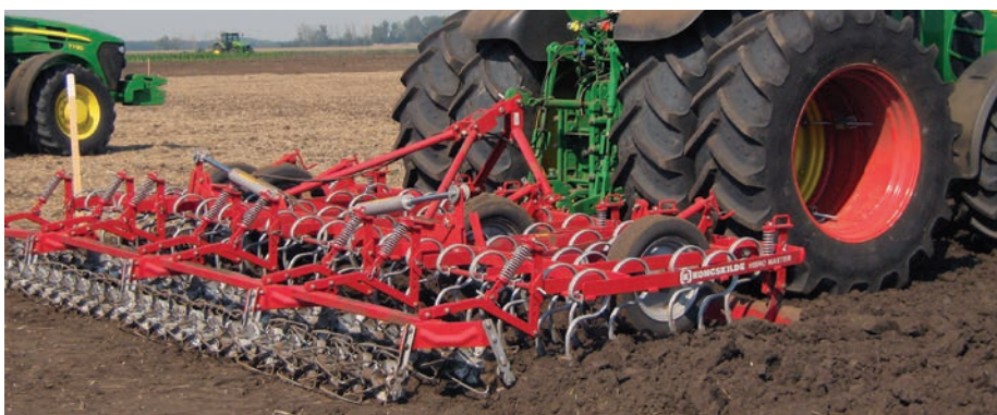
3. kép. Könnyű szántóföldi kultivátorokkal is elkészíthető a magágy
