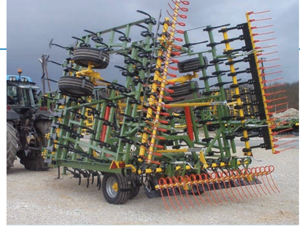
9. kép. Szállítási helyzetben felcsukott magágykészítő
