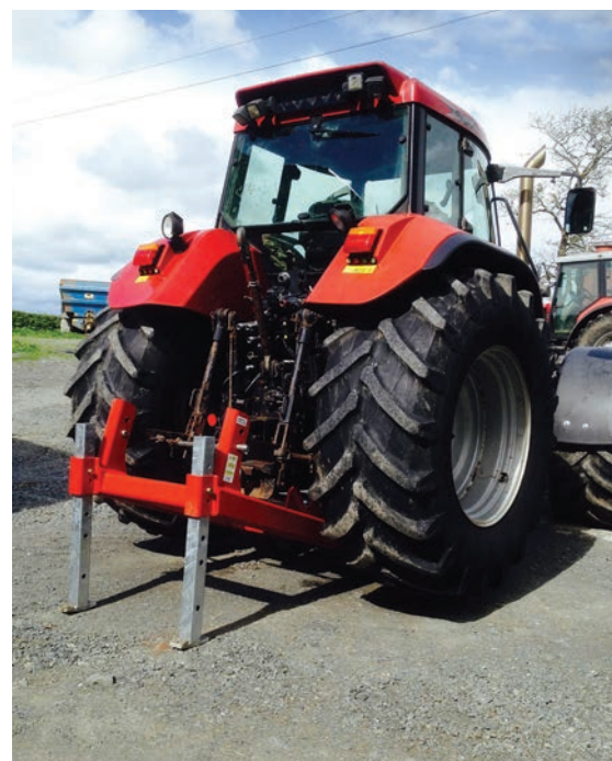
A TrakJak a beépített, több fokozatban állítható támasztólábpárokkal fixálható (fotó: trakjak.ie)
