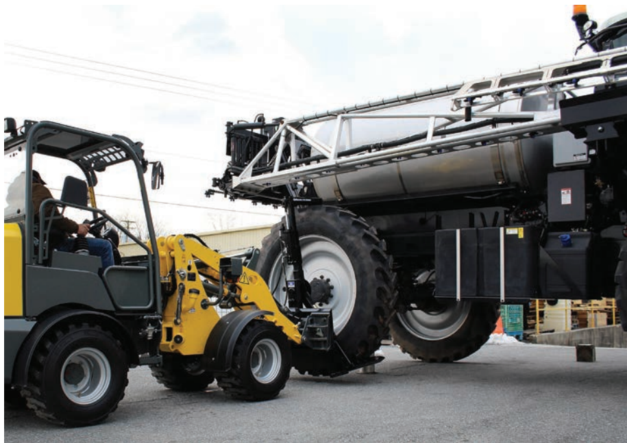
A rakodóra szerelhető GVM Multi-Grip kerékszerelő adapter önjáró permetező kerekének kiemelése közben (fotó: gvminc.com/multi-grip-tire-handler )
