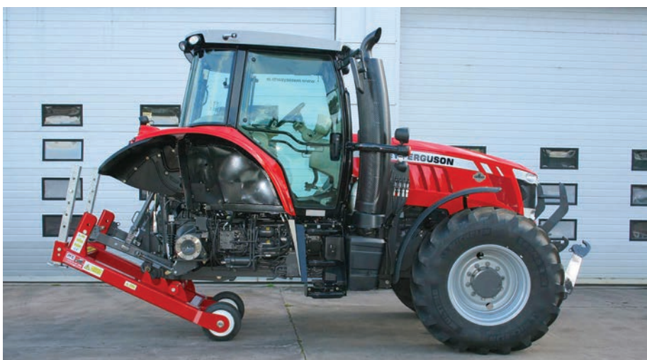
A TrakJak emelőkerettel a traktor saját magát emelheti fel bárhol, ahol stabil a terep hozzá (fotó: trakjak.ie)
