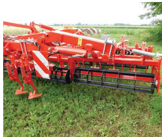
5. kép. Merev kapás szárú, lúdtalp alakú kapákkal szerelt nyomlázítók
