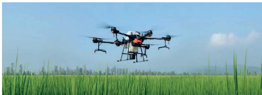
3. kép. 20 literes tartállyal felszerelt permeteződrón (forrás: www.djiars.hu/termek/agras-t20-dron )
