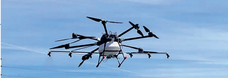
2. kép. 16 literes tartállyal ellátott permeteződrón (forrás: ttadrone.en.made-in-china.com/product/xbTpsLWhhY/China-Tta-M6e-G200-16-Kg-Agricultural-Spraying-Aircraft-for-Crop-Monitoring-Crop-Drone-Sprayer.html )
