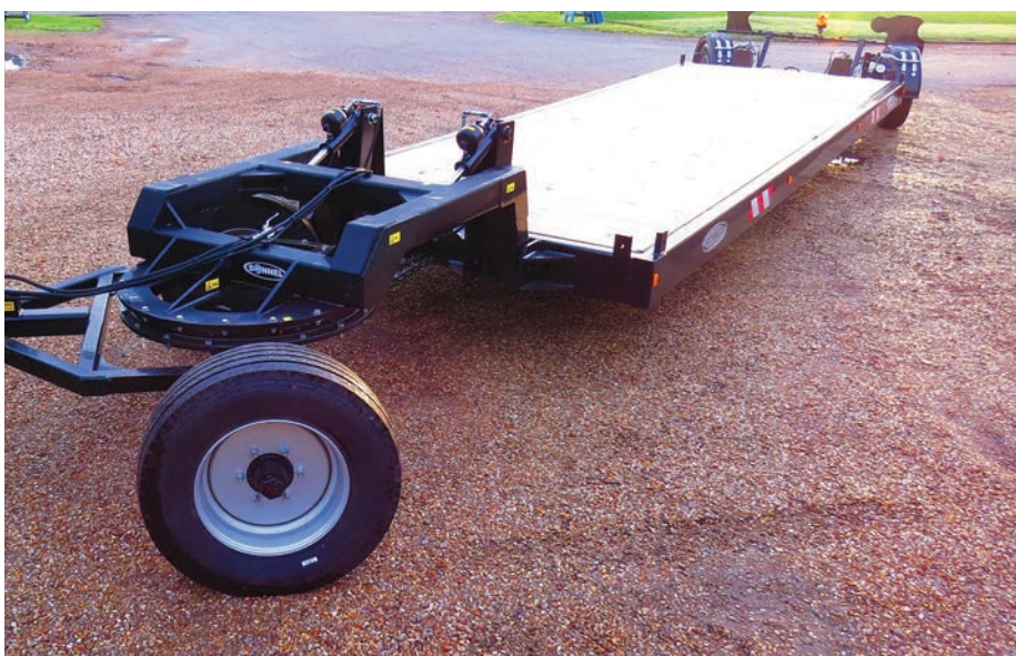
A forgószámolyos kormányzású mellső tengely(fotó: bonnel-sa.com)
