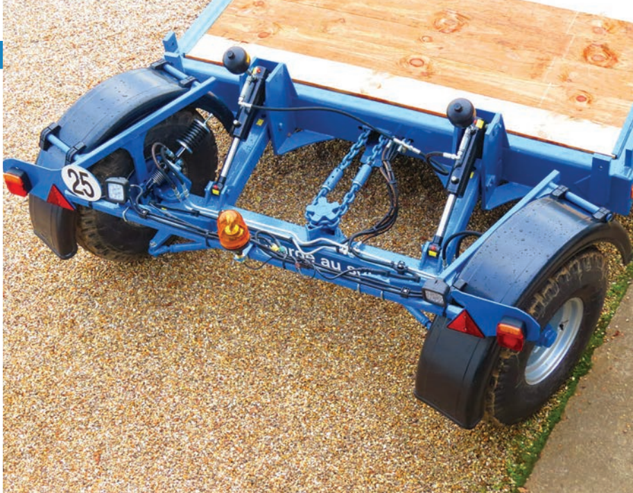
Forgózsámolyról kényszerkormányzott hátsó tengely (fotó: bonnel-sa.com)
