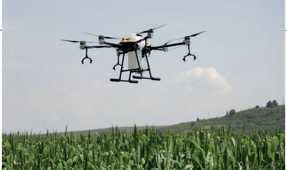
4. kép. 30 dm 3 -es tartállyal szerelt permeteződrón (forrás: facebook.com/photo?fbid=282558560548545&set=pcb.282558670548534)
