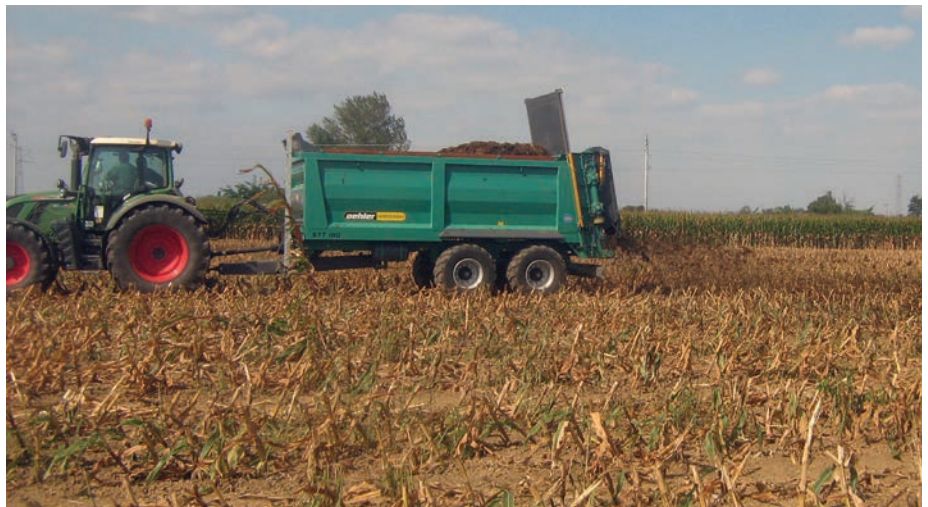
4. kép. Szilárd fázis és istállótrágya keverékének kijuttatása szervestrágya-szóró pótkocsival
