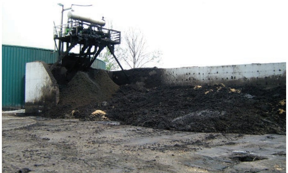
5. kép. A biogáz mellékterméke is a hígtrágyához hasonlóan kerül feldolgozásra
