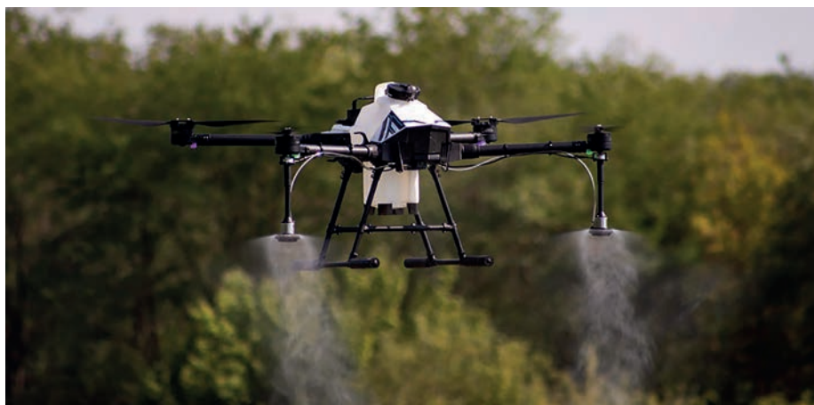
1. kép. Permeteződrón 10 literes tartállyal (forrás: abzinovation.com/distributor)
