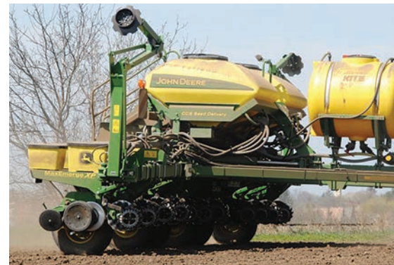
Összevont feladatokra alkalmas John Deere 1775 CCS szemenkénti vetőgép
