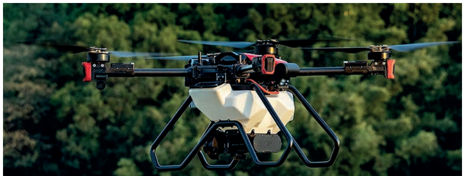
5. kép. Permeteződrón 40 literes tartállyal szerelve (forrás: airborne-solutions.co.nz/p100)
