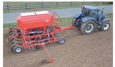
Sprinter 4 ST – vetés és műtrágyázás mulcsos talajfelszínen
