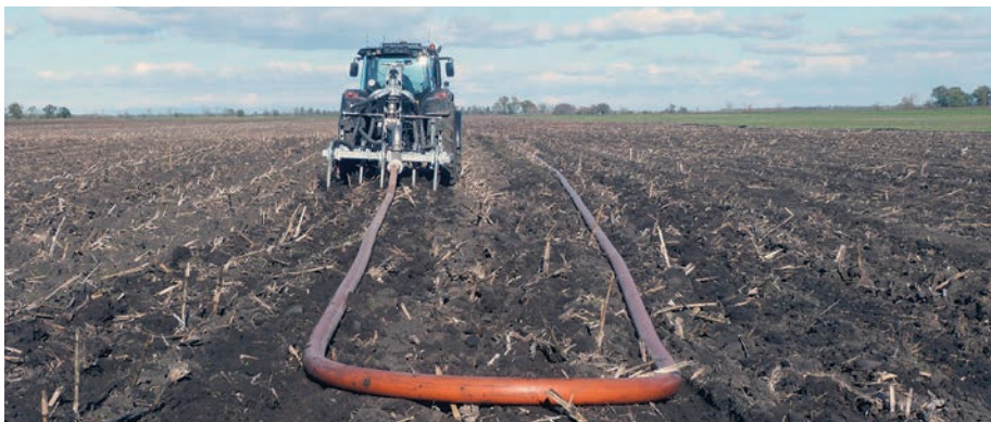
10. kép. Köldöksöves adapter munka közben
