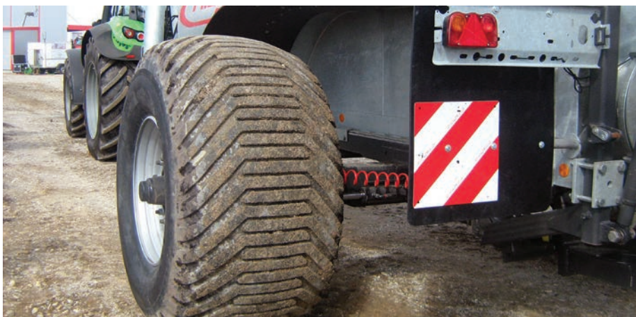
2. kép. A kitolható kerekű járószerkezetek alkalmazásával elkerülhető az egy nyomon járásból eredő káros talajtömörödés
