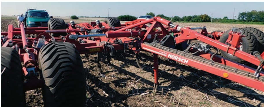
1. kép. A fajlagos talajterhelés csökkentésére még a talajművelő gépek járószerkezetét is alacsony nyomású gumibroncsokkal szerelik fel
