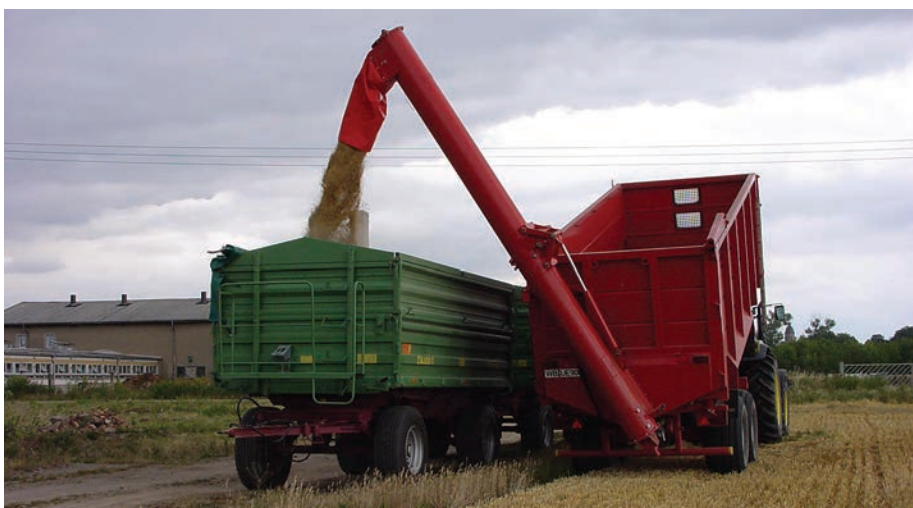
Hagyományos támasztósúlyos billenőplatós pótkocsi átrakócsigás hátfallal, munka közben (fotó: www.annaburger.de )
