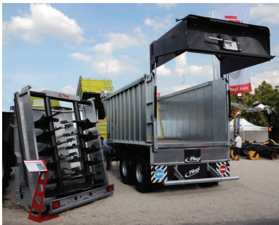
Nyitható hátfallal szerelt letolórendszerű pótkocsi, mellette pedig a helyére adaptálható szervestrágyaszóró adapter
