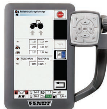
5. kép. A gumiabroncsok belső nyomását szabályzó rendszer, illetve terminál
