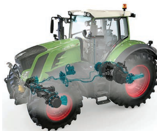
5. kép. A gumiabroncsok belső nyomását szabályzó rendszer, illetve terminál
