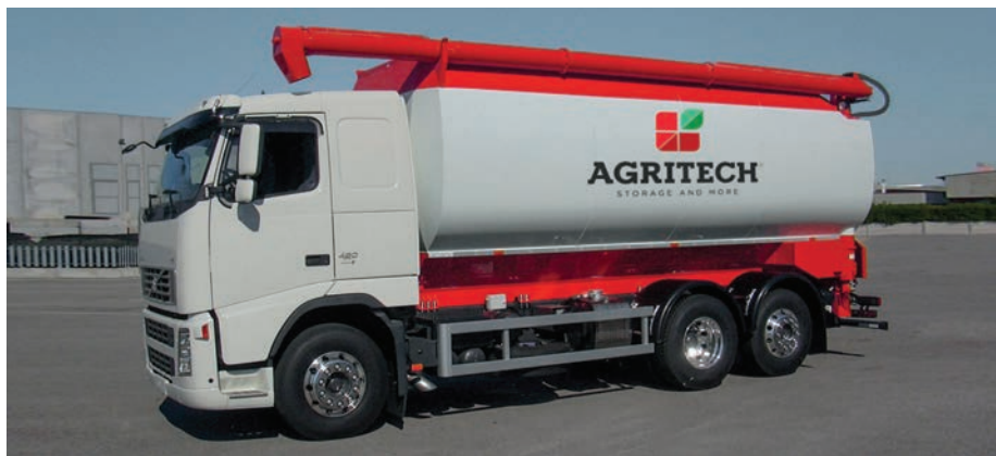
Csigás ürítésű, tehergépkocsi-felépítményes verzió (fotó: www.agritech.it )
