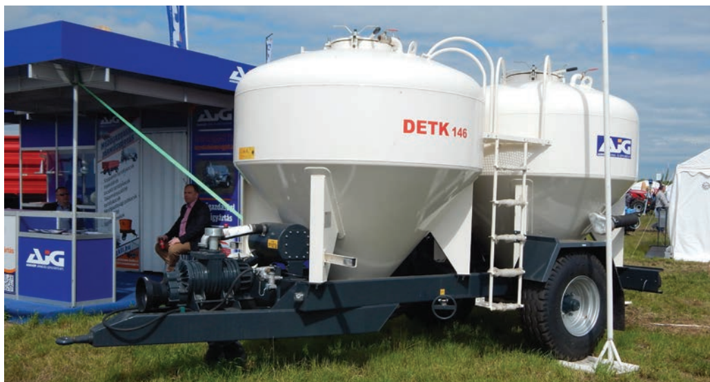
Álló duplatartályos, traktorvontatású, hazai gyártású, fluid üritésű kocsi
