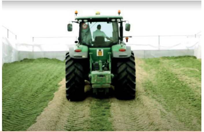
Klasszikus egymenetes betakarítás sorfüggetlen kukoricaadapterrel és taposás szárazanyag-növelő adalékkal, rétegesen (abrak)
