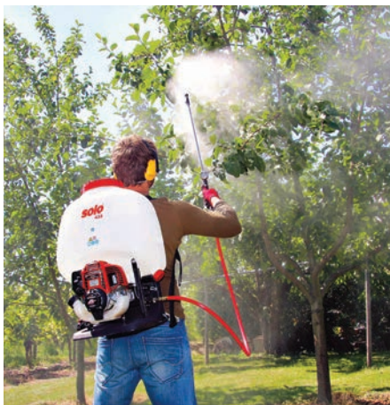
Permetezés hidraulikus rendszerű négyütemű benzinmotoros háti permetezőgéppel (forrás: https://shop.solo.global )
