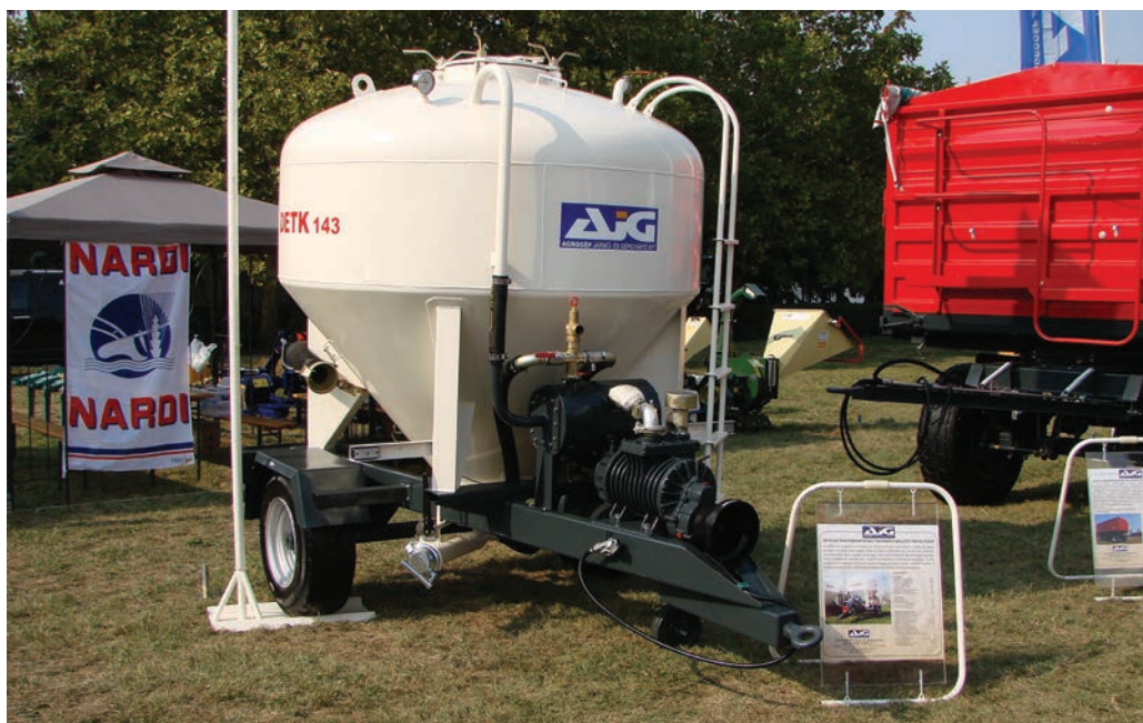
Állótartályos, traktorvontatású, hazai gyártású, fluid üritésű kocsi
