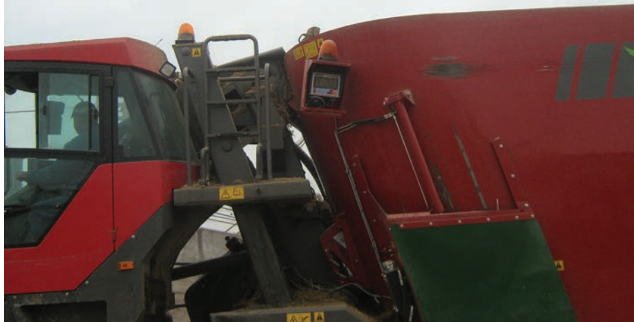
10. kép. A keverő-kiosztó kocsik többsége külső másodkijelzővel van felszerelve
