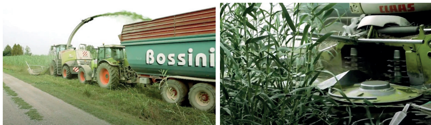
Egymenetes betakarítás biogázüzemi céllal (Olaszország, 2022), Claas Jaguár járvaszecskázó sorfüggetlen kukoricaadapterrel
