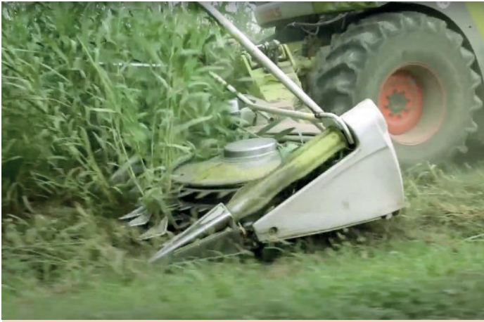
Klasszikus egymenetes betakarítás sorfüggetlen kukoricaadapterrel és taposás szárazanyag-növelő adalékkal, rétegesen (abrak)
