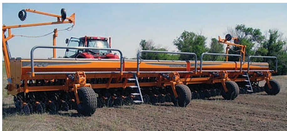
4/a-b. kép. Kis és nagy munkaszélességű, soronkénti magadagolású gabonaszorvetőgép-konstrukció
