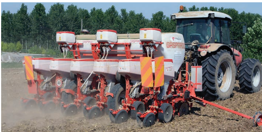
1. kép. Vetőgépre szerelt mikrogranulátum-szóró adapterek (forrás: interatrt.hu/portfolio/mte-mte-isotronic-pneumatikus-pontoszto-teleszkopos-vazzal-kukorica-napraforgo)
