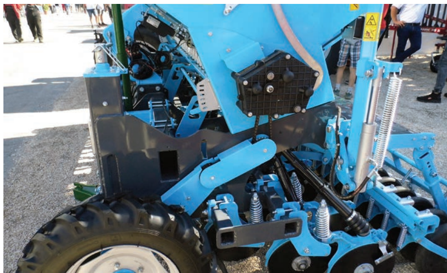
3. kép. A pontos vetőmagnorma a fogaskerekes hajtóművel pontosan beállítható
