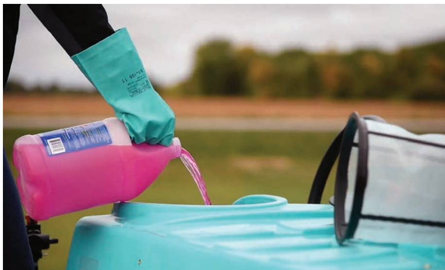
A keret szélességétől, illetve a tartály térfogatától függően 15–50 liter tömény fagyálló-koncentrátumot kell a komplett rendszeren keresztül átjártatni (fotó: blog.enduraplas.com )
