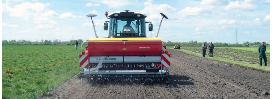
1. kép. Korszerű soronkénti magadagolású gép munka közben
