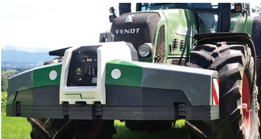
3. kép. Terra Care AirPower kompakt felépítésű levegőszolgáltató egység (forrás: www.terra-care.at/en/compressors/ )
