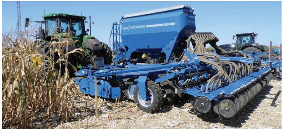
5/a-b. kép. Kis és nagy munkaszélességű, pneumatikus gabonaszorvető gép
