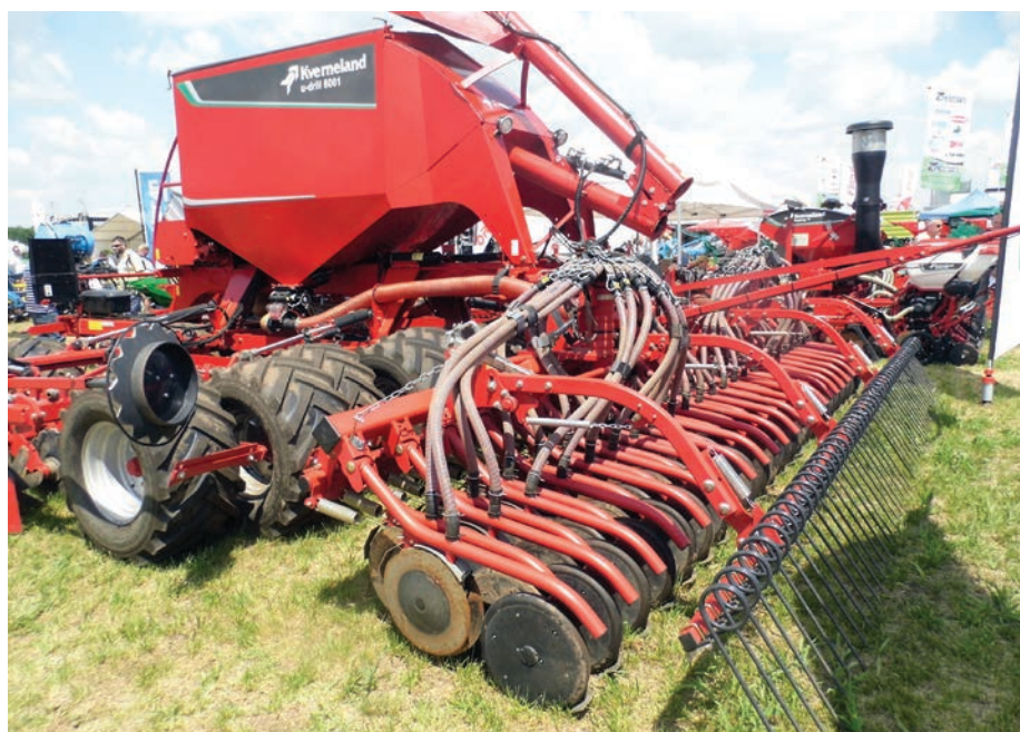
7. kép. Pneumatikus gép csoroszlyaszerkezete
