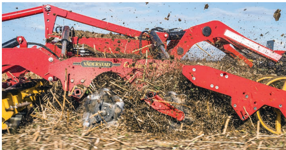
A Carrier XT a jól ismert Carrier rövidtárcsacsalád legújabb tagja, amely nagy sebességű alpművelésre éppúgy használható, mint magágykészítésre
