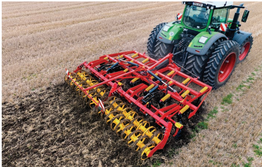
A Cultus HD kultivátor 30 cm mélységig képes átdolgozni a talajt, három gerendelyre szerelt kapáinak osztása 27 cm
