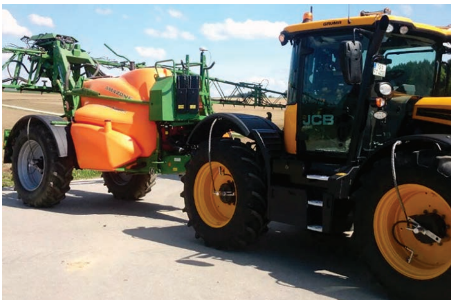
1. kép. Terra Care központi gumiabroncs-felfújó rendszer alkalmazása traktorhoz és vontatott mezőgazdasági munkagéphez (forrás: www.terra-care.at/en/trailer/ )
