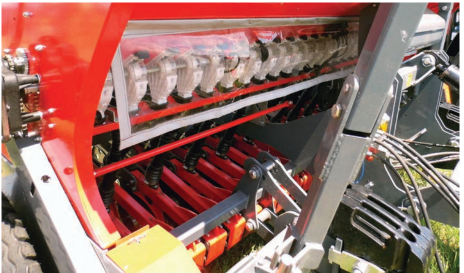
2. kép. Tolóhengeres vetőszerkezet
