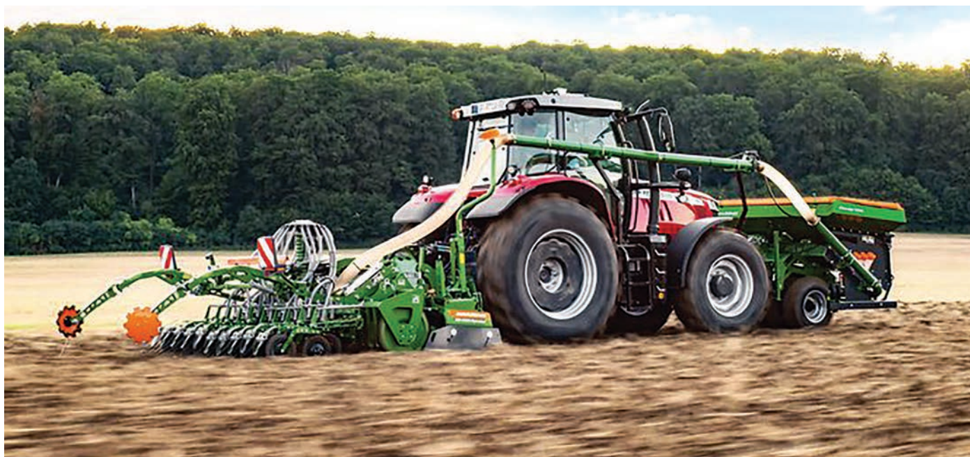
8. kép. Frontfüggesztésű magtartályos vetőgép munka közben
