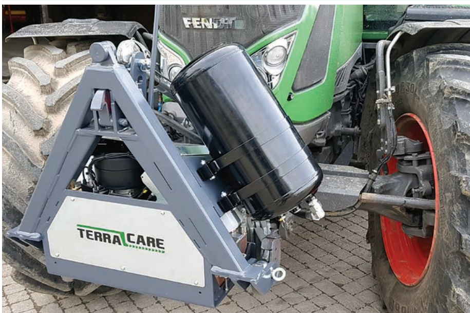
2. kép. Terra Care AirPower integrált felépítésű levegőszolgáltató egység (forrás: www.terra-care.at/en/one-compressor-many-solutions/ )
