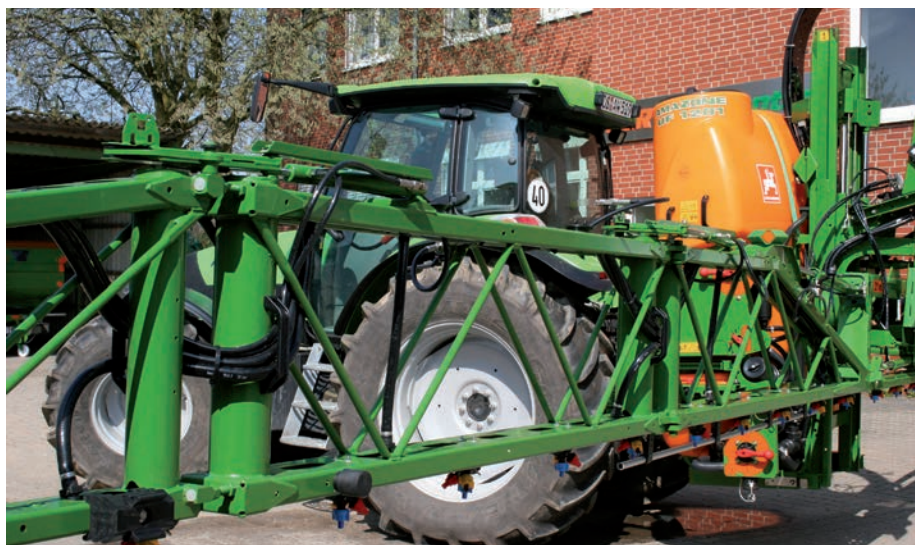
Nagyon figyeljünk arra, hogy a folyadékcszállítást végző csővezetékek ne legyenek megtörve, ne képződjön nyomás a tömlőrendszerben (fotó: media.amazon.de/hu )
