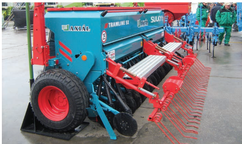
3. kép. A pontos vetőmagnorma a fogaskerekes hajtóművel pontosan beállítható
