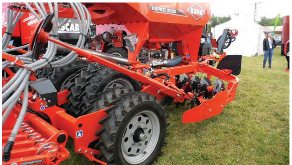
6/a-b. kép. Pneumatikus gépek magadagoló és elosztószerkezete
