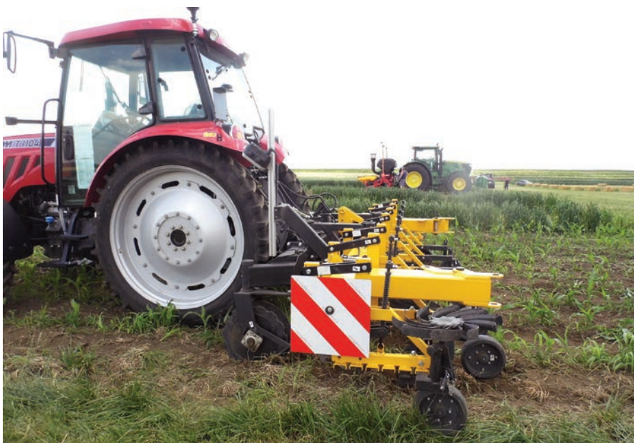
6. kép. Kamerával vezérelt forgókapás konstrukció
