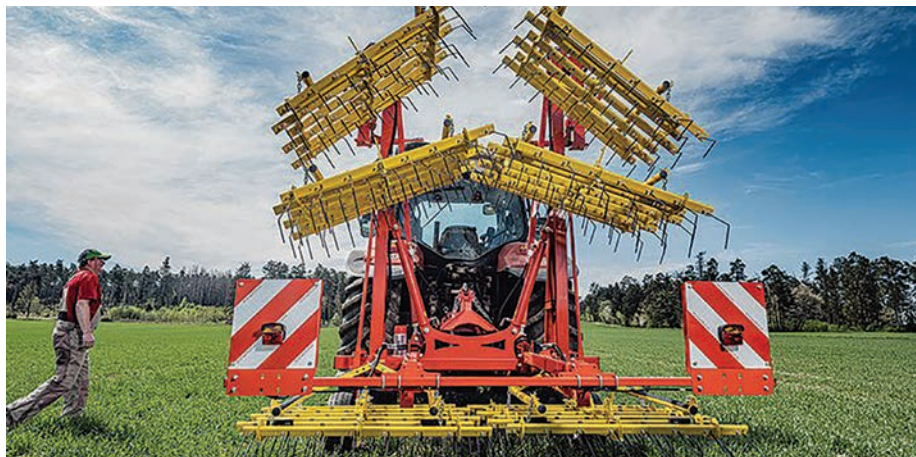
2. kép. Szállítási helyzetben az oldalsó boronatangok középre felemelhetőek
