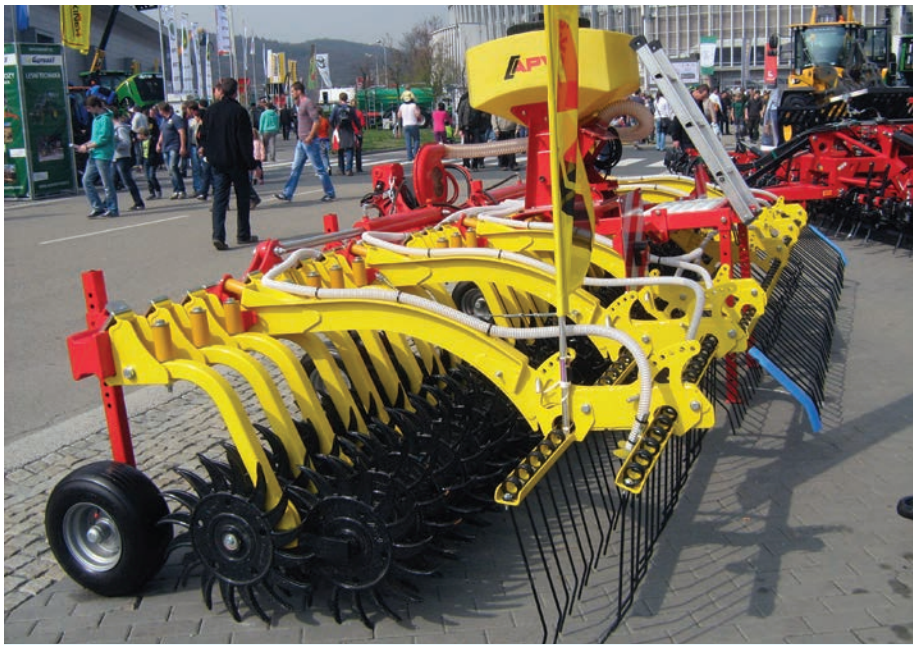
5. kép. Küllőskapá-, gyomborona- és sorvetőgép-kombináció
