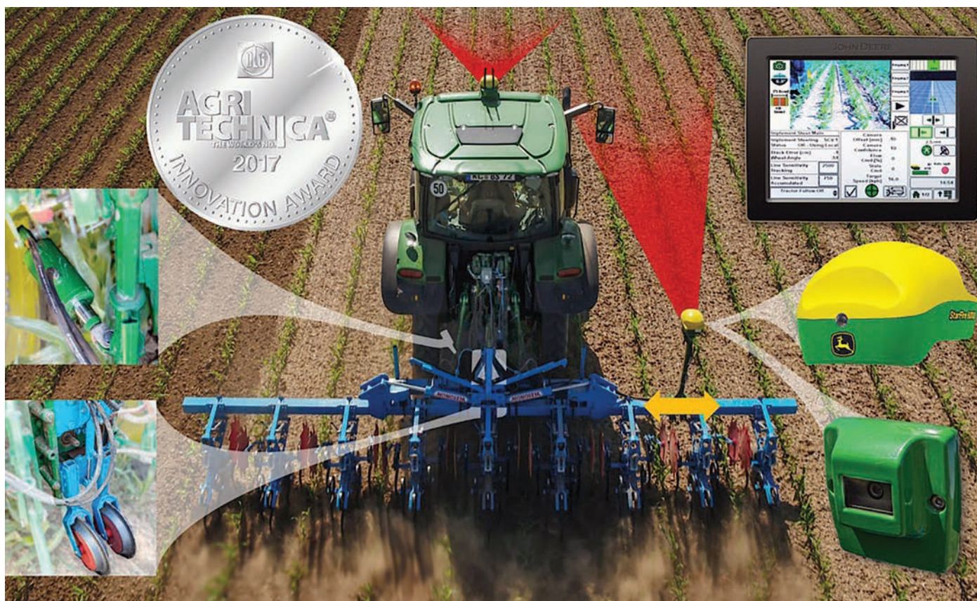
9. kép. A szenortechnológia és a GPS-alkalmazás biztonságos sorközművelést biztosít
