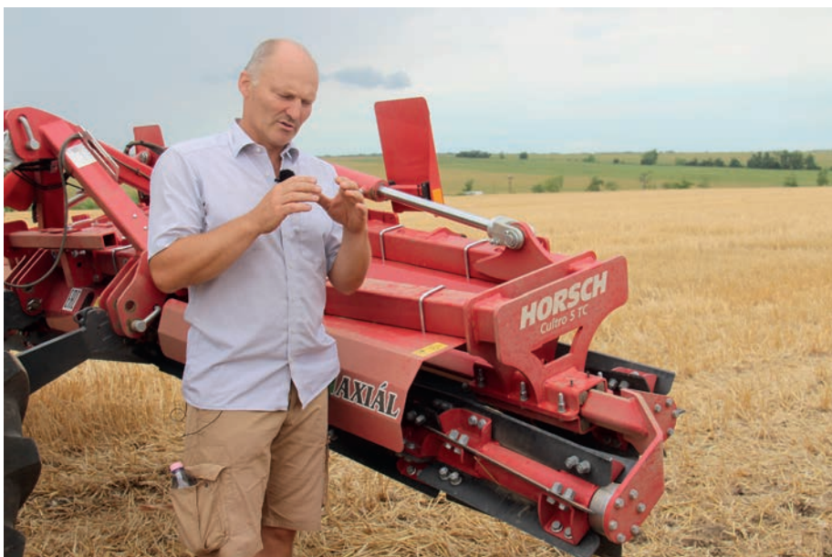
A HORSCH Cultro 5 TC (front) száraprító henger a kukoricatarlón áthúzva felhasználja a tarlót, így a kukoricamoly lárvája kevésbé tud megbújni, és kiszárad
