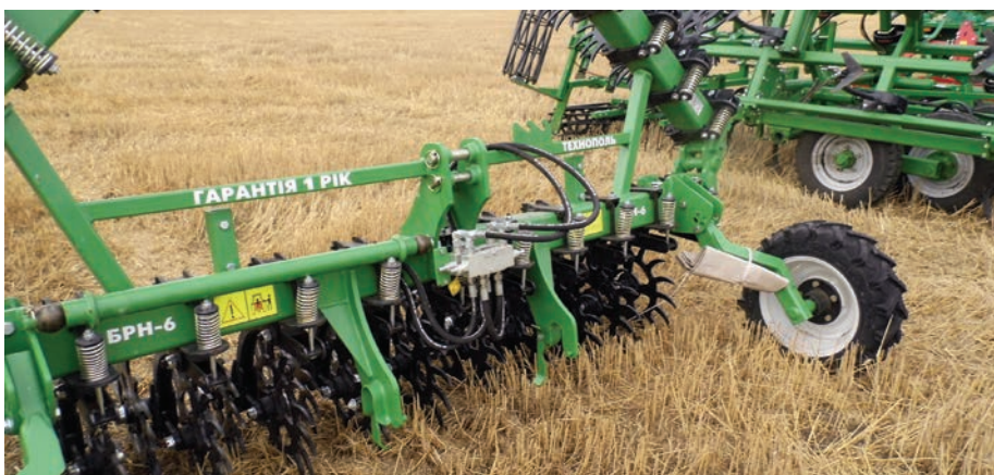
4. kép. Az összecsukható vázkeretű küllőskapa-konstrukció
