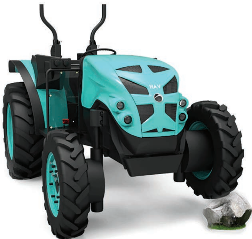
1. kép. HAV S1 45 STD típusjelzésű, soros hibrid hajtású traktor (forrás: www.hybridagrivehicle.com )
