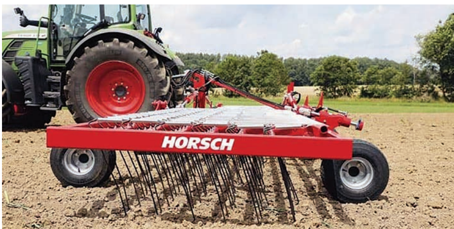
3. kép. Központi rugóterhelés-állítású gyomfésű-konstrukció
