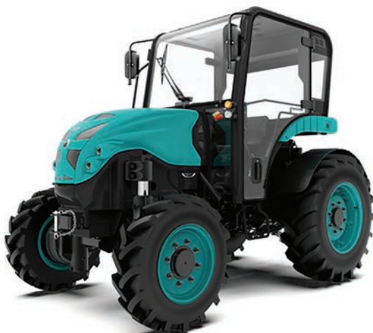
2. kép. HAV S1 55 STD típusjelzésű, soros hibrid hajtású traktor (forrás: www.hybridagrivehicle.com )
