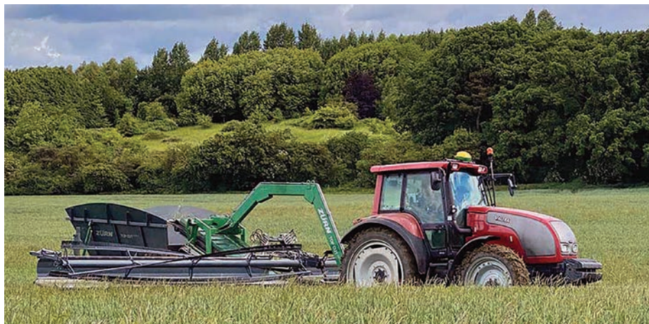
1. kép. Felgyomosodott állományban dolgozó gyomkaszó gyűjtőtartállyal
