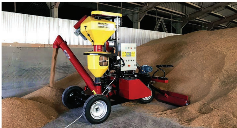
1. kép. MOBITOX típusú, önjáró kivitelű csávázógép munka közben (forrás: http://www.farmgep.hu/mobitox )
