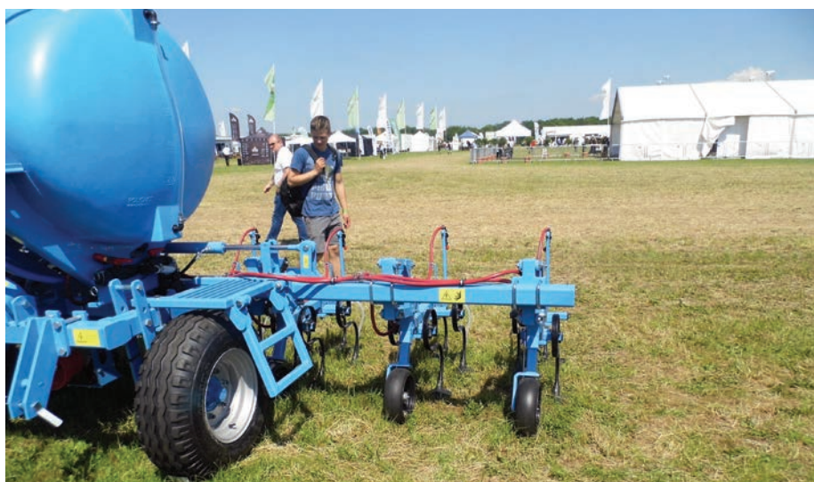
10. kép. Műanyag tartályos folyékonytápkultivátor-konstrukció
