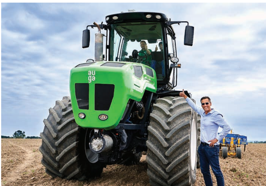
3. kép. Auga M1 Eco típusú, 400 lóerős hibrid biometán-elektromos traktor (forrás: www.world-today-news.com/auga-group-introduces-a-hybrid-tractor/ )
