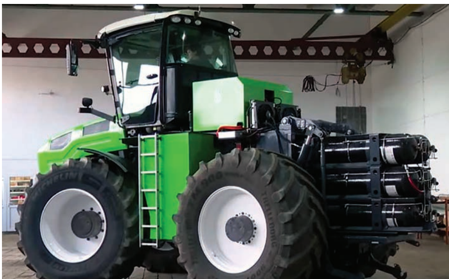
4. kép. Auga M1 Eco típusú hibrid traktor és biometán-tároló gázpalack egysége (forrás: www.commercialvehicle.in/the-hybrid-auga-m1/ )
