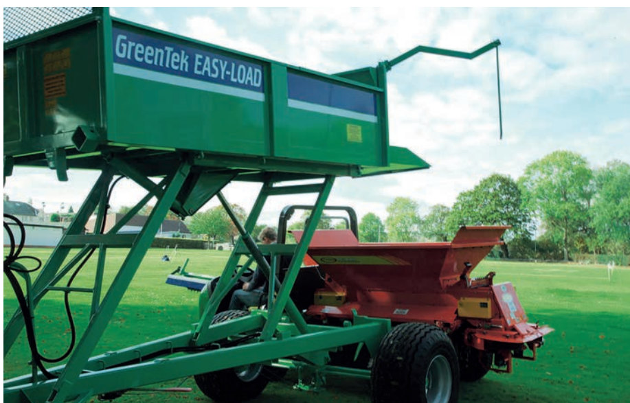
Már a kompakt traktorokhoz is kínálnak 3 tonna teherbírású emelve billentő pótkocsit (fotó: https://www.greentek.uk.com/ )
