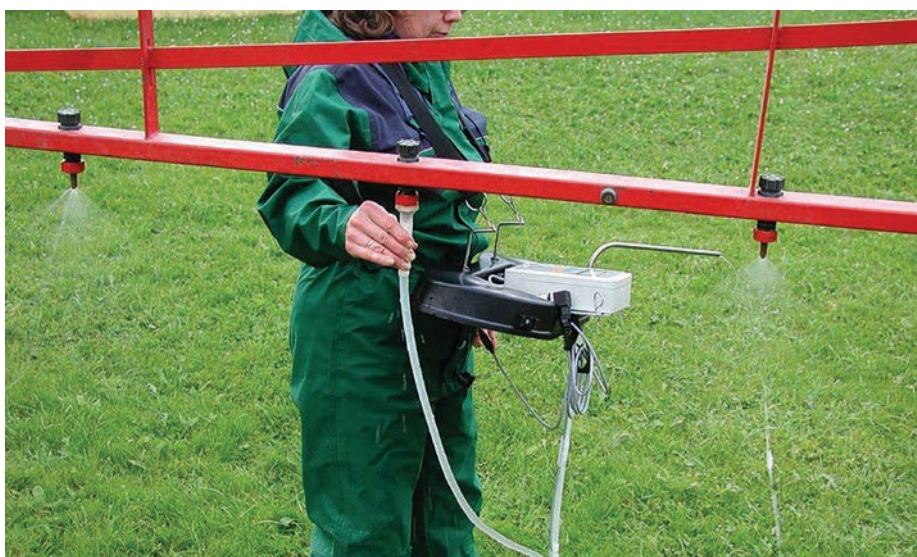
4. kép: Szórófejek szórásteljesítményének ellenőrzése szántóföldi permetezőgépen (forrás: https://www.agronaplo.hu/szakfolyoirat/2019/02/gepesites/permetezogep-uzemi-beallitasa-ellenorzese )
