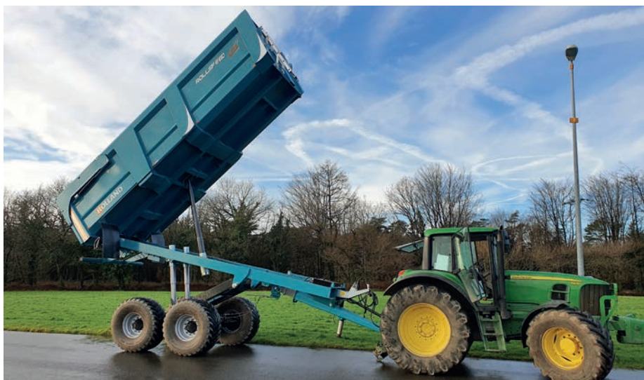
Francia fejlesztésű, speciális, ollós emelésű változat (fotó: https://www.remolquesrolland.fr/ )
