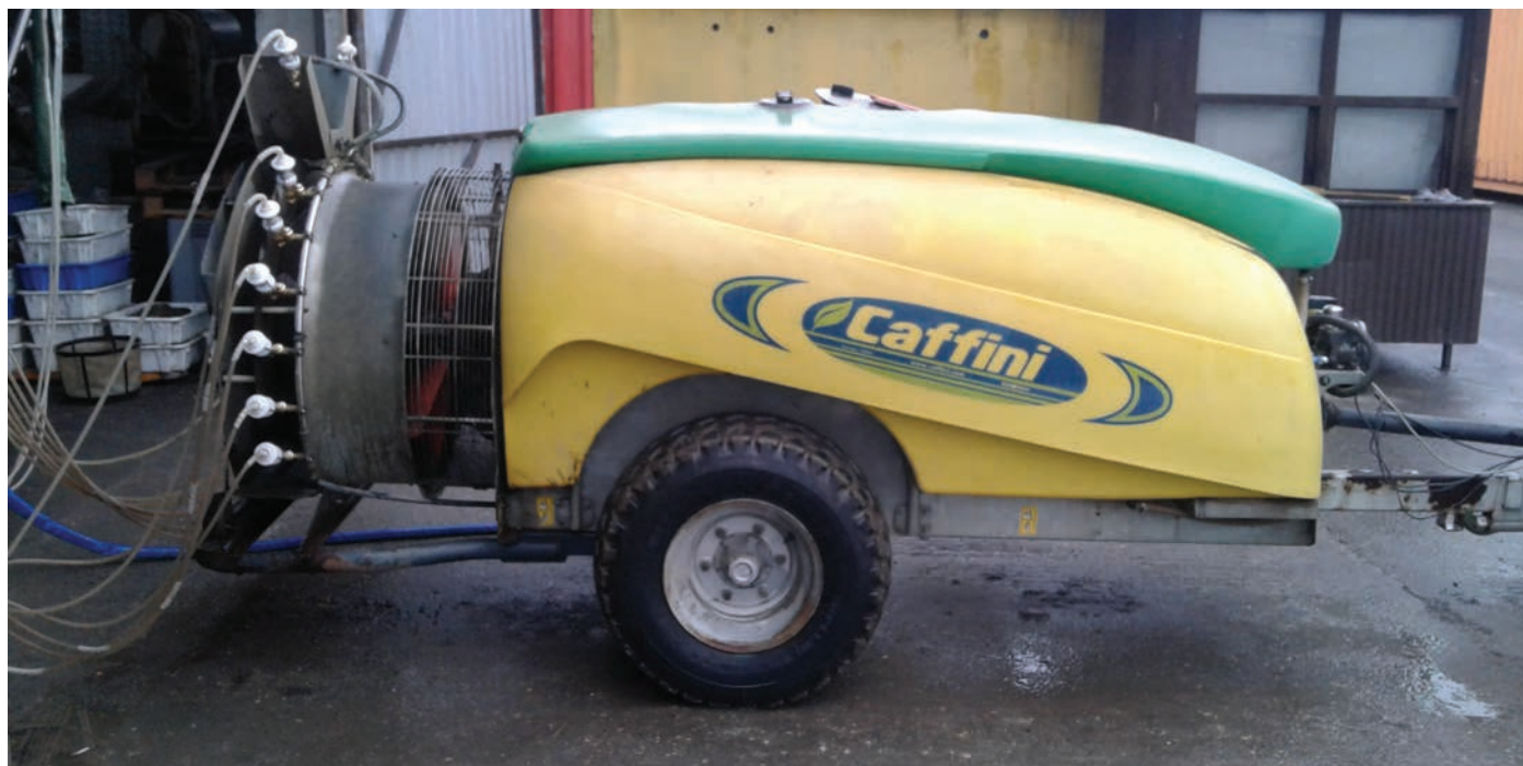
3. kép: Szórófejek szórásteljesítményének vizsgálata korszerű módszerrel ültetvénypermetező gépen (forrás: szerzők saját felvétele)
