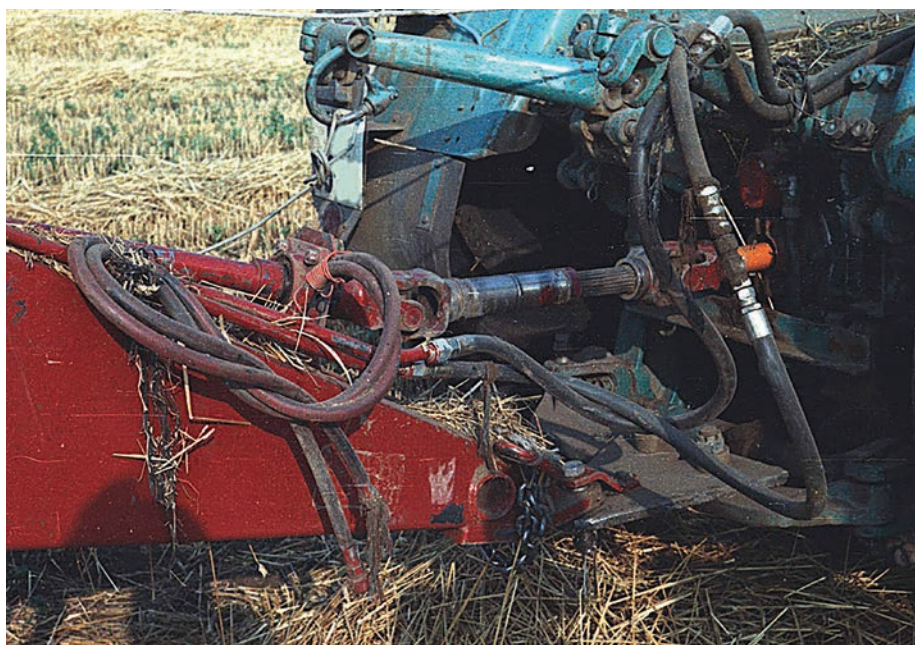
2. kép: Élet- és balesetveszélyes kardántengelykapcsolat (forrás https://www.agroinform.hu/gepek-et/s-akit-a-nk-idot-a-kardantengelyek-ellenorzes-re-31111-001 )
