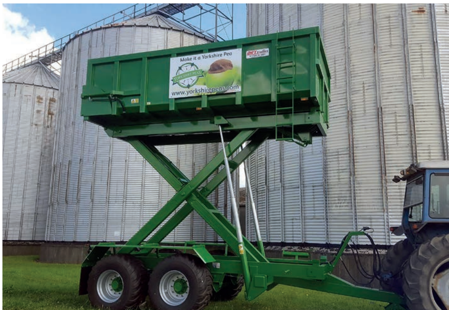
Ollós emelőrendszer, közepes teherbírású, de nagy emelési magasságú konstrukció (fotó: http://drtrailers.co.uk/trailer )
