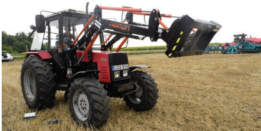
1. kép. Az újabb típusokon a munkaeszköz párhuzamvezérlésére hidraulikus munkahengereket alkalmaznak
