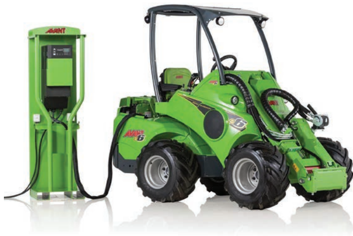
6. kép. Az elektromos rakodók gyorsöltő egysége
