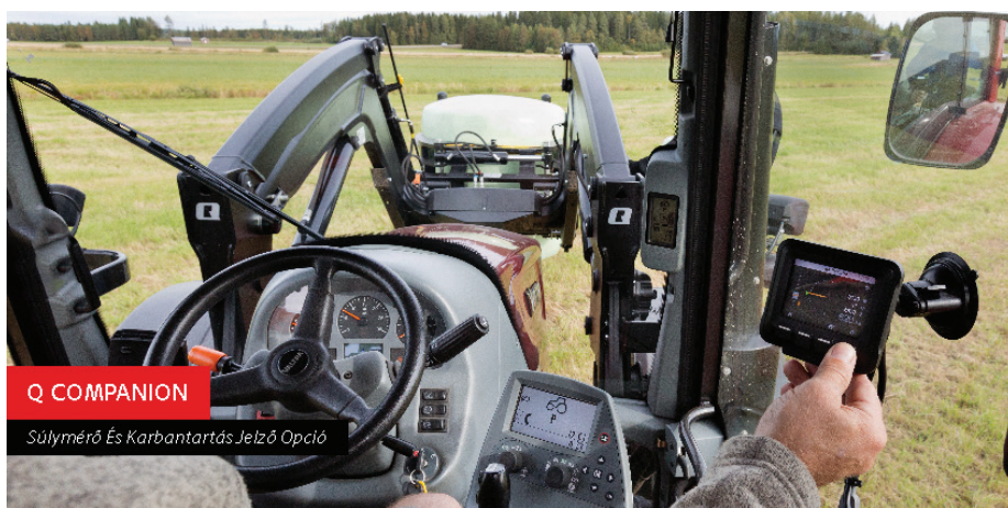
2. kép. A traktoros homlokrakodóknál alkalmazott súlymérő kijelzőterminál kezelőfelülete
