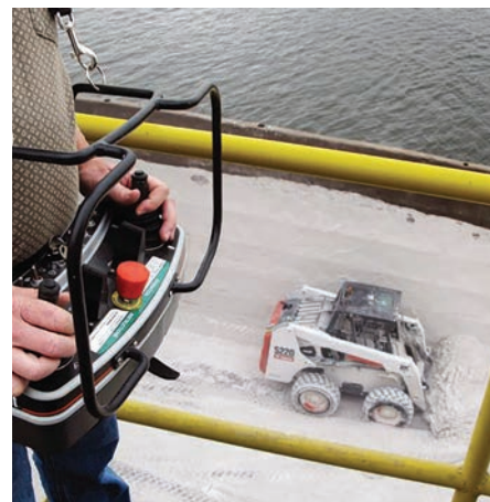
3. kép. Egyes típusok távvezérléssel is üzemeltethetők
