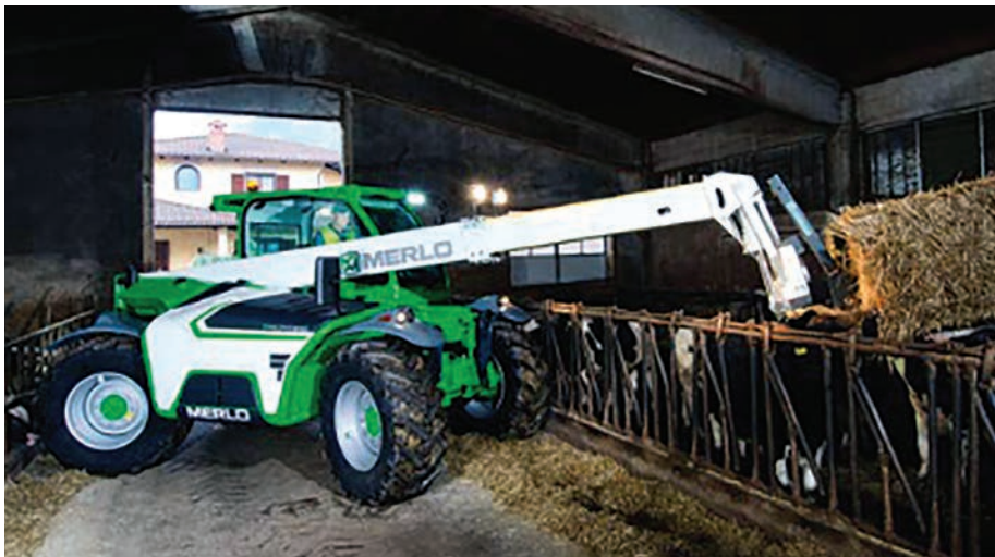
8. kép. A hibrid rakodók istállókban, zárt térben nulla károsanyag-kibocsájtással tudnak dolgozni
