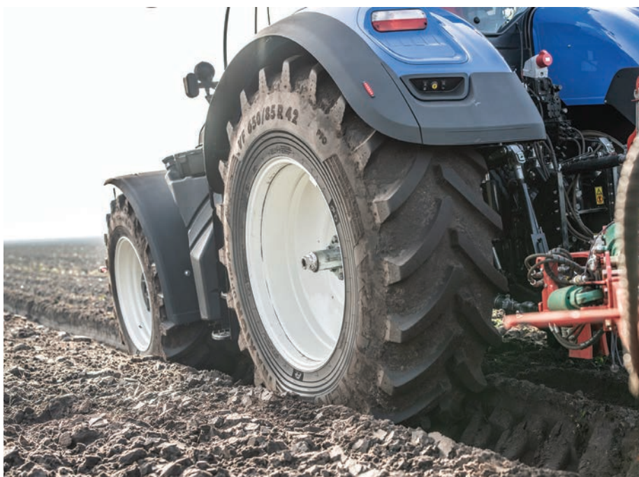
A barázdába tökéletesen illeszkedő Vredestein Traxion Optimall VF650/85R42 ideális a szántáshoz
