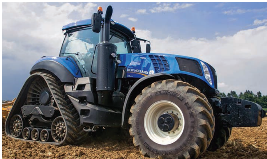
1. kép. New Holland T8.435 Smarttrax, 280 kW teljesítményű univerzális traktor (forrás: www.grostractorspassion.com)
