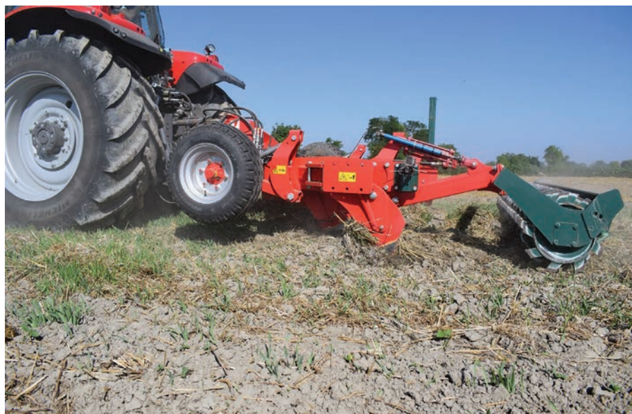
Példa a változó mélységű talajművelésre középmély lazítóval
