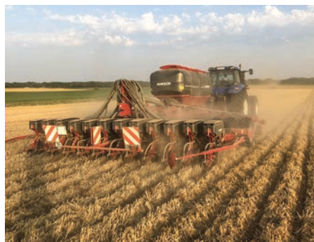
Focus 6.50 TD kukorica-másodvetés rozstartlóba
