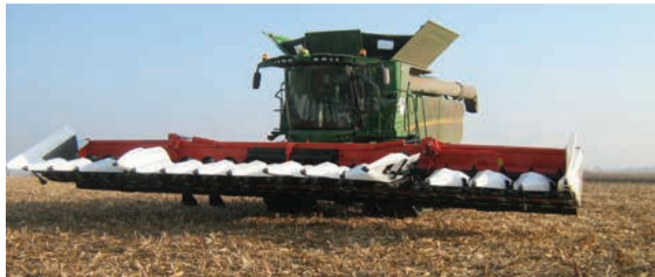
9. kép. A nagy áteresztőképességű és nagy motorteljesítményű arató-cséplő gépek akár a 16 soros adaptert is elbírók
