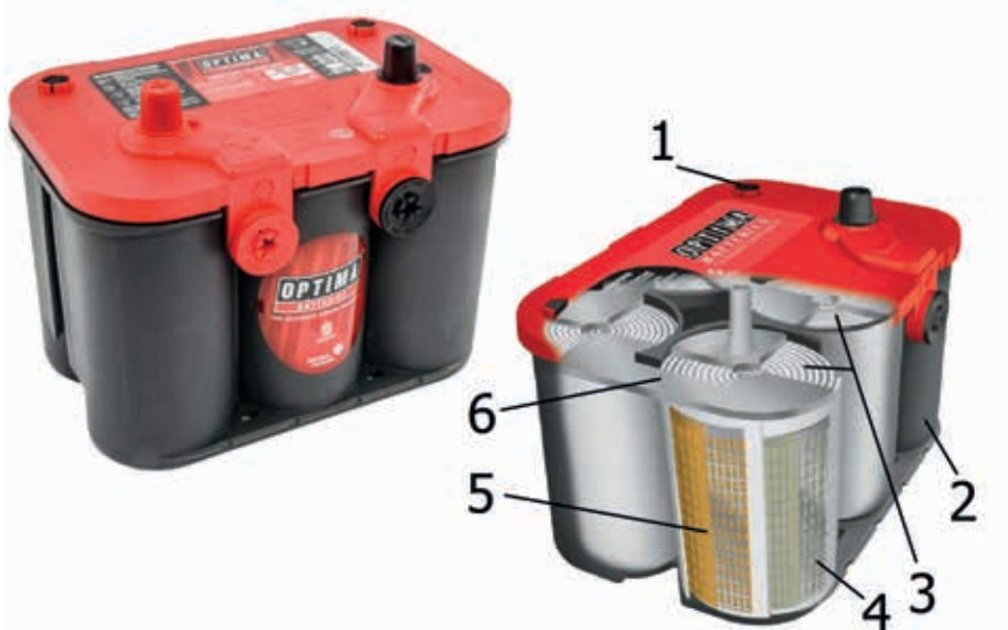
3. kép. OPTIMA „Spirál Cell” ólomsavas száraz akkumulátor: 1. biztonsági szelep, 2. műanyag ház, 3. spirálcella, 4. elektród, 5. abszorbens üvegszövet, 6. cellahíd (forrás: www.optimabatteries.com )
