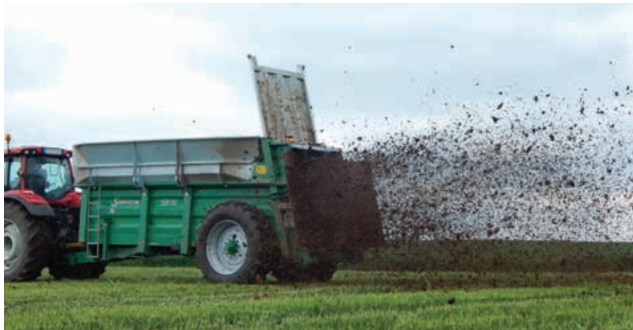
A kaparóléces lehordószerkezetes, szóróhengerpáros szervestrágyaszóró ko- csik szóráségyenletessége optimális
