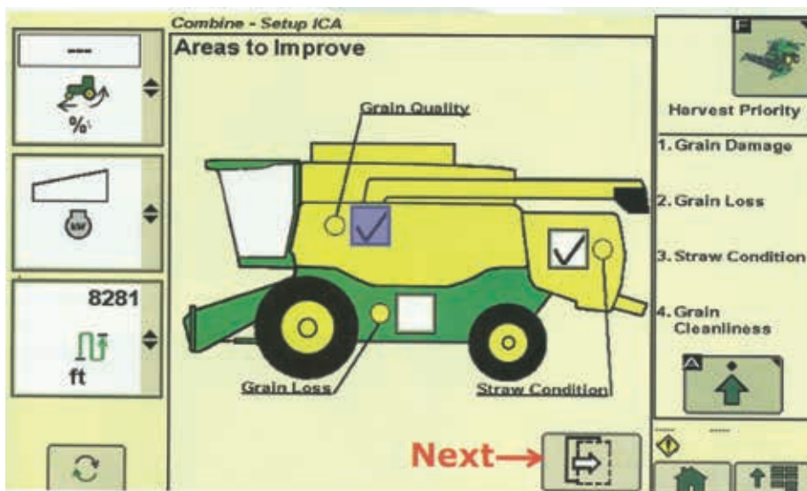
2. kép. A kukoricabetakarításra történő átállást – a legtöbb típusnál – szenzortechnológián alapuló terményfelismerő rendszer segíti
