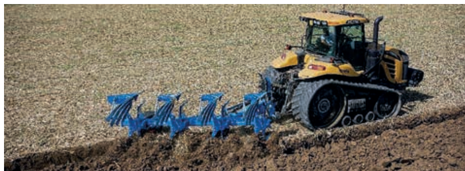
Az új Juwel 10 függesztett ekék toronyszerkezete akár 450 LE-ig használható!
