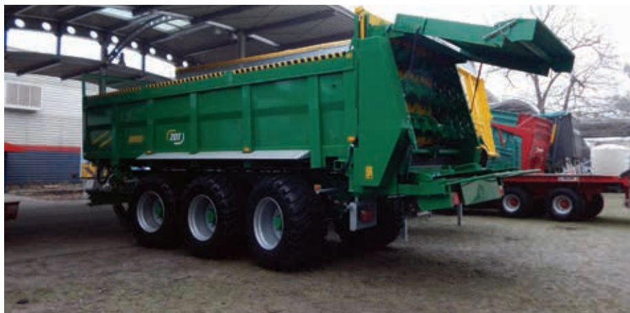
Cserefelépítményes univerzális pótkocsialváz, szervestrágyaszóró felépítménnyel
