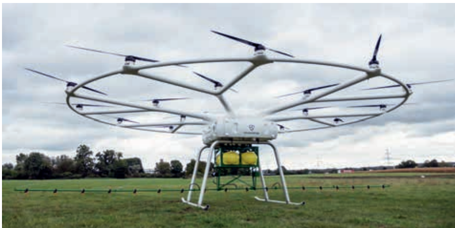
4. kép. A Volocopter és a John Deere mezőgazdasági permeteződrónja 200 literes tartállyal (forrás: https://www.volocopter.com/en/ )
