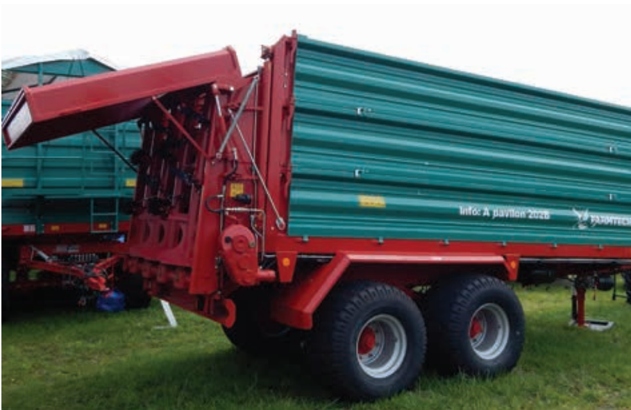
Változtatható raktérkapacitású, univerzális lehordószerkezetes pótkocsi, trágyaszóró adapterrel
