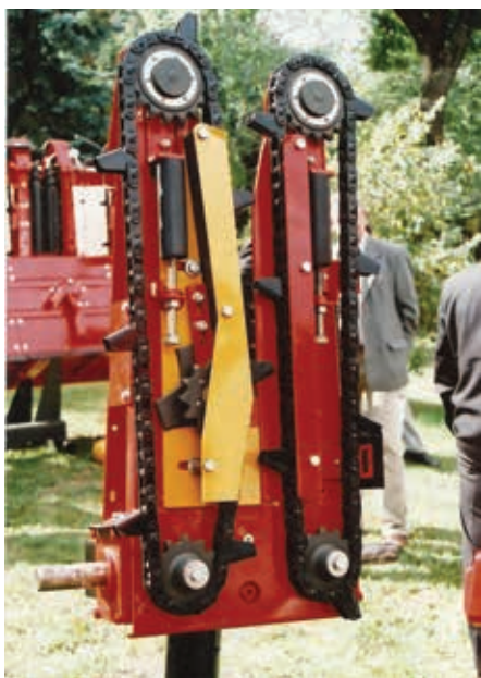
8. kép. A csőtörő adapterek többsége napraforgó-betakarító szettel is felszerelhető
