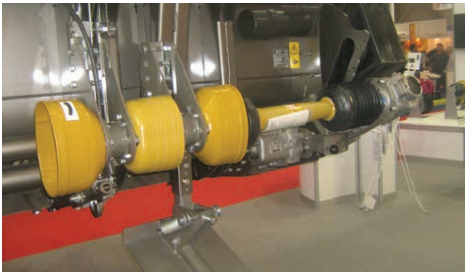
3. kép. Az OptiCorn adaptereknél nagy szilárdságú szerkezeti acélokat építettek be, és zárt hajtásláncot alakítottak ki
