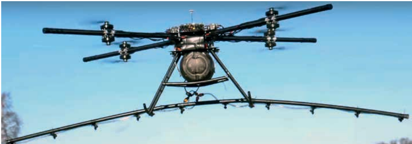
3. kép. AirBoard AGRO mezőgazdasági ipari permeteződrón, 100 literes tartállyal (forrás: https://www.airboard.co/agriculture-drone/ )
