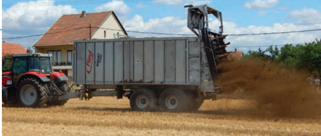
Letoló rendszerű univerzális mezőgazdasági pótkocsi, trágyaszóró adapterrel szerelve, munkában
