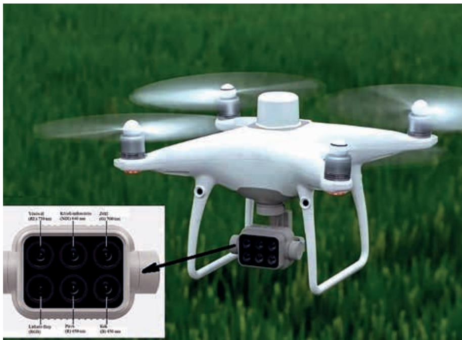
1. kép. DJI Phantom 4 Multispectral drón hattagú kamerarendszerrel (forrás: www.dji.com )
