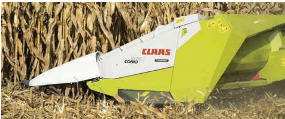
7. kép. A kedvezően kialakított sorválasztó kúpos, és az alacsony talajjal bezárt szög minimalizálja a betakarítási veszteséget
