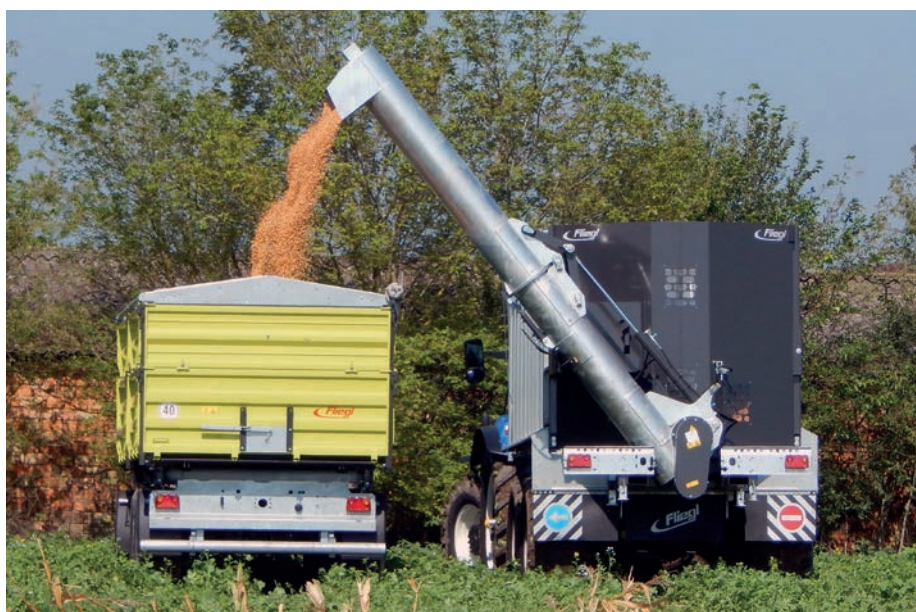
4. kép. Csigás átrakóadapterrel szerelt, letolórendszerű pótkocsi átrakás közben
