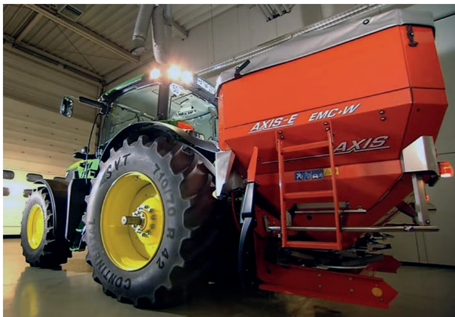
1. kép. Rauch AXIS-E 50.1 EMC+W típusjelzésű kéttárcsás nagyteljesítményű villamos hajtású műtrágyaszóró (forrás: www.youtube.com/_wNlq1RPFaI )
