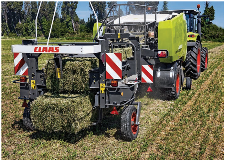
A CLAAS QUADRANT 4000 szögletes nagybálázó, DUO PACK bálagyűjtővel kiegészítve (fotó: claas.de)
