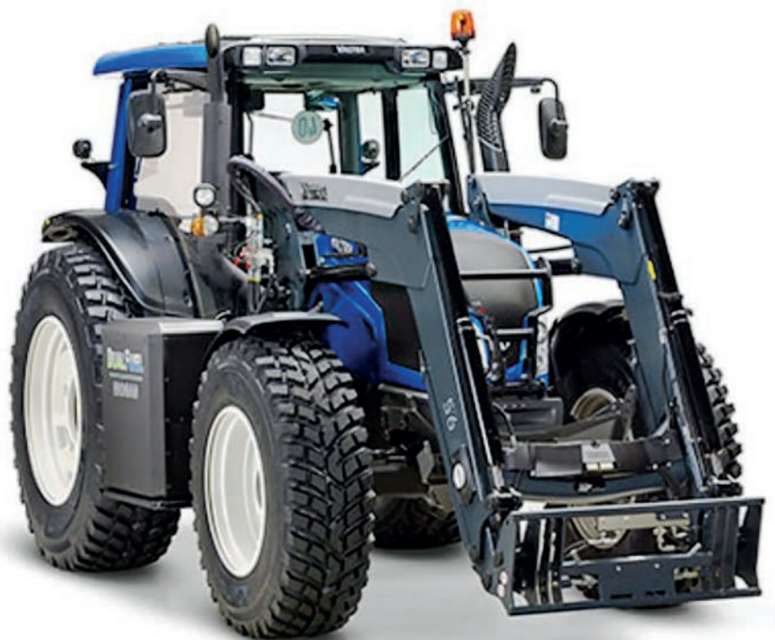
1. kép. Valtra N103.4 HiTech Dual Fuel gázolaj és biometán (vagy CNG) üzemű 121 LE-s traktor (forrás: www.landtechnikmagazin.de )
