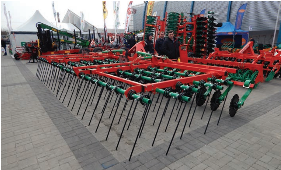
Erősebb, vastagabb átmérőjű, hosszabb rugós pálcákkal szerelt, agresszívabb művelést végző rugósborona
