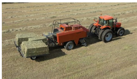
A tengerentúli Hesston volt az úttörő, a szögletes nagybálázóhoz kapcsolható bálagyűjtők bevezetése tén (fotó: hesston.com)
