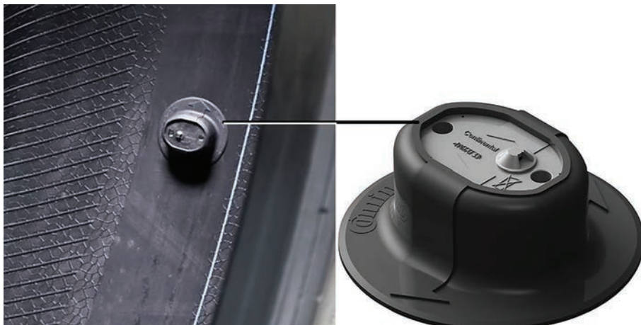
2. ábra. Continental gumibroncs-figyelő rendszerének szenzorra (forrás: www.continental-tires.com )
