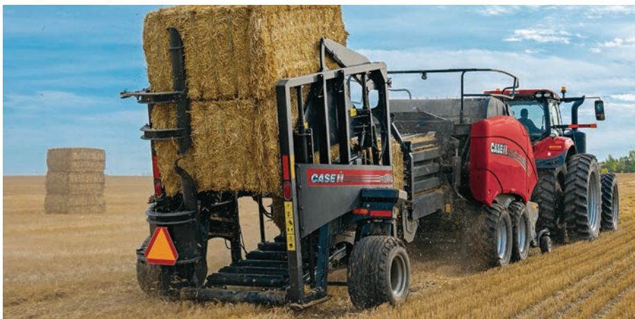
A CASE IH VS 1206 vertikális rendszerű bálagyűjtő, a gyártó tengerentúli kínálatának része (fotó: caseih.com)
