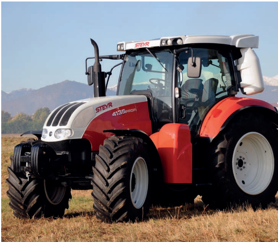
3. kép. Földgáz (CNG) üzemű Steyr Profi 4135 Natural Power traktor (forrás: www.steyr-traktoren.com)
