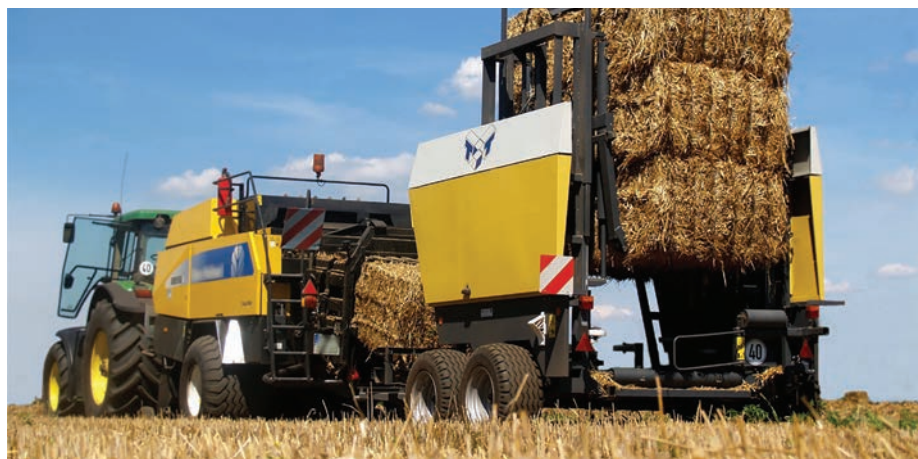
A QUADRO PAC V európai gyártású vontatott, függőleges rendszerű bálagyűjtő (fotó: quadropac.de)
