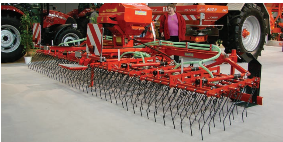
A rugósboronák kerettagjainak központi csapos felfüggesztése biztosítja a tagok talajkövetését
