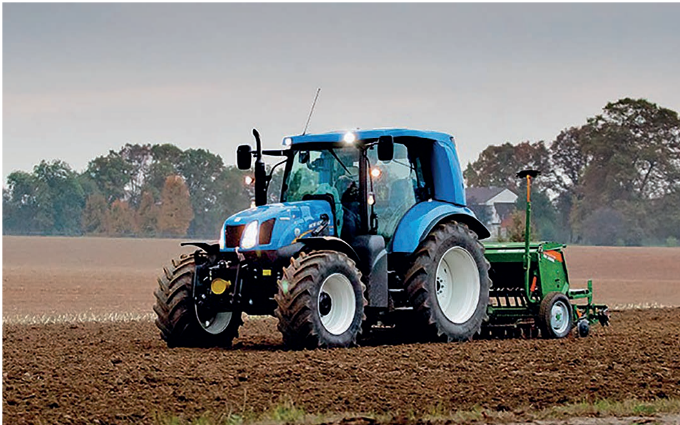
2. kép. New Holland T6.180 Methane Power földgáz (CNG) vagy biometán üzemű 194 LE-s traktor (forrás: www.newholland.com)
