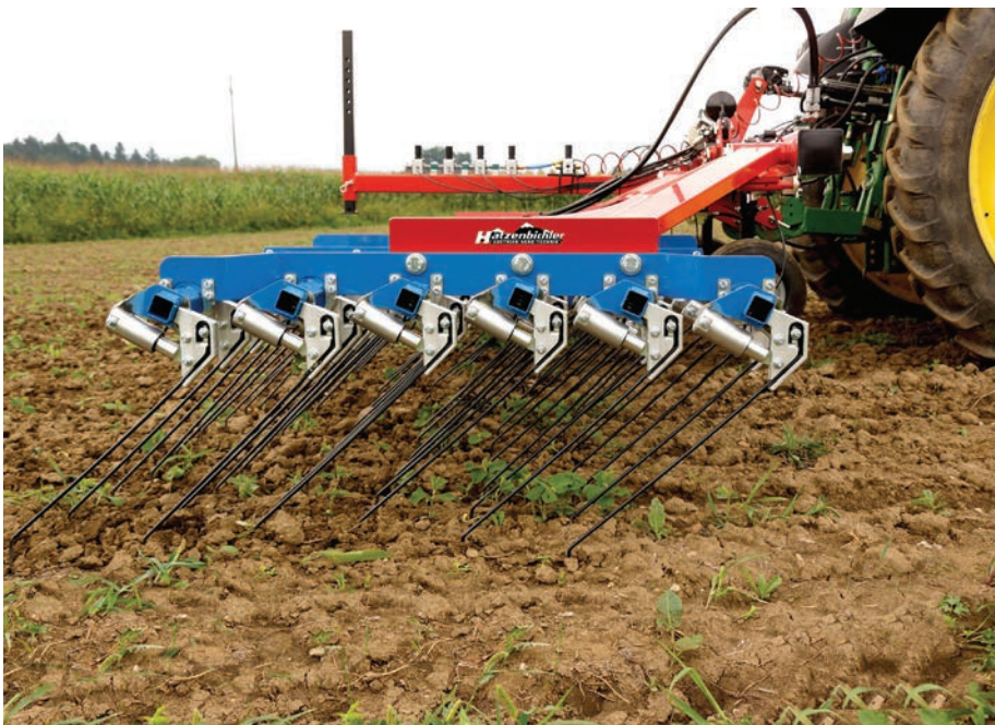
A rugósborona sorok szögállása a legtöbb modellnél vagy fokozatmentesen, vagy több fokozatban állítható (fotó: hatzenbichler.com)
