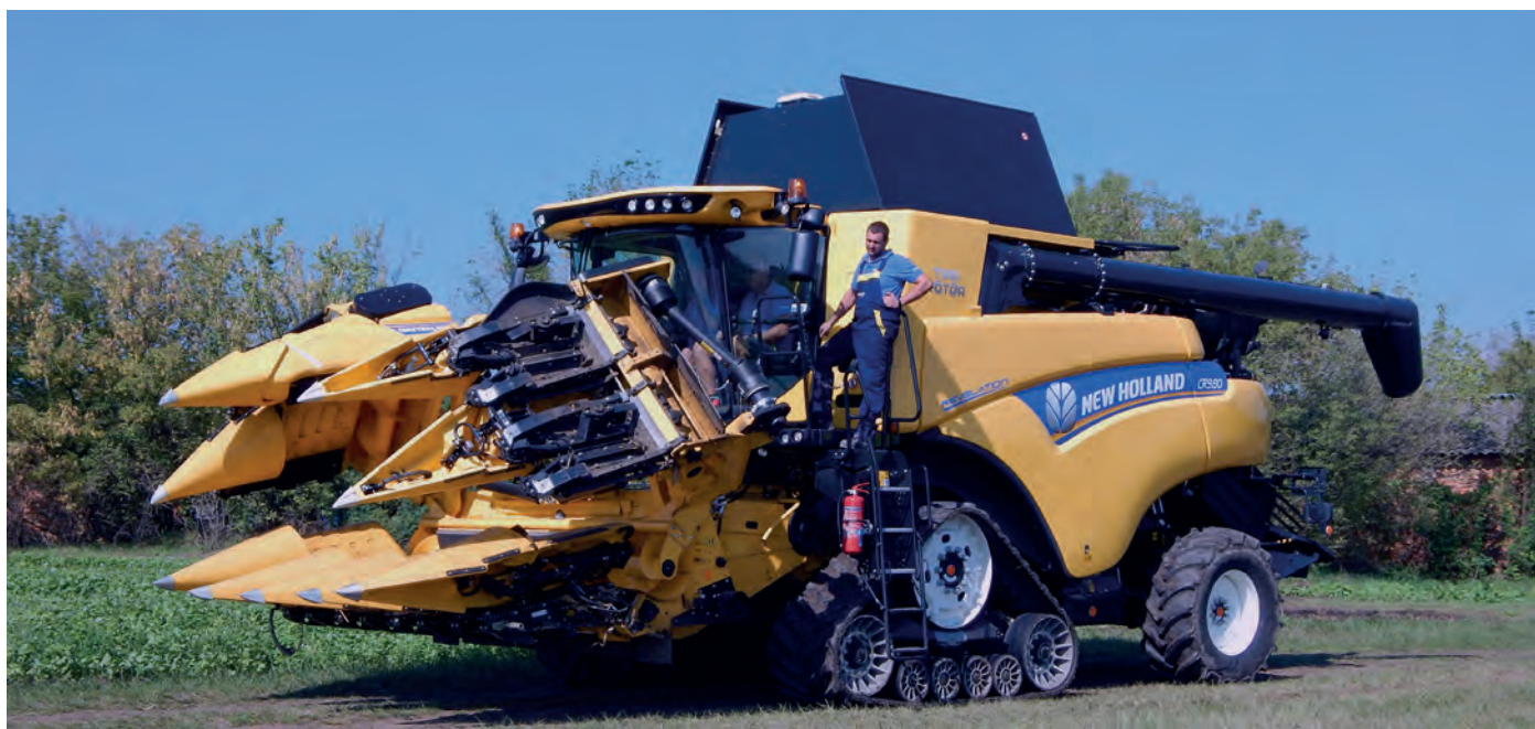
2. kép. Érdemes az összecsuksukható adaptert választani, mert jelentősen csökkenthetjük az áttelepülésekre fordított időt
