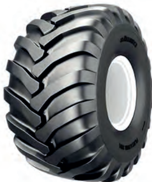
2. kép. Alliance Flotation 331 diagonál gumiabroncs (forrás: https://atgtire.com/brochures/ )
