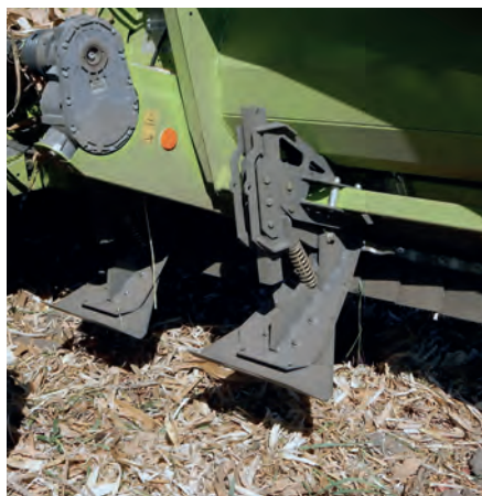
5. kép. Az adapterek kiegészítéseként alkalmazhatók a szártaposók, amelyek megvédik a mellső gumibroncsokat a kukoricacsonkok okozta sérülésektől
