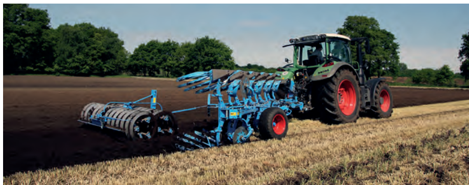
Lemken VarioPack-kal akár vetőágy is készíthető még kötött talajon is
