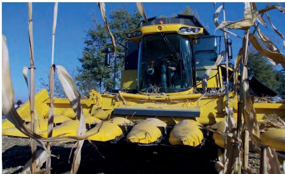
1. kép. Tapogatókaros, sorkövető kormányautomatikával szerelt adapter
