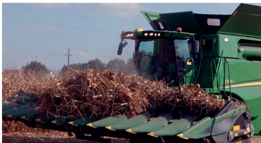
3. kép. Az adapter fordulatszámához nem arányos, túl magas munkasebesség ilyen problémákhoz vezet egy korszerű adapternél is
