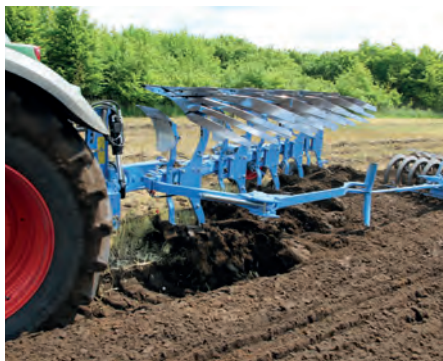
Lemken Juwel 7 M eke mechanikus dőlésszögállítással
