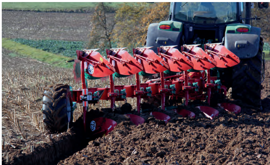
A 38-as Kverneland ekefej alakja a 28-ast idézi, attól viszont magasabb, így nagyobb szántási mélység érhető el
