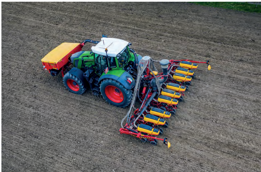
A WideLining rendszer teljesen automatizált, vezérlése a Väderstad E-Controlon keresztül valósul meg
