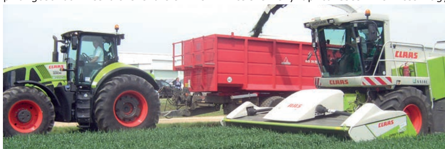
4. kép. Szántóföldi vágóasztallal szerelt szecskázó kalászos szenázskészítésben
