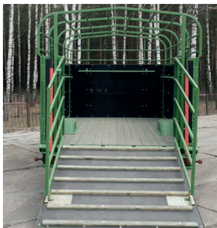
4. kép. Két-három egyed szállítására alkalmas, egyszerű kivitelű, fapadozatú kivitel (Fotó: Pronar)
