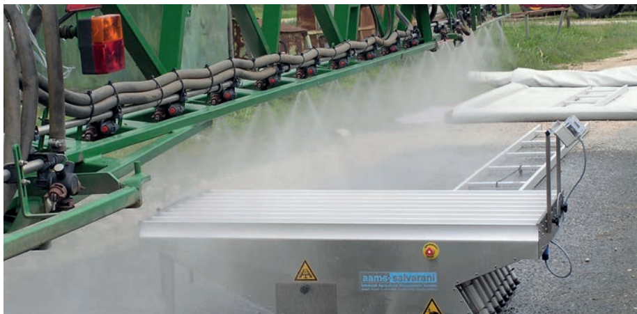
1. kép. AAMS-SALVARANI keresztirányú szórás egyenletességet mérő pad
