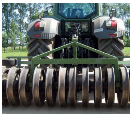
5. kép. A jó minőségű szenázs-szilázs-készítés fontos művelete a tömörítés, amire speciális tömörítőeszköz használata is javasolható
