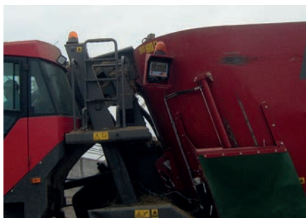
10. kép. Az elektromos mérleggel, ISO-BUS-adatátvitellel, fedélzeti komputerrel ellátott szoftveres terminál elhelyezése
