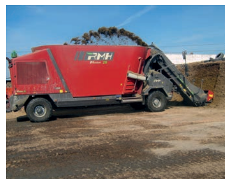
9. kép. A keverő-kiosztó kocsik silómarós változatainak munkája után egyenletes, sík felületű silófal marad vissza
