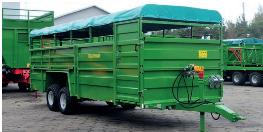
1. kép. Nyitható, rámpaként is használható oldalajtóval ellátott élőállat szállító pótkocsi (Fotó: Pronar)
