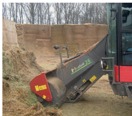
8. kép. A silómarós keverő-kiosztók a szénabálák aprítását és önrakódását is elvégzik
