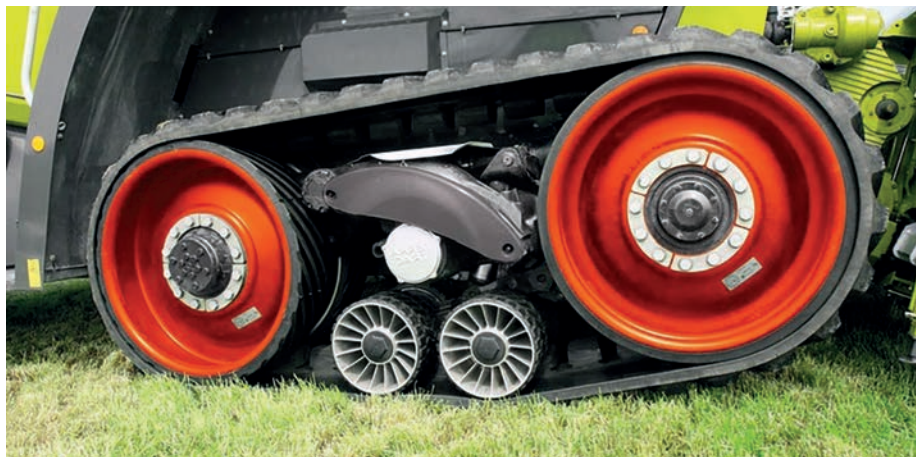
2. kép. Az új megoldású Terra Trac gumihevederes járószerkezet megemelt helyzetben (forrás: www.claas.com)
