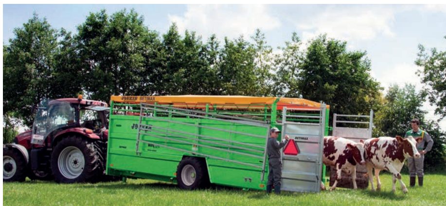
3. kép. Süllyeszthető rakfelületű élőállat szállító pótkocsi (Fotó: Joskin)
