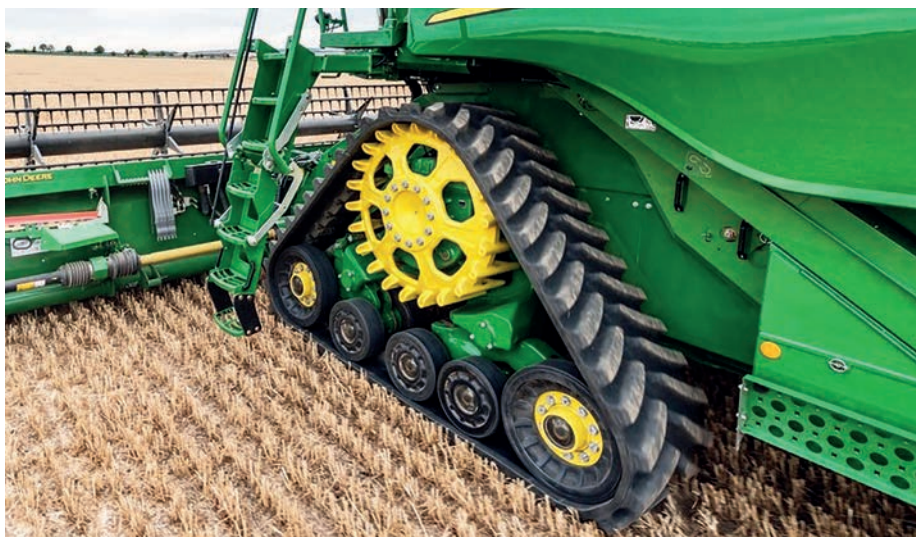
3. kép. John Deere T670i kombájn új Camso-Soucy gumihevederes járószerkezettel (forrás: www.johndeere.com )
