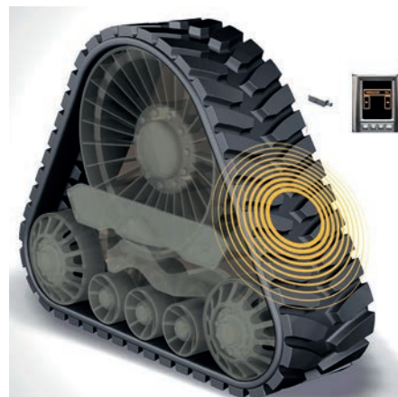
4. kép. Continental intelligens gumiheveder, elektronikus hőmérsékletérzékelő rendszerrel (forrás: www.agriland.ie )
