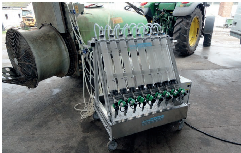
2. kép. AAMS-SALVARANI kertészeti permetező szórófej vizsgáló
