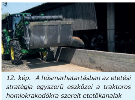
12. kép. A húsmarhatartásban az etetési stratégia egyszerű eszközei a traktoros homlokrakodóra szerelt etetőkanalak
