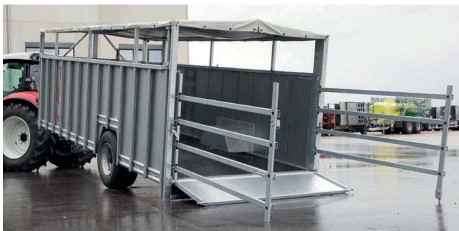
2. kép. Hátra billenthető kocsiszekrényű élőállat szállító pótkocsi (Fotó: Fliegl Abda Kft.)
