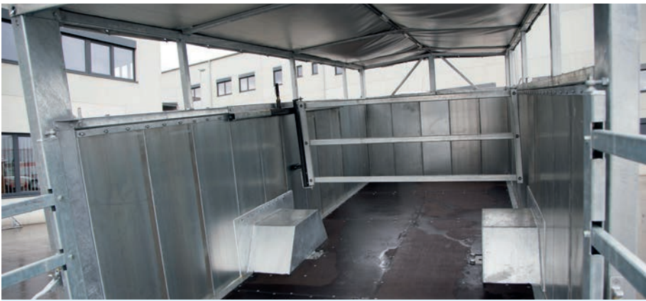
5. kép. Elválasztó kerettel és csúszásmentes bevonattal szerelt állatszállító kocsi (Fotó: Fliegl Abda Kft.)
