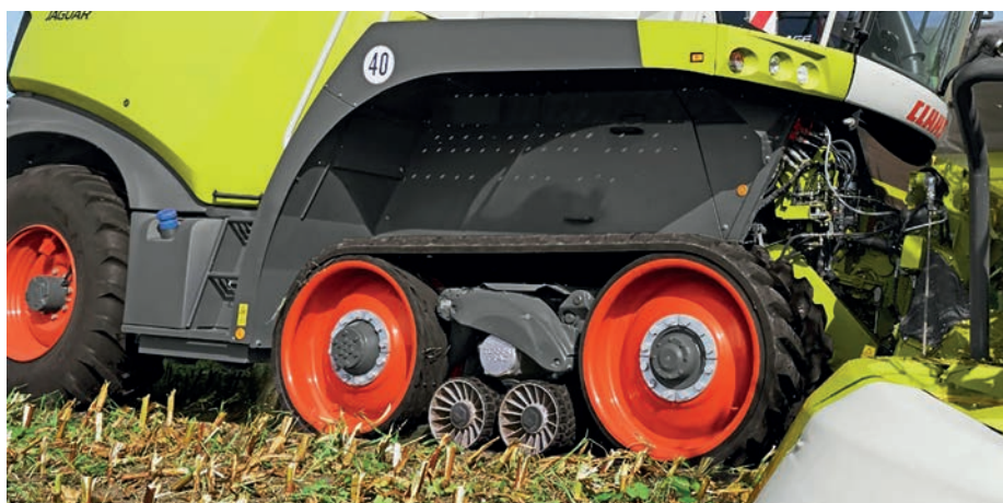
1. kép. Claas JAGUAR 960 silózó gép Terra Trac gumihevederes járószerkezettel (forrás: www.claas.com)
