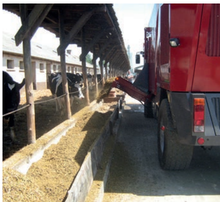
11. kép. Független tengelyű kiosztókocsi munka közben
