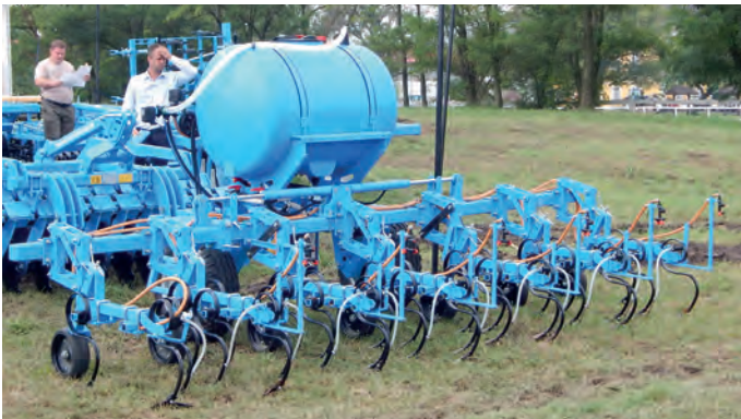
3. kép. Folyékony tápanyag injektálására alkalmas, hazai sorközművelő kultivátor
