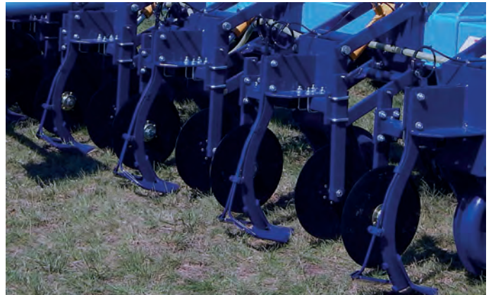
2. kép. A lúdtalp kapák végeihez vezetik az oldalt szállító vezetéket
