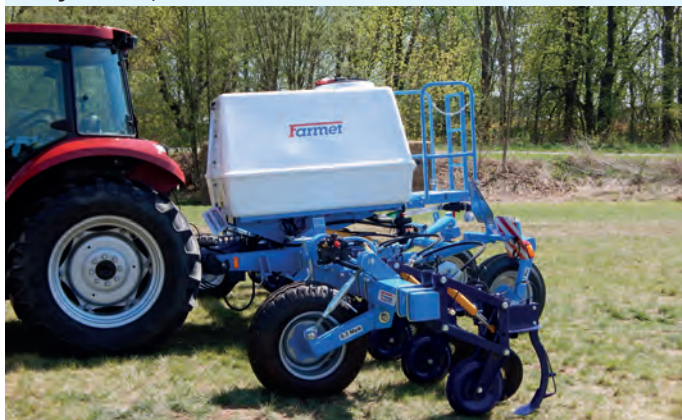
1. kép. Kifejezetten folyékony tápanyag injektálására kifejlesztett, sorközművelő kultivátor
