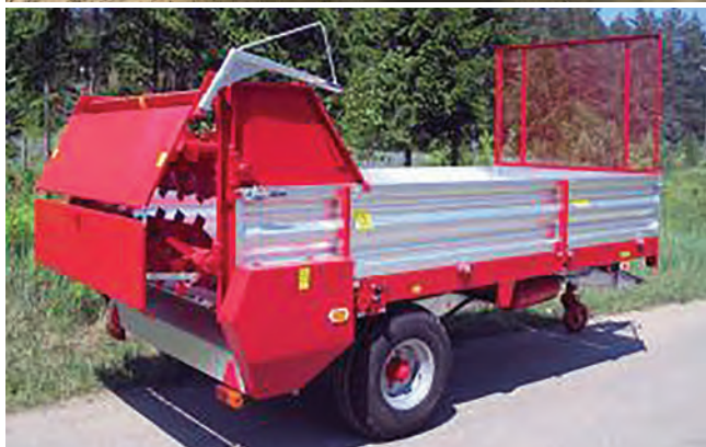
3.(a-b) ábra: A kis teherbírású trágyaszóró pótkocsikhoz is – a technológiai igényeknek megfelelően – különböző szórószervezeteket alkalmaznak
