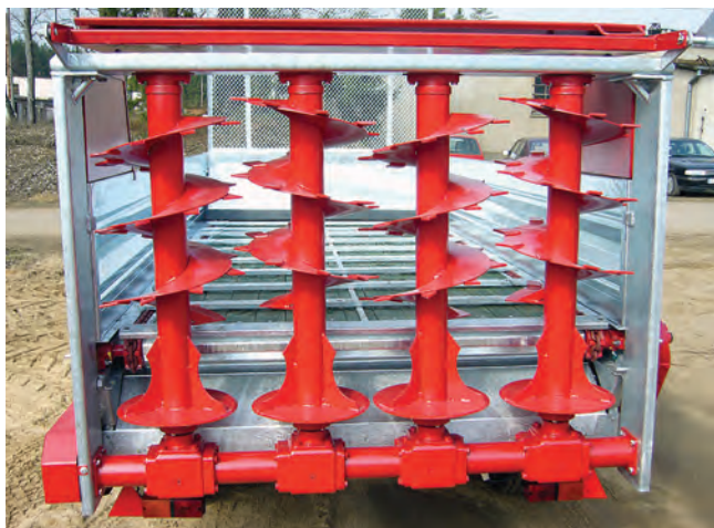
2. ábra: Az újabb fejlesztésű szervestrágya-szóró pótkocsikon gyakori megoldás a tüzhorganyzású felületvédelem
