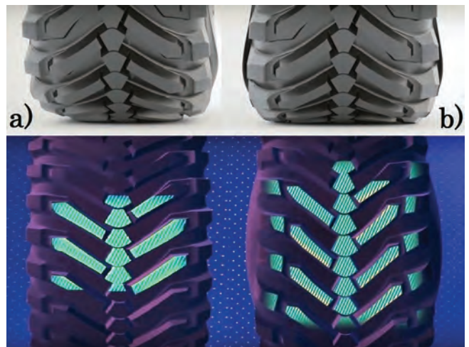
4. ábra. MICHELIN EVOBIB talajkapcsolata különböző abroncsnyomás esetén a) 1,2 bar abroncs légnyomás; b) 0,6 bar abroncs légnyomás (forrás: www.landwirtschaft.michelin.de )
