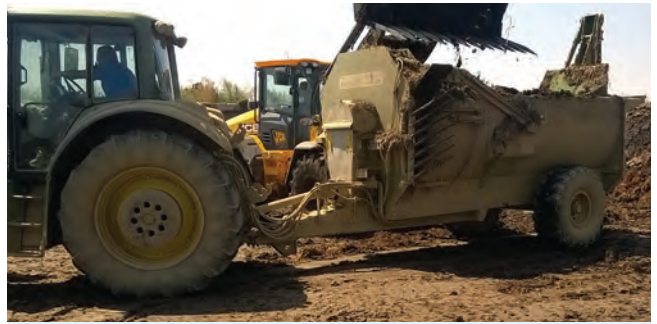
9. ábra: Nedves, tapadós szervestrágyák kiszórására kifejlesztett oldalra szóró gép
