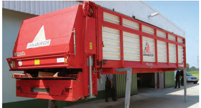
10. ábra: Cserefelépítményes szervestrágyaszóró konstrukció
