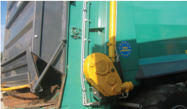
7. ábra: A lehordószerkezet hidromotoros hidrosztatikus hajtása
