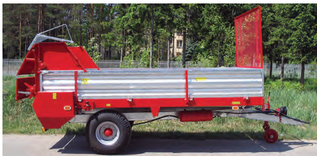
2. ábra: Az újabb fejlesztésű szervestrágya-szóró pótkocsikon gyakori megoldás a tüzhorganyzású felületvédelem
