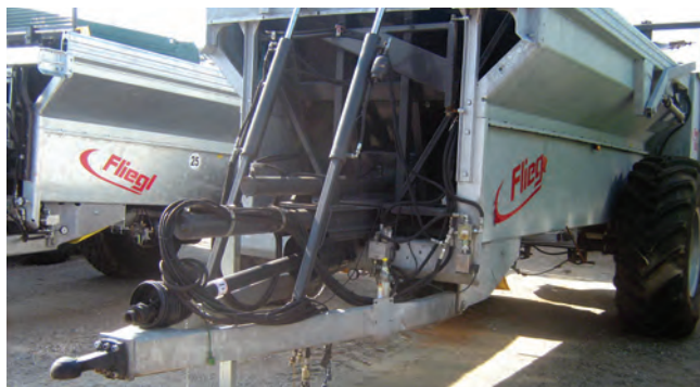
2. ábra: Az újabb fejlesztésű szervestrágya-szóró pótkocsikon gyakori megoldás a tüzhorganyzású felületvédelem
