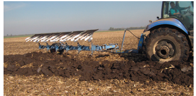
5. ábra A réselt kormánylemez nedves talajállapotokban csökkenti a vonóerő igényt
