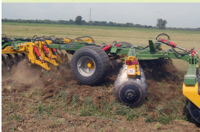
8. ábra A mulcskultivátorok a forgatás nélküli alpművelés meghatározó gépei
