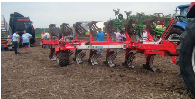
6. ábra A korszerű váltva forgató ekék fogásszélessége hidraulikusan állítható
