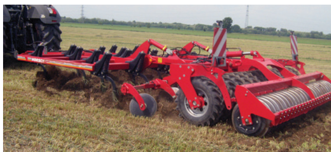
2. ábra A szántóföldi kultivátorok rugózott munkaeszköz biztosításának konstrukciós megoldása
