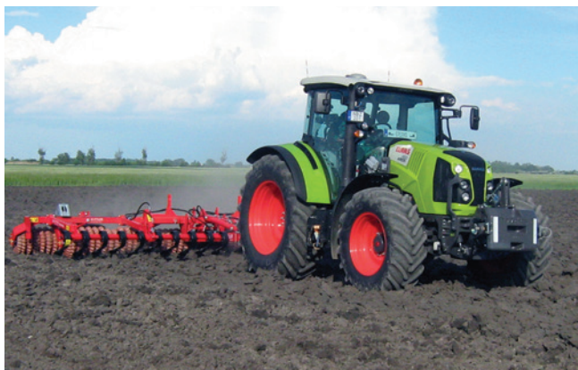
9. ábra Güttler henger kombináció szántáselmunkálásban
