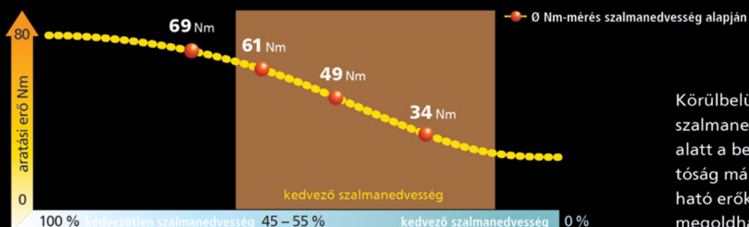
1. ábra: Ha csökken a szalma nedvességtartalma, kisebb lesz a betakarítógép nyomatéka
