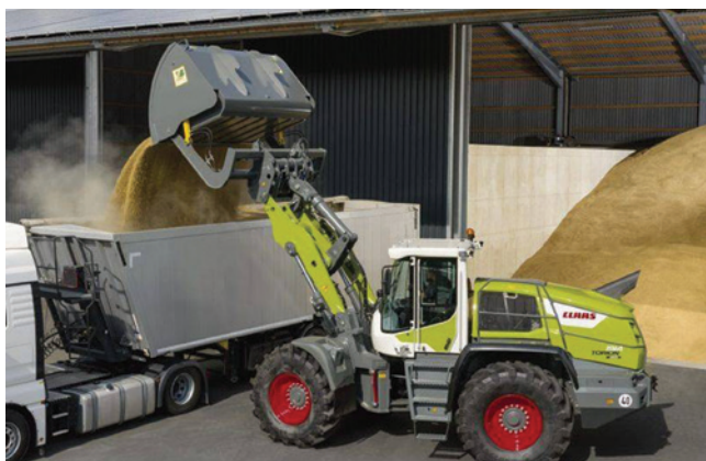
1. ábra: A TORION homlokrakodó párhuzamvezérléses emelőmechanizmusa
