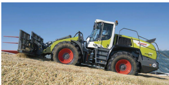
2. ábra: A TORION homlokrakodókra az alacsony építési mód a jellemző
