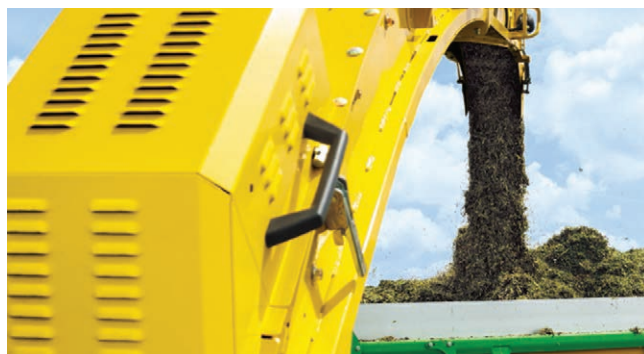
A terményáramba épített infravörös szenzorok mérik az anyag nedvességtartalmát
