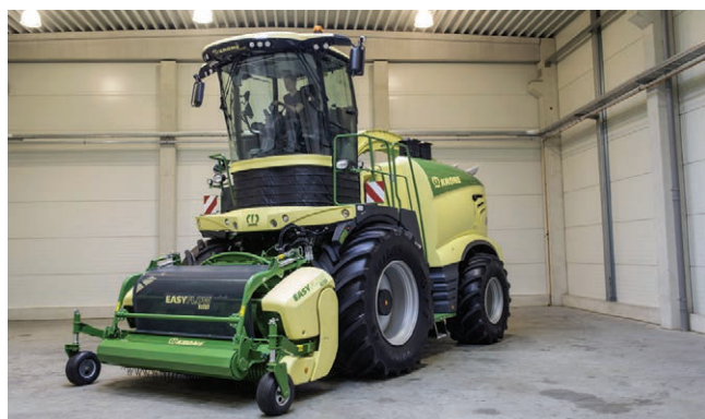
A munka közben felemelhető kezelőfülke tökéletes rálátást biztosít az adapterre
