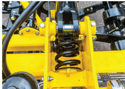
A munkaszekciók felfüggesztését a főgerendely és az oldalsó szárnyak között elhelyezett csavarrugókkal oldották meg. Ez a szabadalmaztatott műszaki megoldás garantálja a precíz munkát nagy munkasebesség mellett is.
