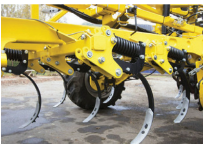
A NON-STOP rugós biztosítású kapák 15 cm mély tarlóhántásra is használhatók.
