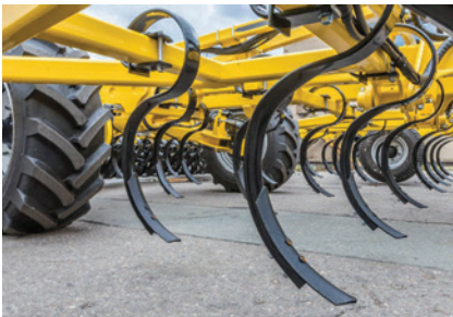
A vésős rugós kapák elsősorban tavaszi magágykészítéshez alkalmazhatók.
