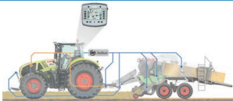
A CLAAS ICT a munkagép optimális kihasználásához igazítja a traktor sebességét
