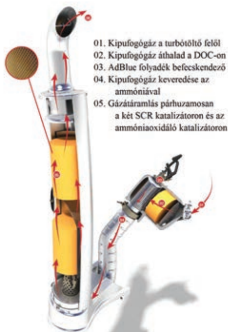
8. ábra AGCO SISU POWER kipufogógáz utókezelő rendszerének vázlatja
