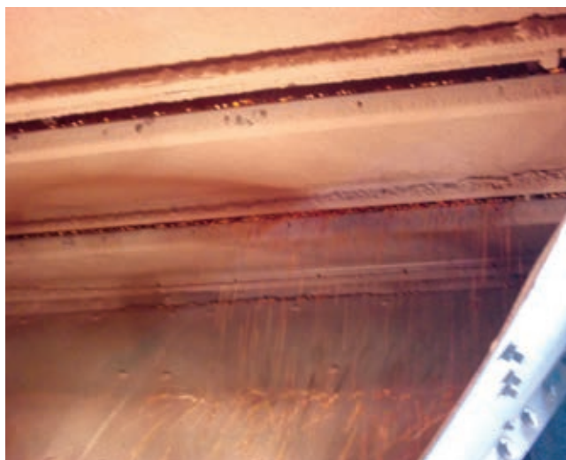
5. ábra Jól látható a folyamatos „csorgás” az ürítőszervezetenél, ami az előző ábra 2. és 3. oszlopában mutatkozó alacsonyabb maghőmérsékletet, a kiadagolt terményben pedig jelentős nedvességtartalom eltérést okozott
