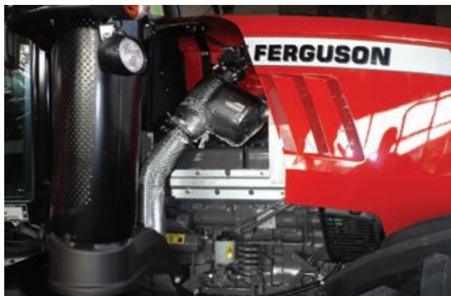
9. ábra Új kialakítású DOC elhelyezése a traktoron
