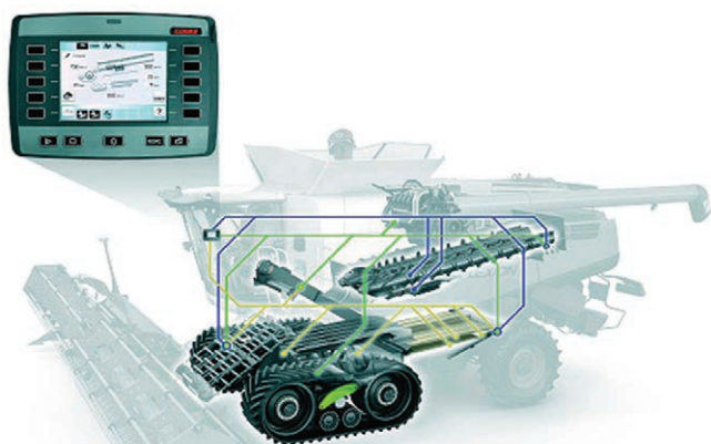
3. ábra A Claas Cemos működési vázlat
