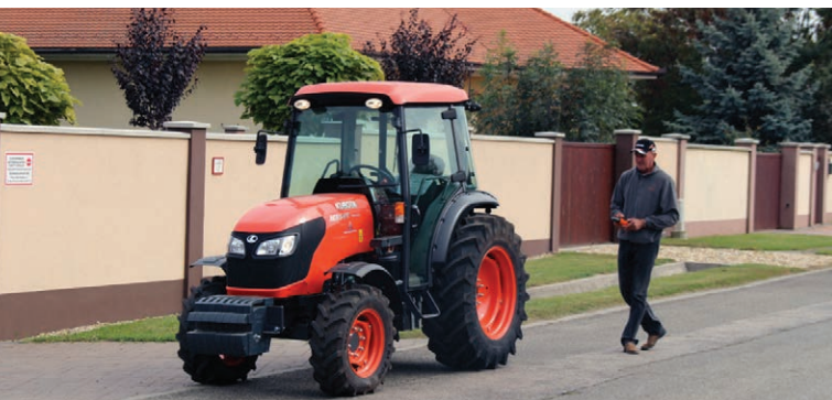
Két-Kata Kft. – Kubota M8540N Távtrak – Rádiótáv-irányítással is vezérelhető keskeny nyomtávú traktor
