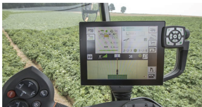
9. ábra A Fuse AgControl™ kijelzője és paraméterei
