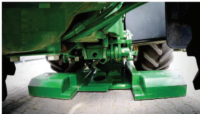
8. ábra. Az „EZ Ballast” tömb súly hidraulikus felemelése és rögzítése (Forrás: John Deere https://youtu.be/pse0ZrqGmIQ?t=0 )
