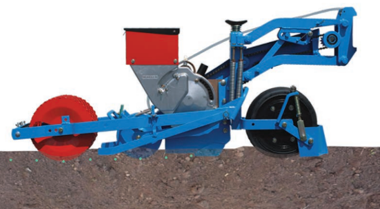
Kertészeti vetőelem általános felépítése (Monosem Mini Seed)
