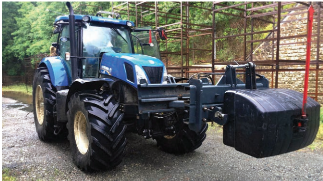
9. ábra. Pótsúly távolságának folyamatos változtatása hidraulikus mozgatással (Forrás: www.eima.it/images/concorso/novita-tecniche/ali.jpg )
