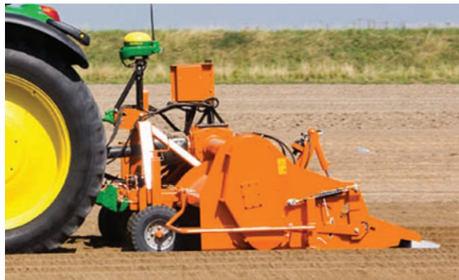
11. ábra Az iSteer alkalmazásával a munkagép pontos helyzetben tartható
