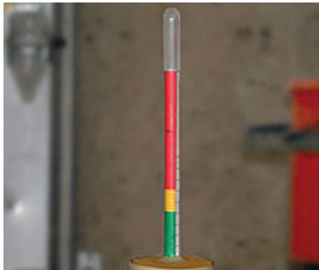
3. ábra A kolosztrum immunglobulin-tartalmának mérése hidrométerrel (colostrométerrel)
