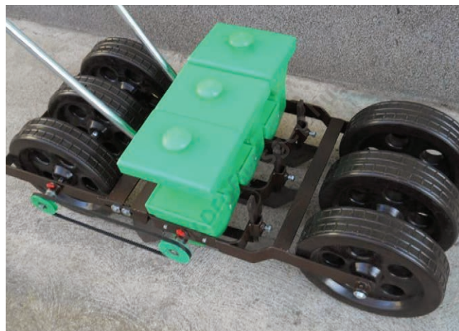
Pannongép gyártmányú három soros kézi vetőkocsi (sorkerekes kivitel)
