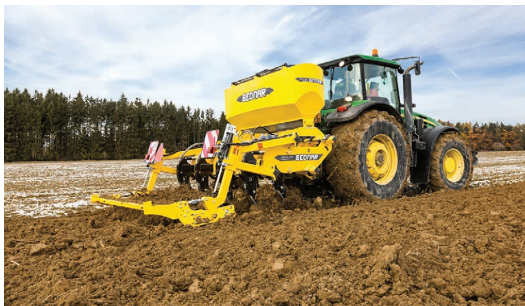
Az 1500 l térfogatú FERTI-BOX FB 1500 TN tartály a függesztett TERRALAND lazítókra szerelhető fel
