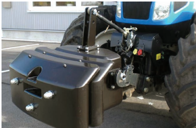
5. ábra. Az első függesztő szerkezethez kapcsolt háromtagú tömbpótsúly (Forrás: www.deraland.hu)
