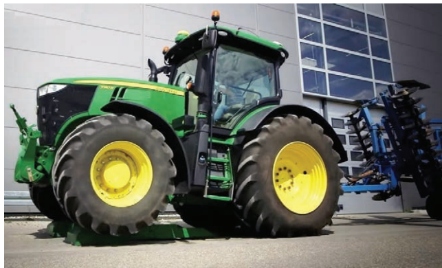
6. ábra. A vezető „EZ Ballast” tömb súlya fölé irányítja a traktort (Forrás: John Deere https://youtu.be/pse0ZrqGmIQ?t=0 )
