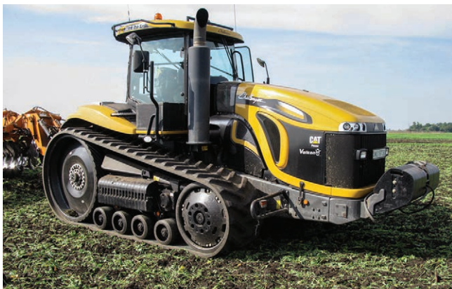
13. ábra. Pótsúlyozott Challenger MT 875 C típusjelzésű 470 kW motorteljesítményű nehéz erőgép (Forrás: www.challenger-ag.com )
