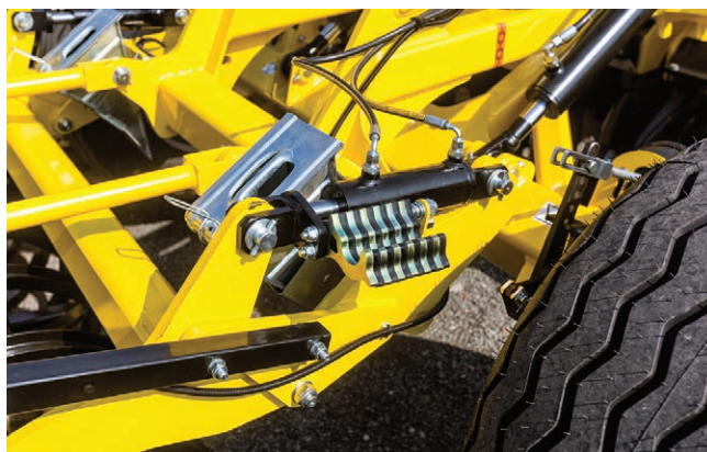
Gyors munkamélység-állítás a rögzített távtartó gyűrűknek köszönhetően
