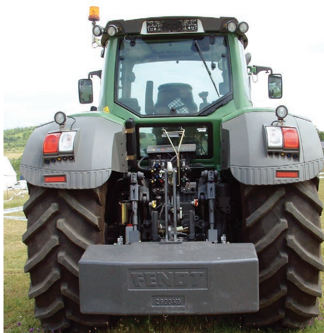
10. ábra. Fendt 936 tip. traktor hátsó hárompont-függesztő szerkezetére helyezett 2500 kg-os pótsúly
