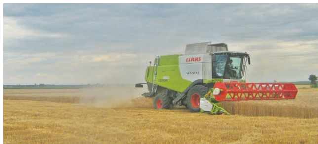
2. ábra A GPS automatakörményezés, illetve fogáskiosztás \sim 100 %-os munkaszélesség kihasználást biztosít
