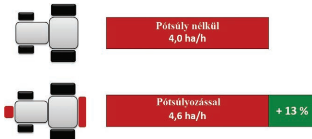
1. ábra Traktor pótsúlyozásával elérhető munkavégzésnövekedés (5,8 m széles és 15 cm mély kultivátorozás során) (Forrás: www.grasdorf-rad.eu)
