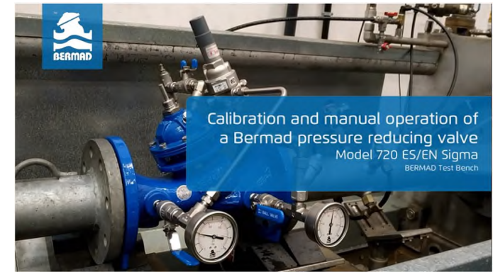
2. ábra: Nyomáscsökkentő szelep működése és beállítása Link: https://www.youtube.com/watch?v=flQavmtr3lg
