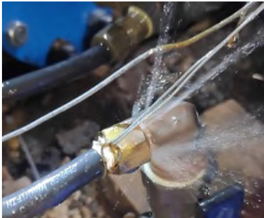
3. ábra : Nyomás- csökkentő szabályzó körének hibája
