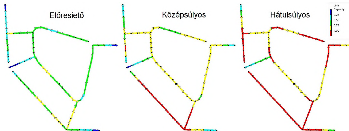
10. ábra: Az időben változó intenzitásmodellek vizsgálatának eredményei (maximális szelvényteltségek)
