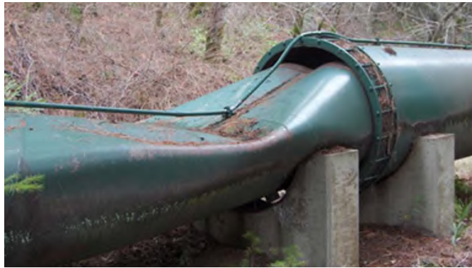
7. ábra: Vákuum miatt létrejött csősérülés Link: https://www.youtube.com/watch?v=EBzLSD8iMHO
