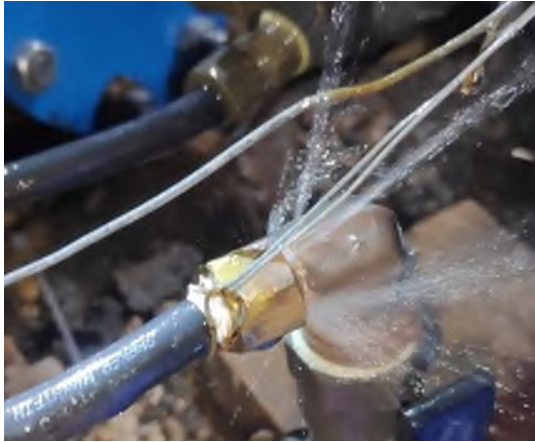
3. ábra : Nyomás- csökkentő szabályzó körének hibája
