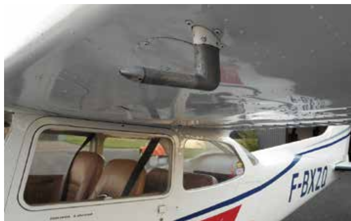
Pitot-csőves sebességmérés repülőgépen
