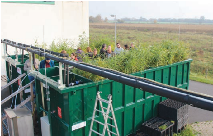
7. ábra: Náctelepes szennyvíztisztítás és ózonizálás Berlin közelében [8]
