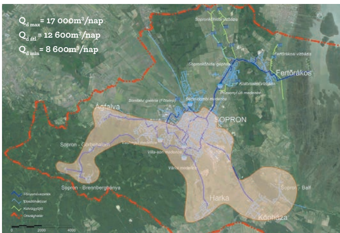
1. ábra: A Soproni Térségi Vízellátó Rendszer és azon belül a rekonstrukció alatt álló főnyomóvezeték által ellátott terület
