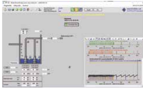
11. kép: Szivattyúkapcsolási számok és üzemidők - javítás után
