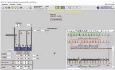
10. kép: Szivattyúkapcsolási számok és üzemidők - javítás előtt
