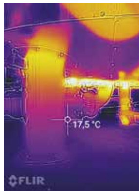
3. ábra: Aktív szén-adszorber-tartály hőfényképe, ahol megfigyelhető a szigeteteletlen tartályláb hőelvonása fotó: ALFÖLDVÍZ Zrt.
